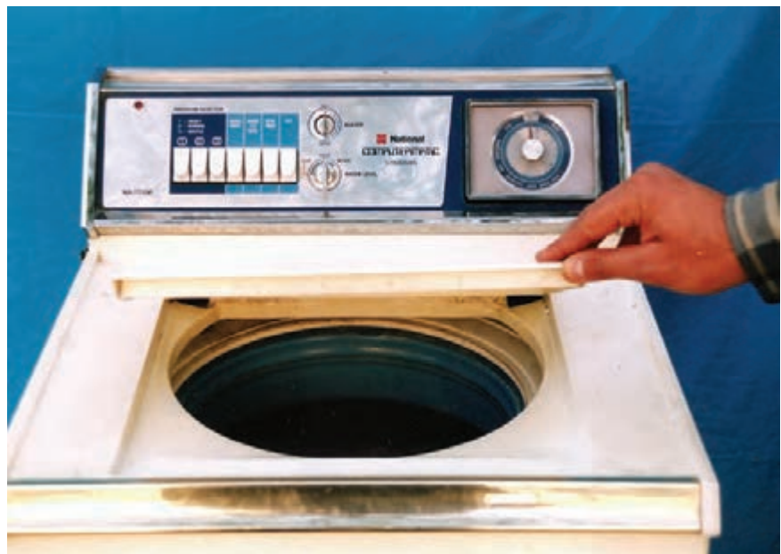
شکل ۱۳۵-۱ لباسشویی اتوماتیک در از بالا دارای تسمه و پولی و شفت و پروانه کوتاه
