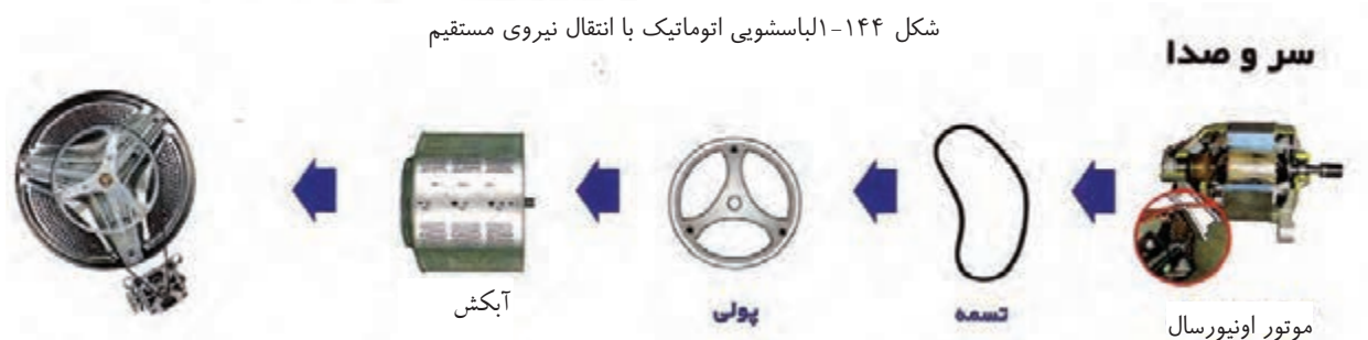
شکل ۱-۱۴۵-الباسشویی اتوماتیک با انتقال نیروی غیرمستقیم
