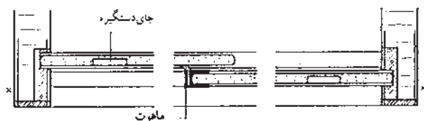
شکل ۲-۵۴- نصب درهای کشویی شیشه‌ای با دستگیره خوابیده
