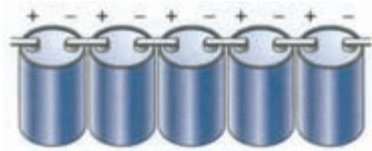
شکل ۲-۱۲۰ اتصال سری پیل‌ها
