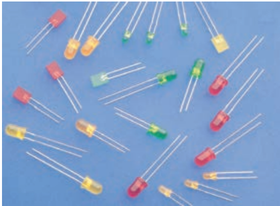
شکل ۱۷-۱۲ نمونه هایی از انواع LED
