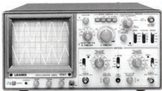
شکل ۶-۳۵ نمایش همزمان دو شکل موج توسط اسیلوسکوپ
