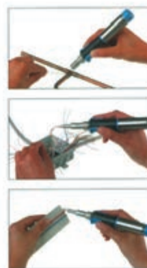
شکل ۳-۴۱ هویه‌ی گازی با نوک قابل تعویض
