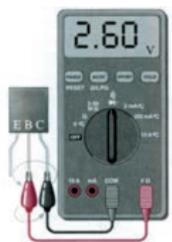
شکل ۱۲-۴۹ ترانزیستور معیوب (قطع)
