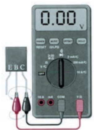
شکل ۱۲-۵۰ ترانزیستور معیوب (اتصال کوتاه)
