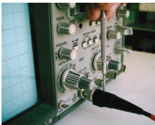
شکل ۸-۶ نحوه‌ی تنظیم پروب
