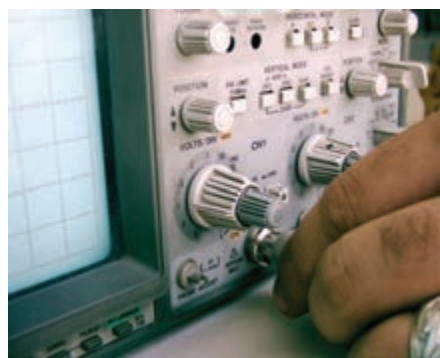
شکل ۶-۶ نحوه‌ی اتصال BNC به اسیلوسکوپ
