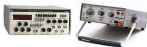
الف - سیگنال ژنراتور ب - فانکشن ژنراتور
