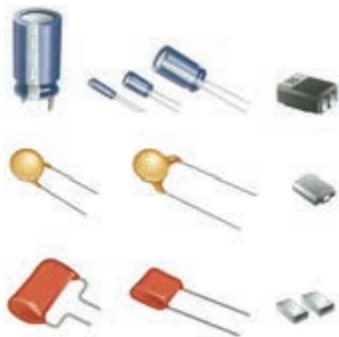
شکل ۷-۱۵ شکل ظاهری چند نمونه خازن
