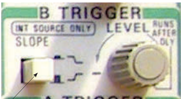
شکل ۶-۳۱ ولوم -/+ slope
