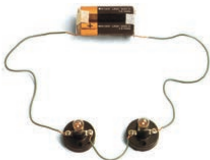
شکل ۲-۲۹ مدار واقعی دو لامپ به صورت سری
