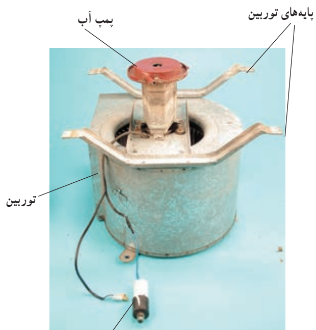
خازن دائم کار موتور شکل ۸-۵۰۷
