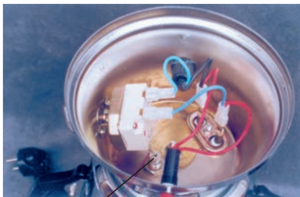
شکل ۲-۲۴ لوله موئی ترموستات گازی
