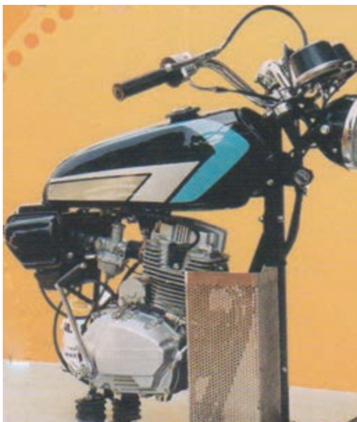
شکل ۱-۳۵ مدار سوخت‌رسانی موتور سیکلت
