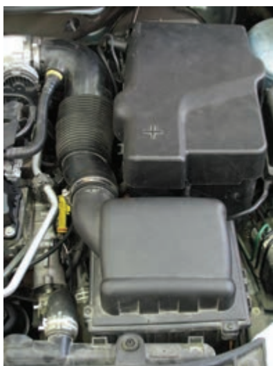
شکل ۵۱-۱ هواکش موتور انژکتوری
