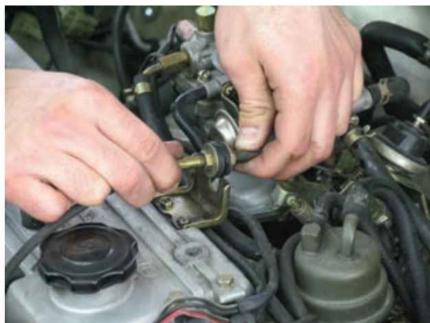
شکل ۱۱۵-۱ پیاده کردن کاربراتور
