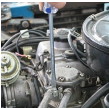
شکل ۱-۴۴ ب: نصب لوله‌ها
