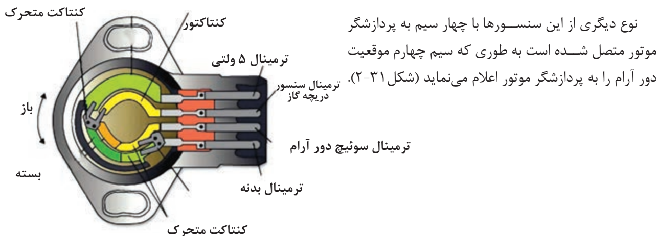
شکل ۲-۳۱- سنسور موقعیت دریچه گاز
