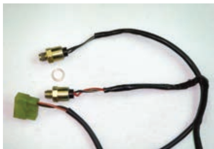
شکل ۱-۹۱ اجزای الکتریکی در یک نوع کاربراتور
