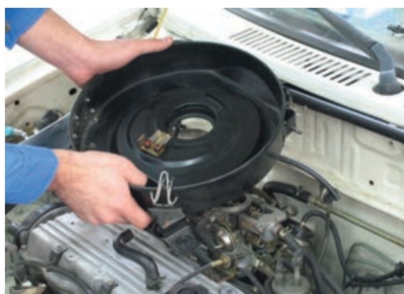
شکل ۱۰۰-۱ پیاده کردن مجموعه هواکش
