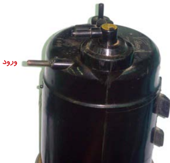
شکل ۱-۹۶ شیر ورودی سوخت‌های تبخیر شده به کنیستر
