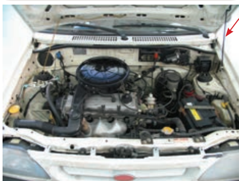
شکل ۱۱۹- ۱ نصب صحیح اهرم نگه‌دارنده درپوش موتور خودرو
