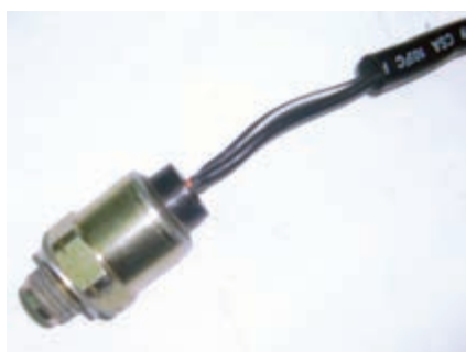
شکل ۱-۹۲ سلونوئید مدار دور آرام
