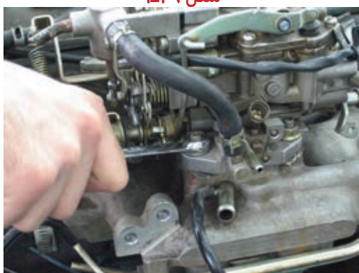
شکل ۱-۱۱۰ باز کردن پیچهای اتصال کاربراتور به موتور
