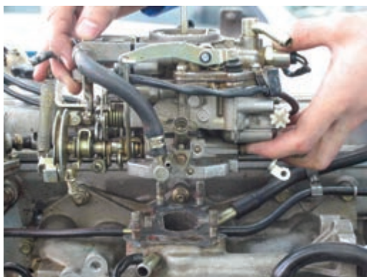
شکل ۱-۱۱۱ پیاده کردن کاربراتور
