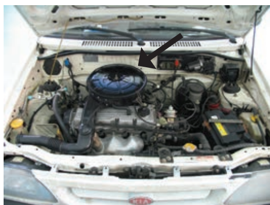
شکل ۵۰-۱ هواکش موتور کاربراتوری
