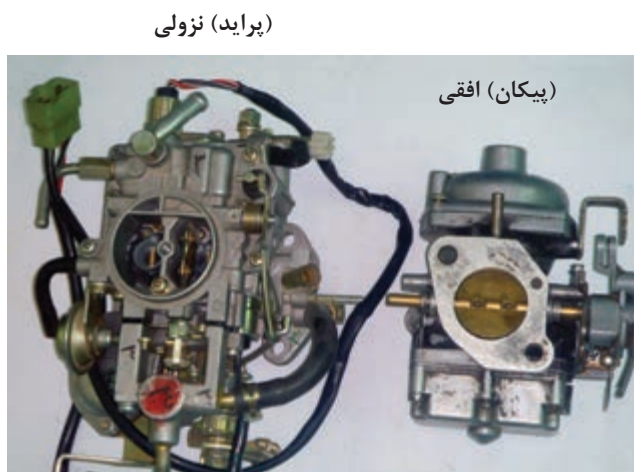
شکل ۱-۶۴ کاربراتورها از نظر حرکت سوخت (نزولی - افقی)
