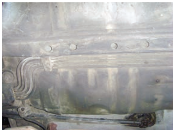
شکل ۱-۳۳ لوله سوخت از مخزن تا پمپ
