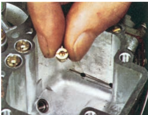
شکل ۱۱۸- ۱ باز کردن ژیکلور اصلی
