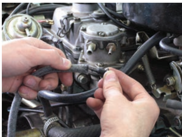
شکل ۱-۴۱ جدا کردن لوله‌ها
