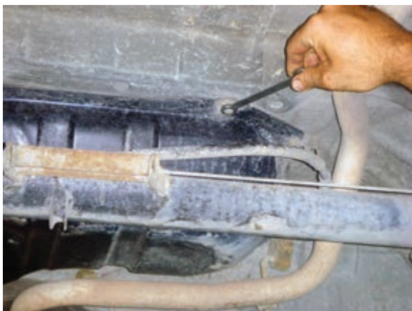
شکل ۱-۲۵ باز کردن پیچهای دور باک
