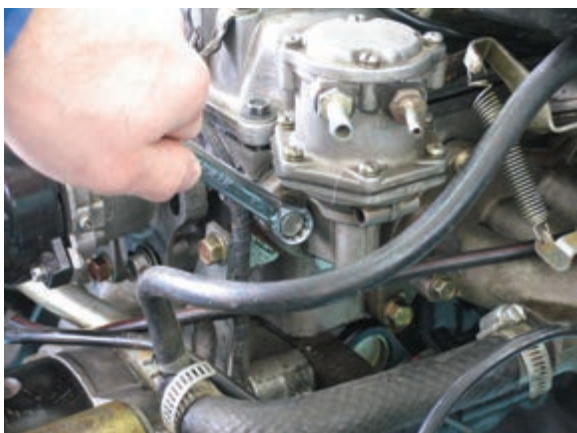
شکل ۱-۴۲ پیاده کردن پمپ
