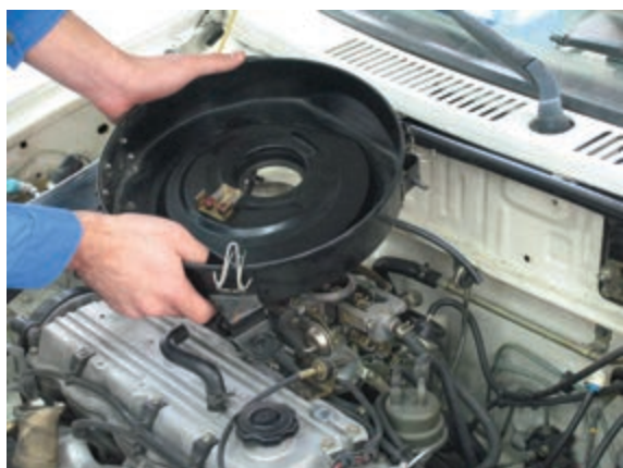
شکل ۱۱۴- ۱ پیاده کردن مجموعه هواکش
