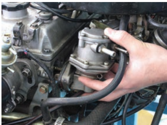
شکل ۱-۴۴ الف: نصب پمپ
