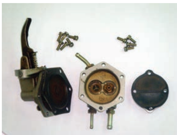
شکل ۱-۴۳ اجزای پمپ سوخت
