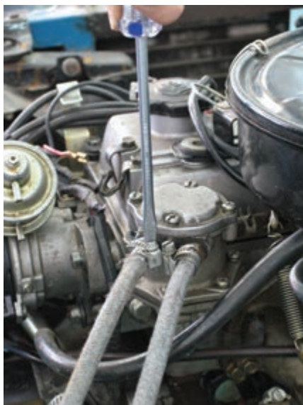
شکل ۱-۳۲ اتصال لوله سوخت به پمپ
