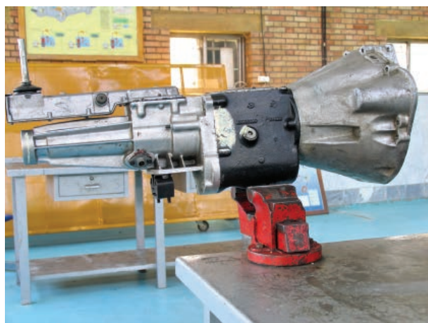
شکل ۱۶۳- جعبه دنده خودروی محرک عقب
