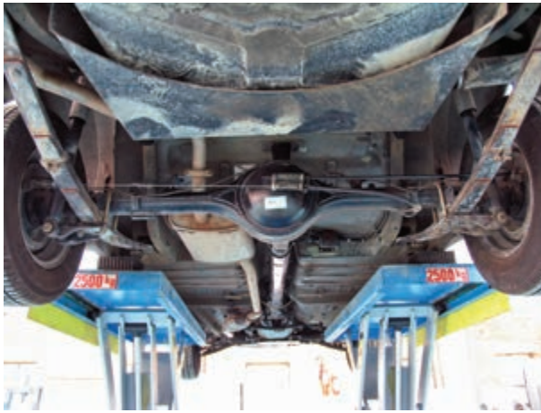
شکل ۳۱۵- دیفرانسیل در خودرو محرک عقب
