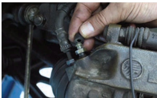
شکل ۱-۷۰ – پاک کردن اطراف پیچ هواگیری
