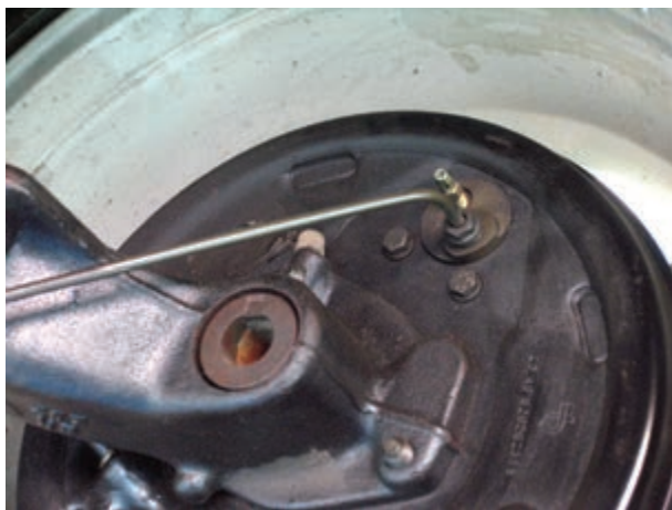
شکل ۱-۱۰۳- پاک کردن اطراف اتصالات
