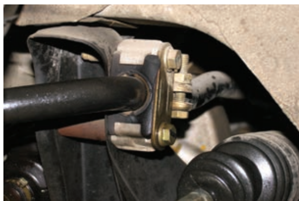
شکل ۳-۱۳۲ نصب بست های میل موج گیر بلند
