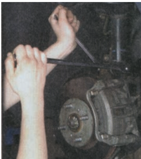
شکل ۳-۱۰۰ نصب مجموعه سیستم تعلیق روی خودرو
