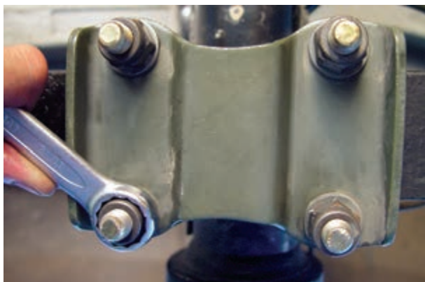
شکل ۳-۶۶- باز کردن مهره‌های کربی‌ها (پیچ‌های U شکل)
