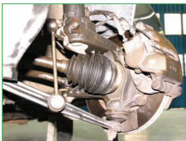
شکل ۳-۱۲۸ باز کردن پیچ‌های میل موج‌گیر
