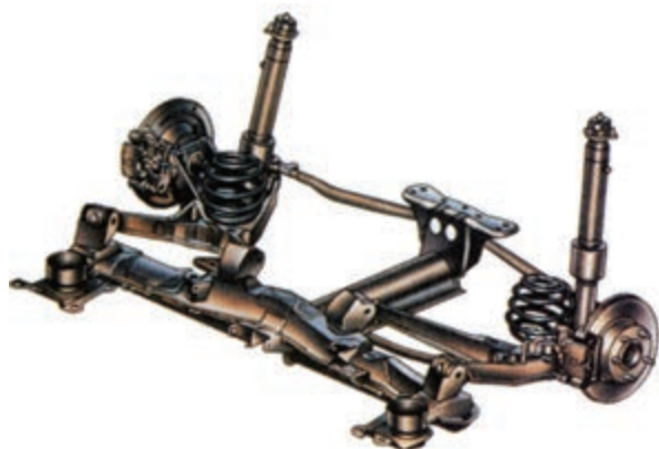
شکل ۳-۴۸ - سیستم تعلیق مستقل عقب با چرخ‌های متحرک
