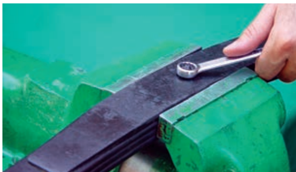
شکل ۳-۶۸- باز کردن پیچ مرکز فنرهای شمش
