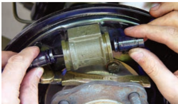
شکل ۹۴-۱- خارج کردن پیستون‌ها
