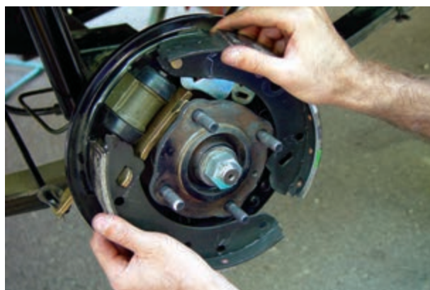
شکل ۱-۱۰۴- خارج کردن کفشک‌ها
