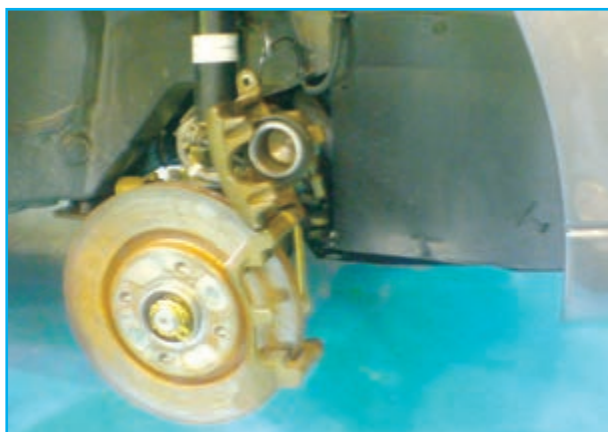
شکل ۱۱۰-۱- باز کردن پوسته نگه‌دارنده لنت‌ها
