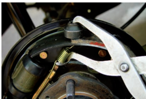
شکل ۱-۱۰۷- جازدن فنر بالایی کفشک
