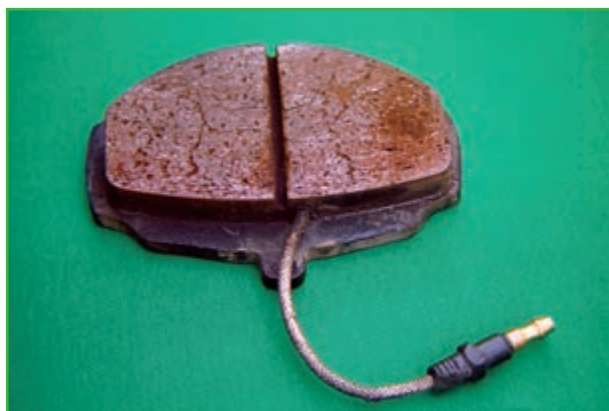
شکل ۱۱۲-۱- لنت ترمز دارای سیم هشدار
