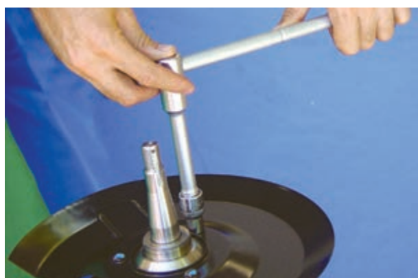
شکل ۳-۹۶- باز کردن صفحه پشت توپی چرخ
