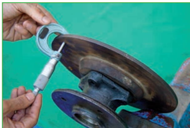
شکل ۱۲۴-۱ اندازه‌گیری ضخامت دیسک
