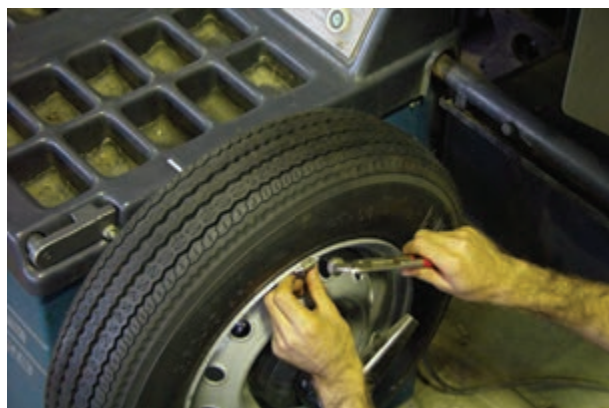
شکل ۲۳۸-۳ نصب وزنه روی قسمت بیرونی رینگ
