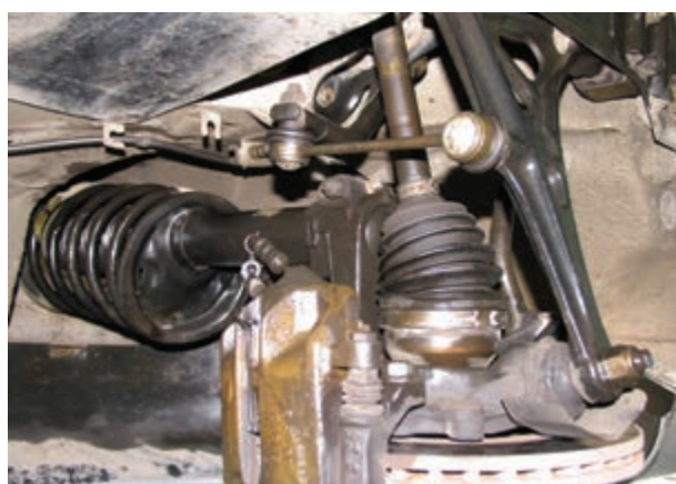
شکل ۳-۱۳۱ نصب میل موج گیر کوتاه
