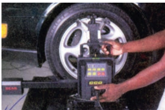
شکل ۳-۲۲۰ - نصب مجموعه حسگر دستگاه اندازه‌گیر رایانه‌ای
