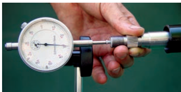
شکل ۶۸-۲ اندازه‌گیری لقی طولی میل فرمان
