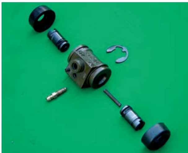
شکل ۹۵-۱- اجزای پمپ ترمز چرخ
