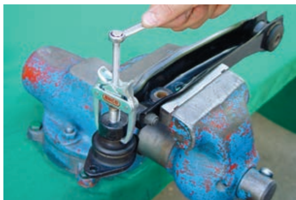
شکل ۳-۸۵ جدا کردن سیبک از بازوی اتصال
