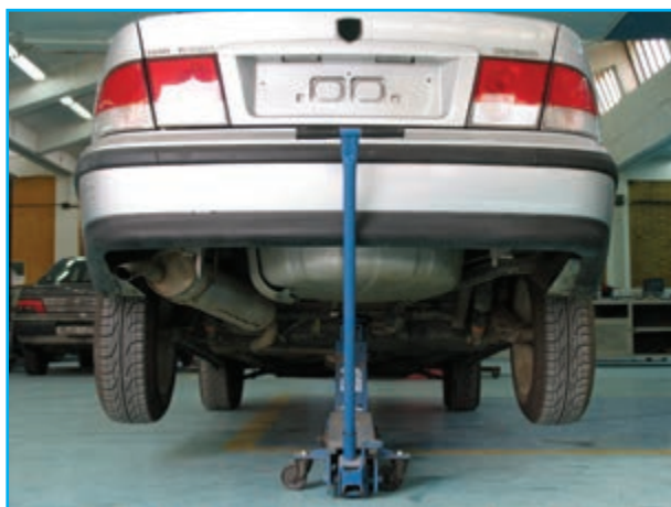
شکل ۳-۱۵۶ تنظیم ارتفاع و کنترل رام لوله‌ای
