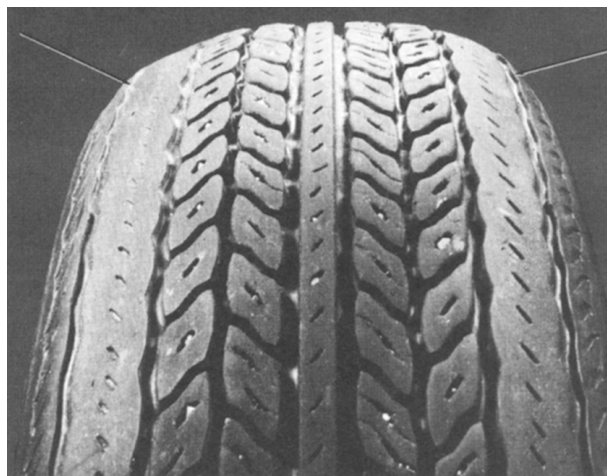
شکل ۲۱۴-۳- سایش در اثر رانندگی غلط (پیچیدن تند)
