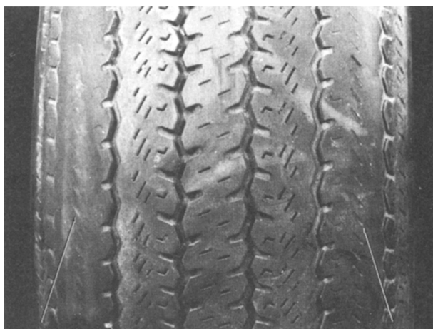
شکل ۲۱۶-۳ سایش در اثر تنظیم نبودن باد (باد کم)
