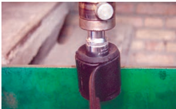
شکل ۳-۶۹- بوش لاستیکی فلزی محل اتصال شاه فنر
