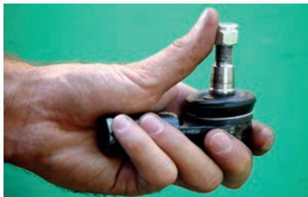
شکل ۸۴-۲ کنترل لقی سیبک‌ها
