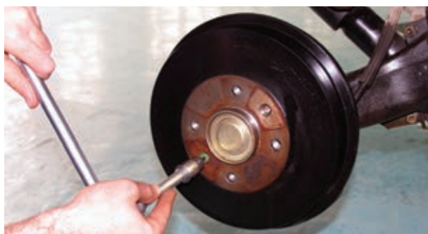
شکل ۱-۸۹ – باز کردن پیچ کاسه چرخ
