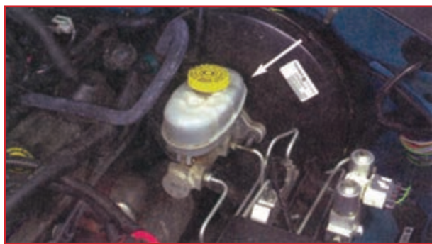
شکل ۱-۷۸- مخزن مایع ترمز و پمپ اصلی
