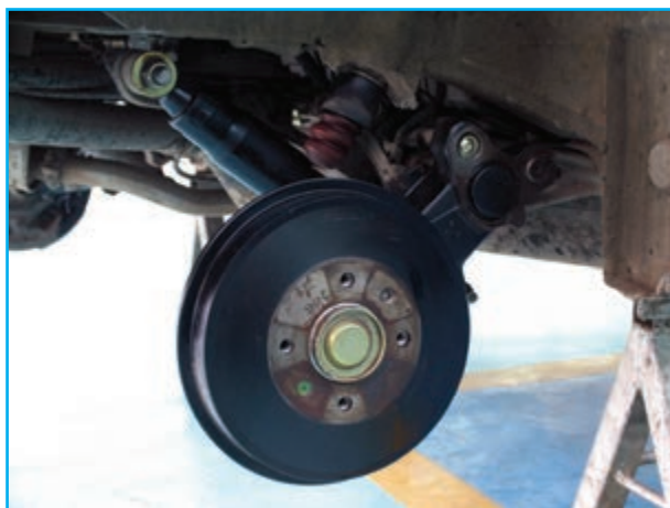
شکل ۱۸۳-۳- نصب ژامبون و متعلقات چرخ عقب
