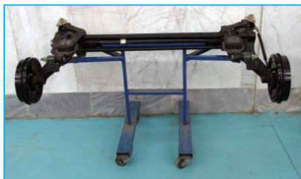
شکل ۱۵۹-۳- مجموعه تعلیق عقب
