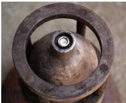
شکل ۳-۲۳۰- دستگاه بالانس حباب‌دار
