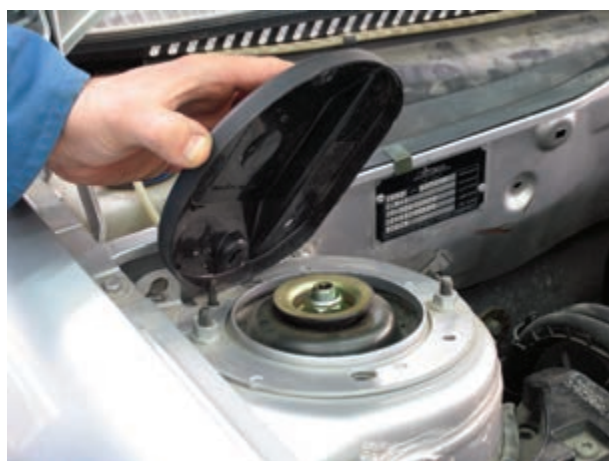
شکل ۳-۱-۳- برداشتن پوشش بالای تکیه‌گاه کمک فنر
