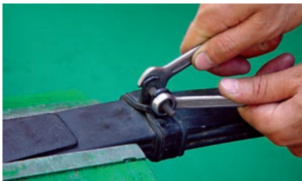
شکل ۳-۶۷- باز کردن بست‌های مجموعه فنر شمش
