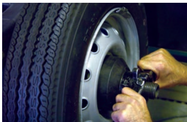
شکل ۲۳۴-۳- نصب چرخ روی دستگاه
