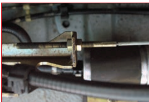
شکل ۴۸-۱- باز کردن مهره تنظیم کننده
