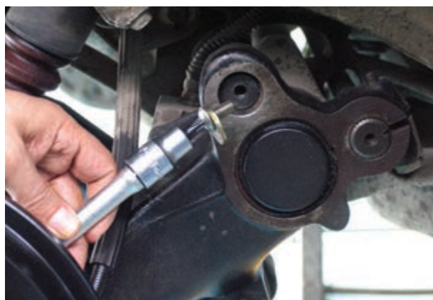
شکل ۱۷۶-۳- نصب واشر فشار و پیچ‌های انتهای میله‌ها
