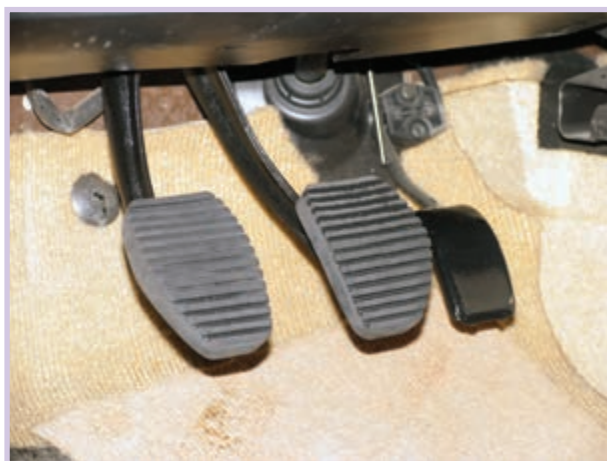
شکل ۱-۱۵- مجموعه پدال‌های ترمز و کلاچ
