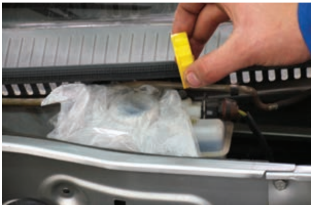
شکل ۱۳۸-۱- مسدود کردن در مخزن مایع ترمز
