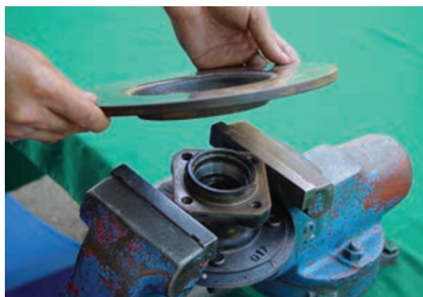
شکل ۳-۹۸- جدا کردن دیسک ترمز از تویی چرخ
