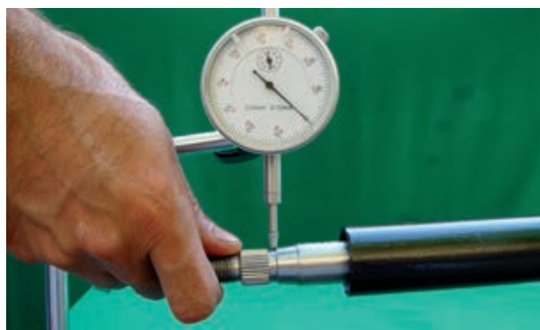
شکل ۶۹-۲ اندازه‌گیری لقی جانبی میل فرمان
