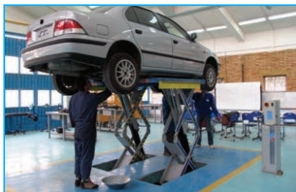
شکل ۲-۴۶- استقرار خودروی روی بالابر
