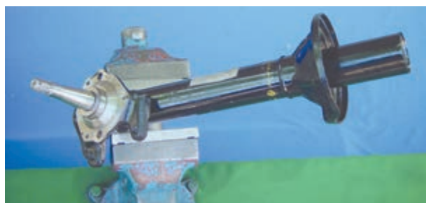
شکل ۳-۹۷- پوسته کمک فنر و محور چرخ
