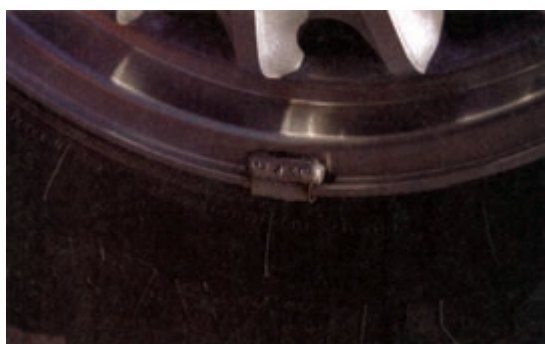
شکل ۳-۲۳۱- نصب وزنه روی رینگ
