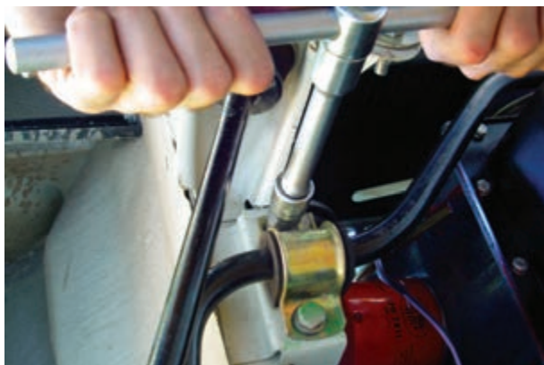
شکل ۳-۸۶ - باز کردن میله ضد غلتش (موج گیر)
