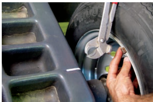
شکل ۲۳۹-۳ نصب وزنه روی قسمت داخلی رینگ
