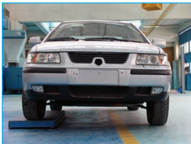
شکل ۱۹-۳ مزایای سیستم تعلیق مستقل
