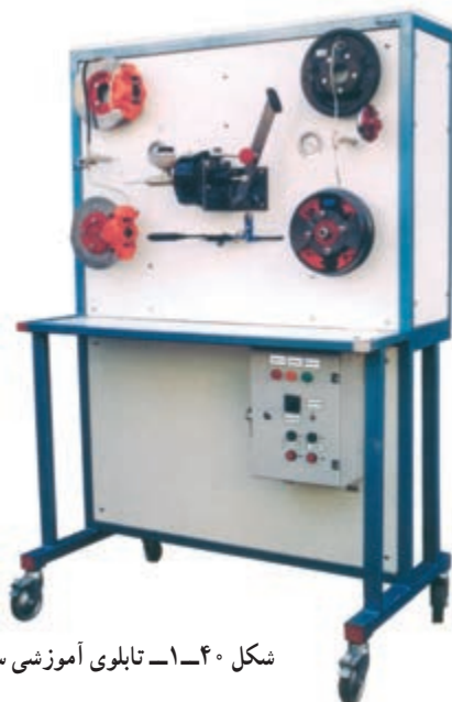
شکل ۱-۳۹- مجموعه ترمز دیسکی
