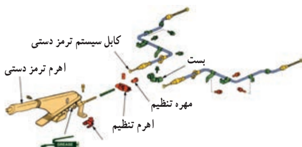
شکل ۱-۴۶- اجزای سیستم ترمز دستی
