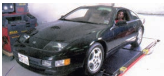
شکل ۳-۲۱۹ - دستگاه اندازه‌گیری زوایای رایانه‌ای (کامپیوتری)
