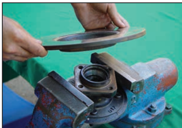
شکل ۱۲۶-۱ بازکردن دیسک ترمز
