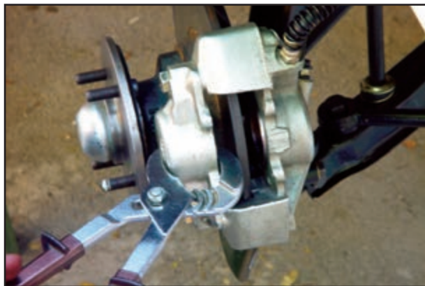
شکل ۱۱۴-۱- عقب راندن پیستون ترمز دیسکی
