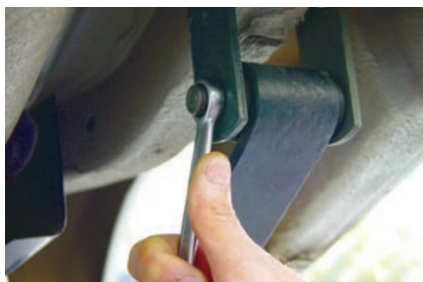
شکل ۳-۶۵ – باز کردن مهره‌های گوشواره فنر شمش
