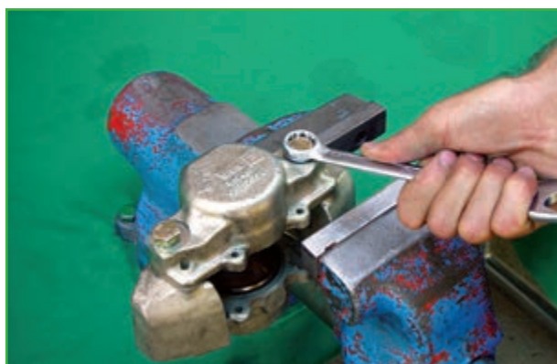
شکل ۱-۱۲۰- باز کردن پیچ های کالیپر
