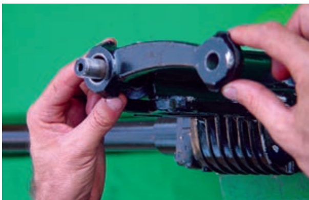
شکل ۵۹-۲- پیاده کردن اهرم هزار خار
