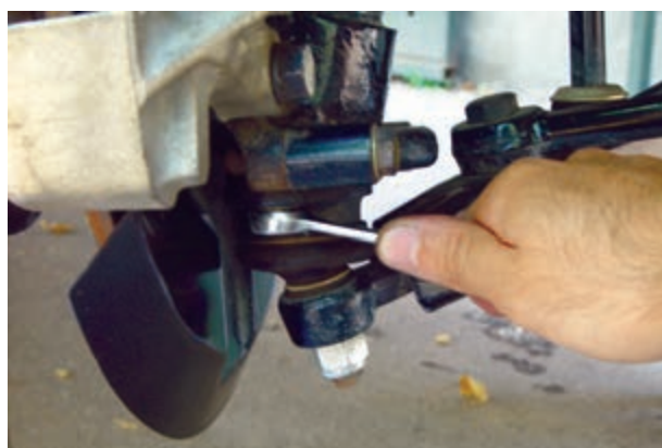
شکل ۳-۷۸- باز کردن سبک زیر کمک فتر
