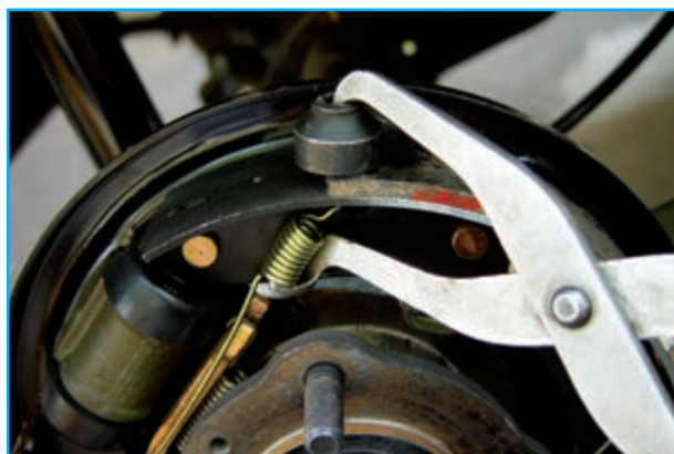
شکل ۱-۹۱- خارج کردن فنر بالایی
