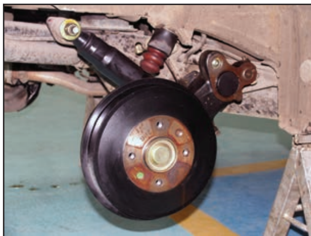
شکل ۳-۵۱- ژامبون و کمک فنر
