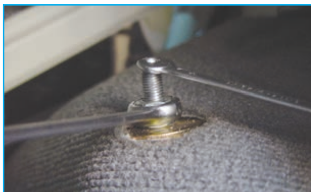
شکل ۳-۶۳- باز کردن مهره اتصال بالای کمک فنر
