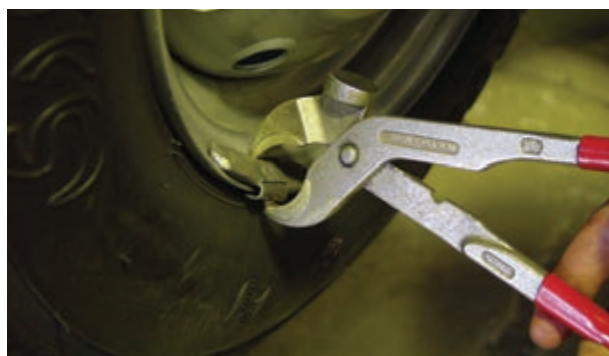
شکل ۲۳۳-۳- تمیز کردن و پیاده کردن سرب‌های قبلی
