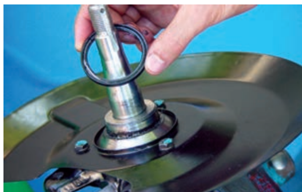
شکل ۳-۹۵- خارج کردن کاسه نمد پشت توپی چرخ
