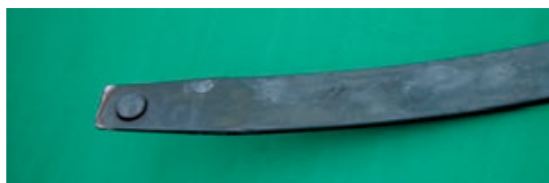
شکل ۳-۷۰- لاستیک‌های محافظ انتهایی لایه‌های فنر شمش
