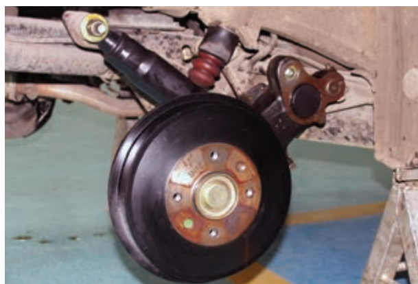
شکل ۱۷۷-۳- نصب کمک فنر
