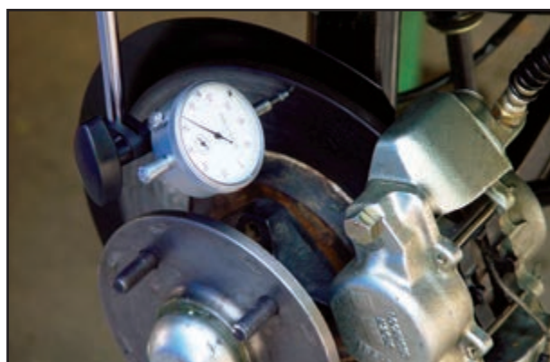
شکل ۱-۱۲۳- بررسی وضعیت دیسک
