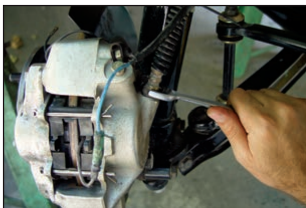
شکل ۱-۱۱۹- باز کردن شیلنگ ترمز
