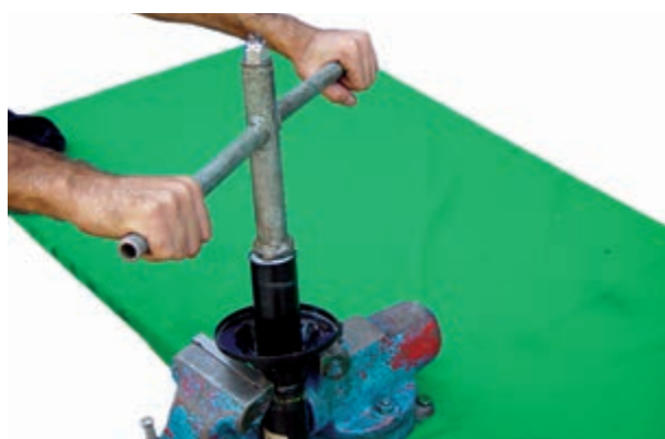
شکل ۳-۹۱- باز کردن مهره نگه‌دارنده کمک فنر
