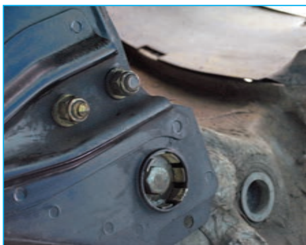
شکل ۳-۱۲۲- باز کردن پیچ های طبق
