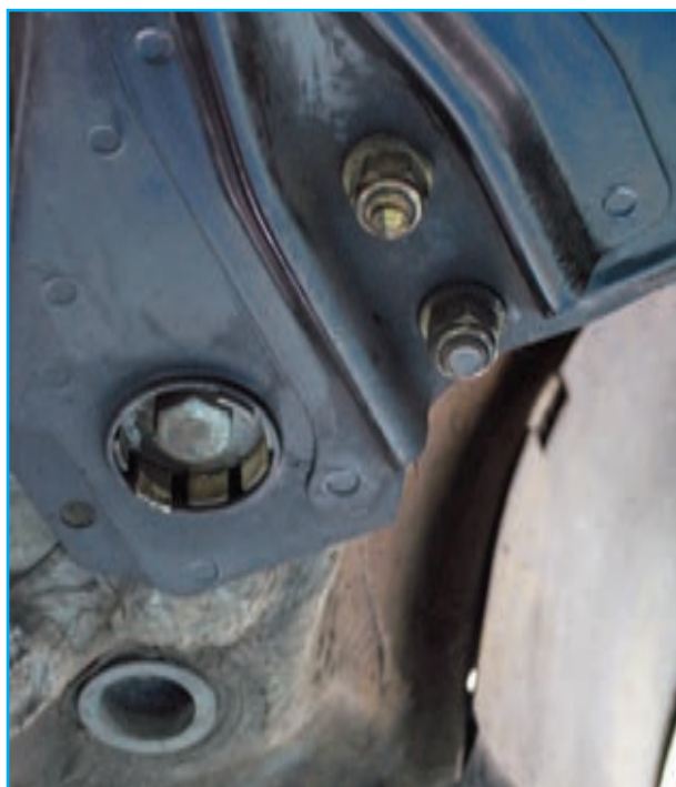
شکل ۳-۱۳۰ پیاده کردن میل موج گیر بلند
