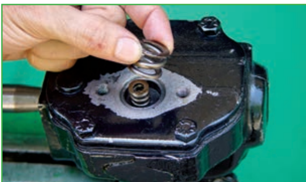
شکل ۲-۶۱ خارج کردن فنرها
