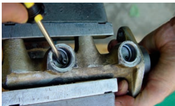
شکل ۱-۱۳۱ بستن سیلندر اصلی به گیره
