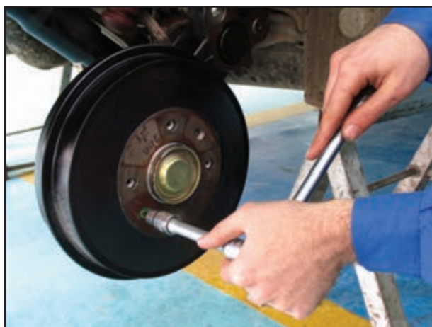
شکل ۱-۱۰۲ – بستن پیچ نگه‌دارنده کاسه چرخ
