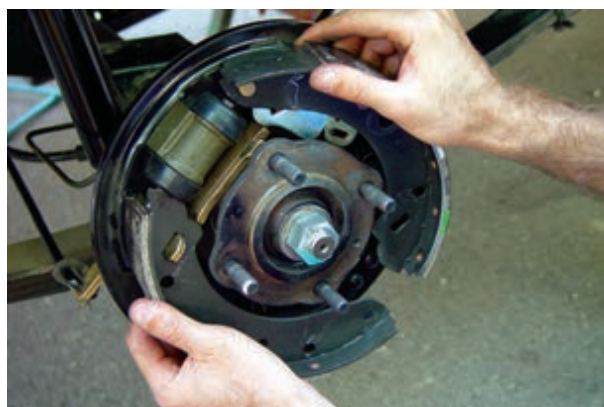
شکل ۱-۱۰۶- نصب کفشک‌ها
