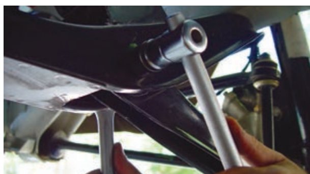
شکل ۳-۸۳ باز کردن طبق از رام
