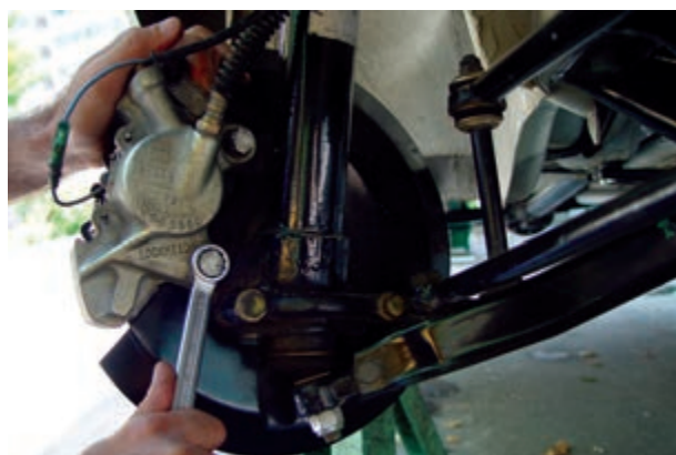
شکل ۳-۷۷- باز کردن کالیپر ترمز
