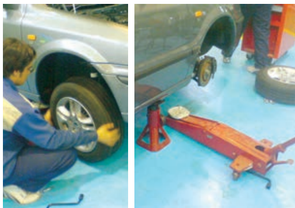
شکل ۱-۱۱۷- بالا بردن و پیاده کردن چرخ جلو
