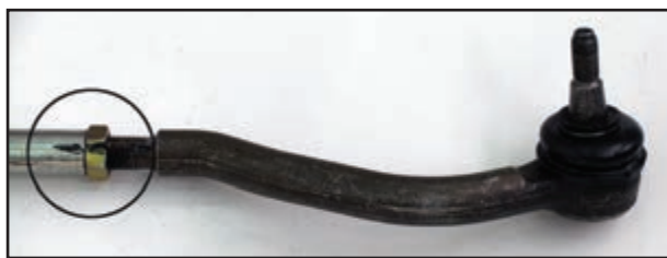
شکل ۲-۷۴- علامت گذاری سبیک و میل رابط
