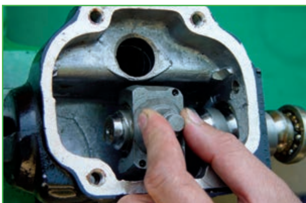
شکل ۲-۶۳ خارج کردن محفظه ساچمه‌ها
