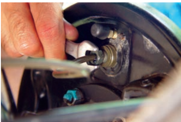
شکل ۱-۱۰۵- باز کردن مهره اتصال لوله ترمز
