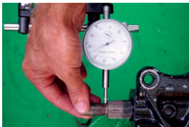
شکل ۷۱-۲ اندازه‌گیری لقی جانبی محور هزار خار
