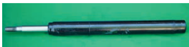
شکل ۳-۹۲- کمک فنر قابل تعویض
