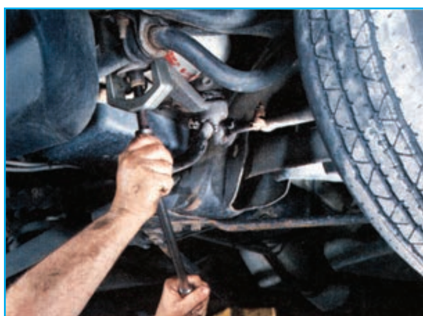
شکل ۲-۴۷- نحوه استفاده از نوعی سیبک کش
