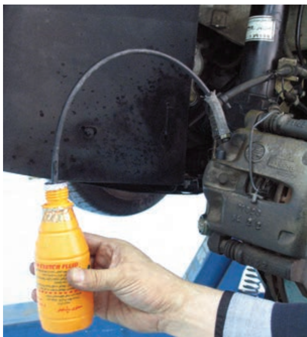
شکل ۱-۷۱ – نصب لوله پلاستیکی روی پیچ هواگیری
