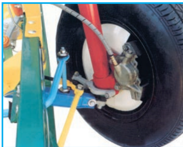
شکل ۱-۳۲- لوله مایع ترمز انعطاف پذیر
