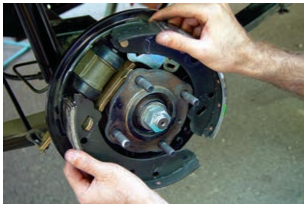
شکل ۱-۹۳- خارج کردن کفشک‌ها
