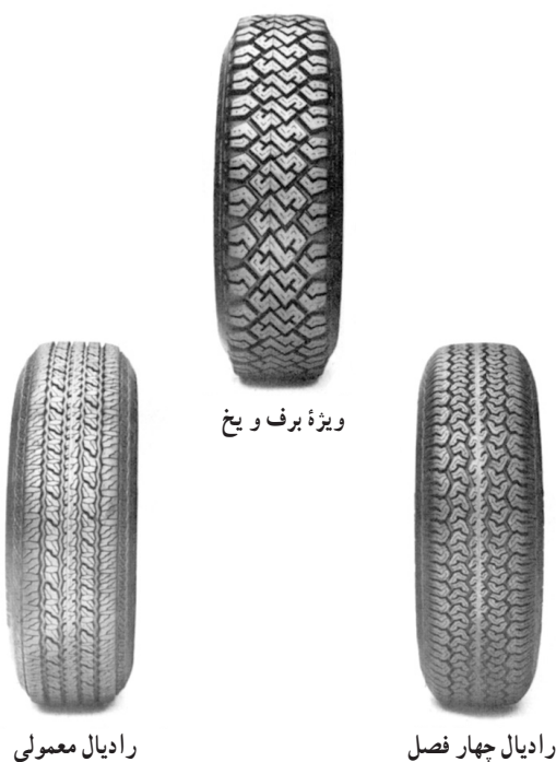
شکل ۲۱۲-۳- چند نوع آج لاستیک
