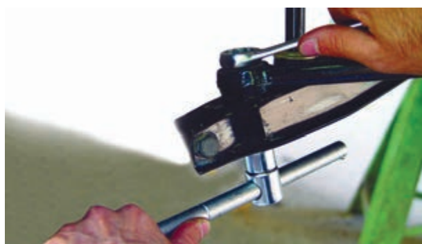
شکل ۳-۸۱ باز کردن میل تعادل از طبق
