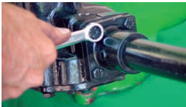
شکل ۲-۶۰ باز کردن پیچ‌های لوله فرمان
