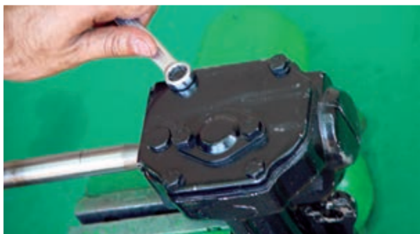
شکل ۲-۶۲ باز کردن درپوش بالایی جعبه فرمان
