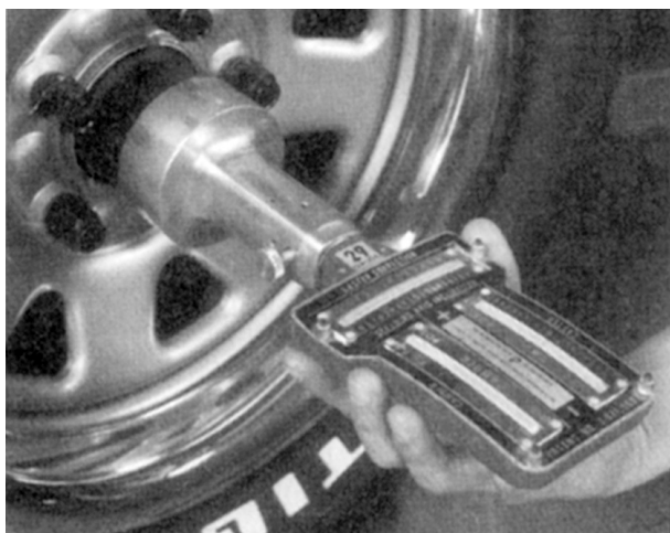
شکل ۲۱۷-۳ دستگاه اندازه‌گیری زوایای مکانیکی (ترازی)
