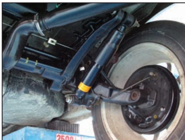
شکل ۳-۱۶۱- محل استقرار کمک فنر و پیچ‌های بالا و پایین آن
