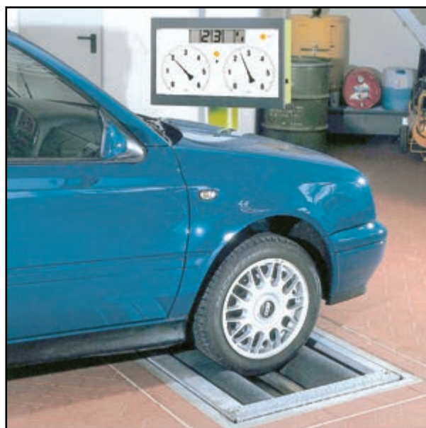
شکل ۱-۷۴- دستگاه آزمایش دینامیکی ترمز
