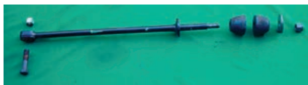
شکل ۳-۸۴ اجزای میل تعادل
