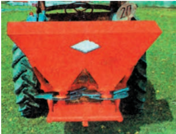
شکل ۱-۲- بذریاش سانتریفوژ با دو صفحه پرتاب کننده
