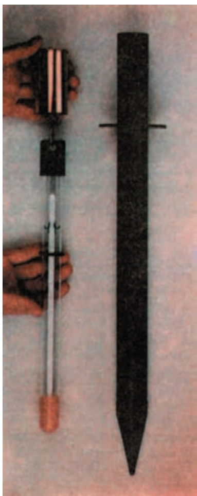
شکل ۲-۲- دماسنج برای اندازه‌گیری درجه حرارت خاک
