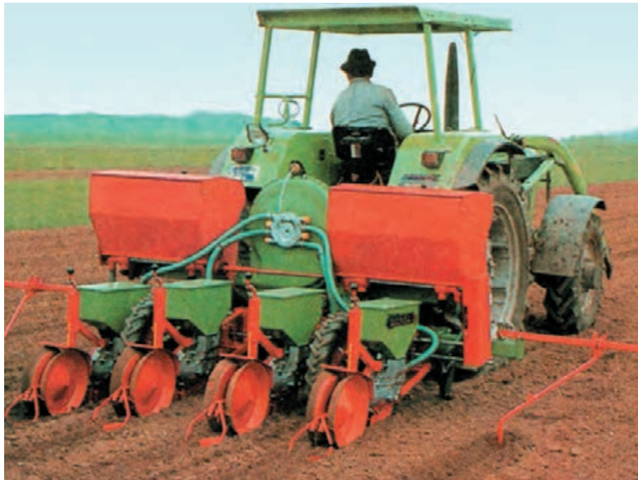
شکل ۲-۴- یک ردیفکار پنوماتیکی حین انجام کار
