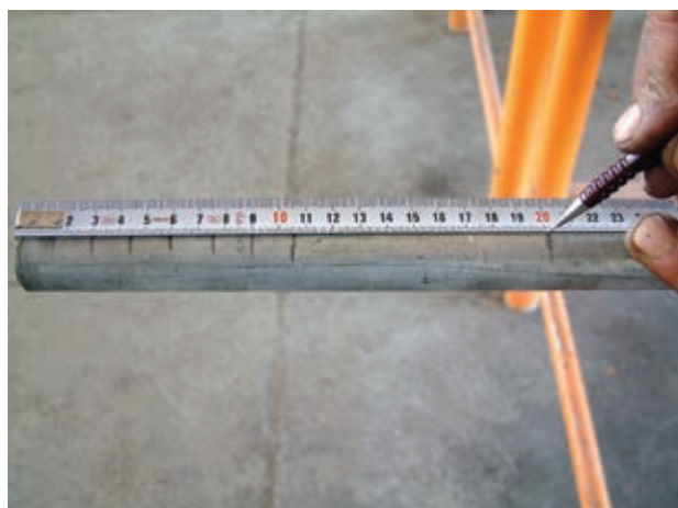
شکل ۱-۶۴- خط کشی کردن لوله
