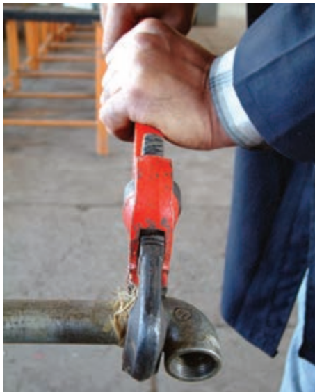
شکل ۵-۵۹- آچار لوله‌گیر
