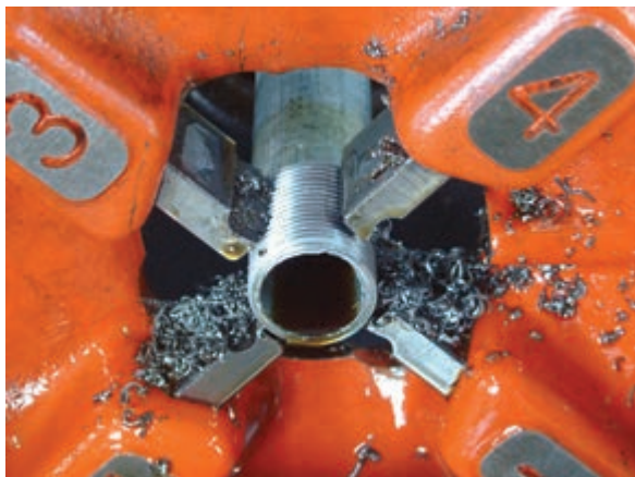
شکل ۴-۱۱۶ طول مناسب دنده
