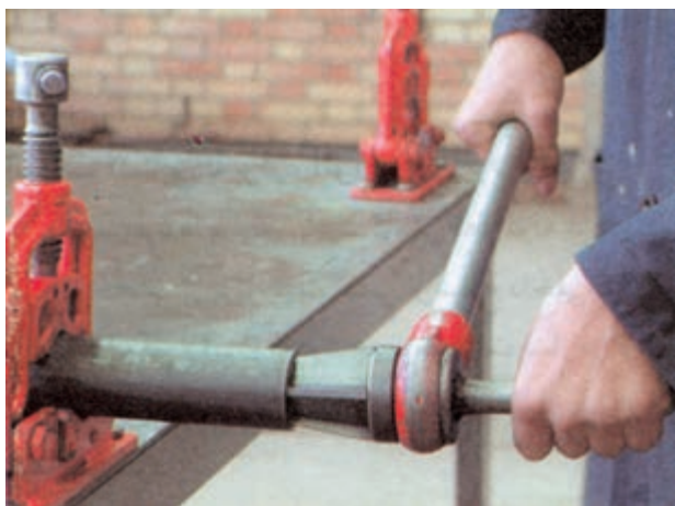
شکل ۱۲-۲ عمل بُرقوکاری
