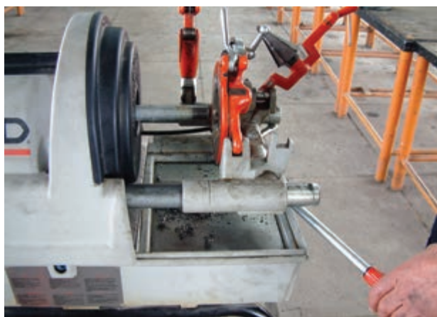
شکل ۴-۱۴۰- پایان عمل حدیده کاری
