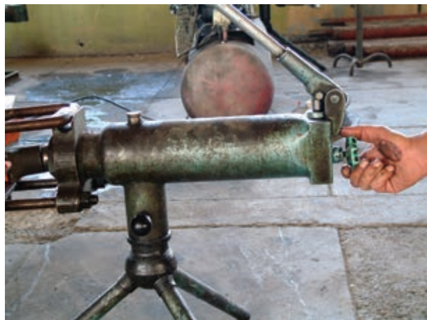
شکل ۳-۲۳- بستن شیر قطع و وصل
