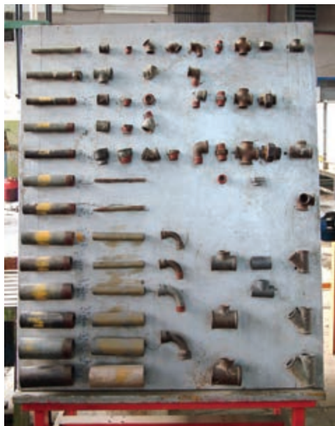
شکل ۳۵-۵- انواع لوله و فیتینگ‌های دنده‌ای
