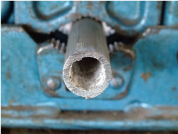
شکل ۵۲-۱- لوله‌ی بسته شده به گیره‌ی لوله
