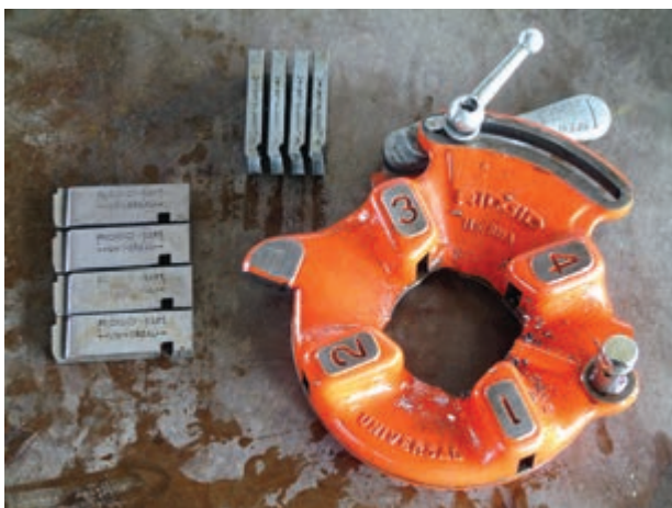
شکل ۸۹-۴- مشخصات حک شده بر روی پارچه‌های حدیده
