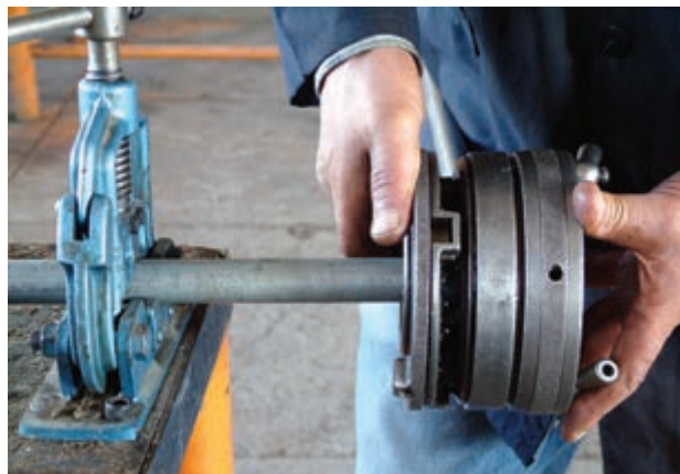
شکل ۵-۱۳۰- حدیده کردن لوله‌ها
