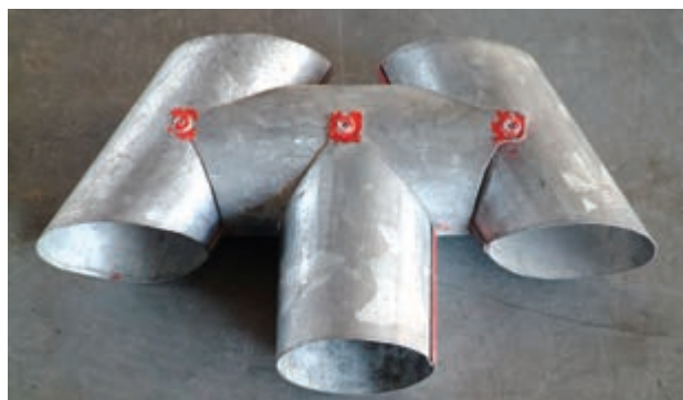
شکل ۴-۱- اتصال چند قطعه به روش پرچ‌کاری
