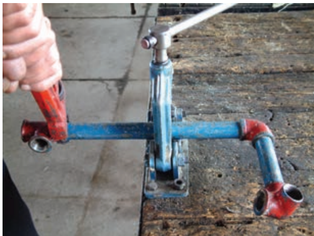
شکل ۵-۱۵۵- بستن سهراهی به ضلع دوم مدار
