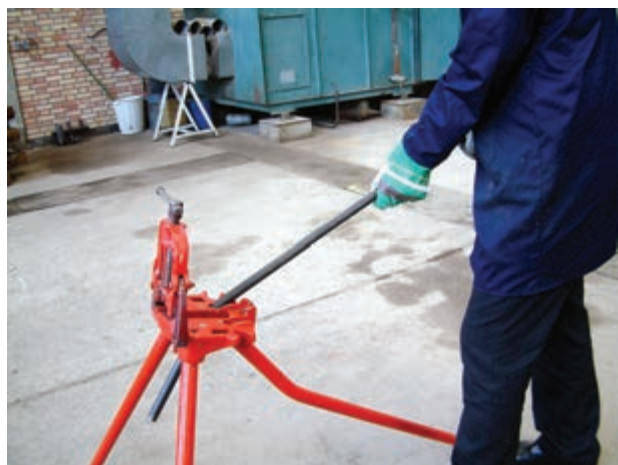
شکل ۳-۹- خم کاری لوله به وسیله‌ی گیره‌ی صحرایی
