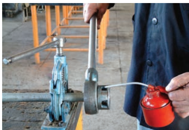
شکل ۴-۴۹- روغن کاری محل تماس پارچه‌ها با لوله
