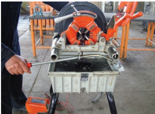
شکل ۱۳۳-۴- عمل حدیده کاری لوله
