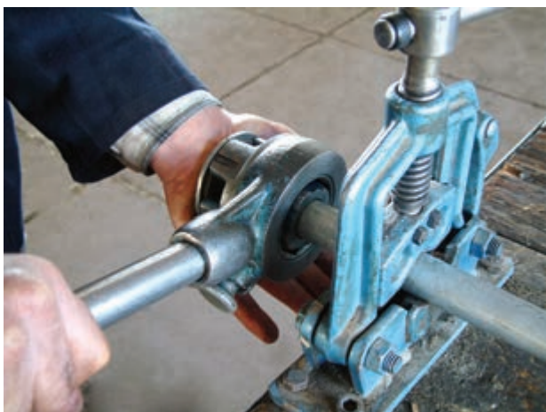
شکل ۴-۴۷- شروع دنده کردن لوله
