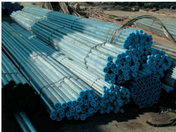
شکل ۴-۱۴ - لوله‌ی فولادی گالوانیزه
