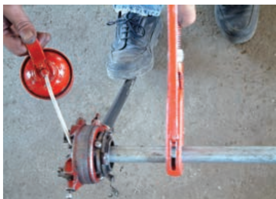
شکل ۵-۱۲۱- استفاده از روغن در جريان حديدكاري
