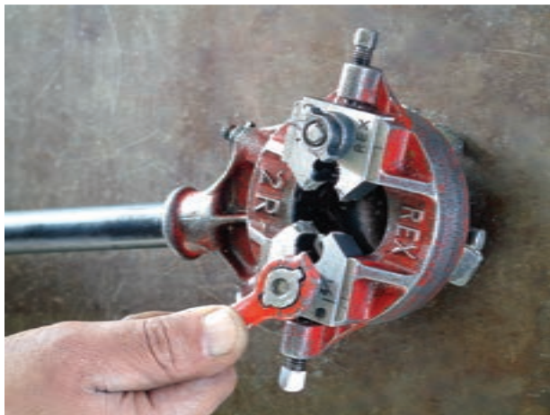
شکل ۴-۲۸- سفت کردن مهره به وسیله‌ی آچار حدیده
