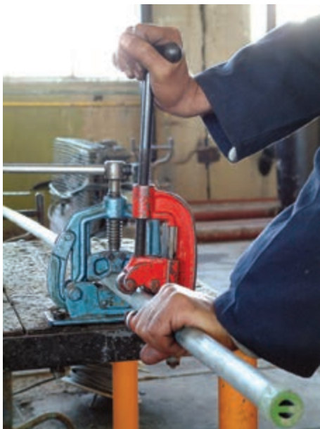
شکل ۱-۵۸ - ادامه‌ی عمل بُرش‌کاری
