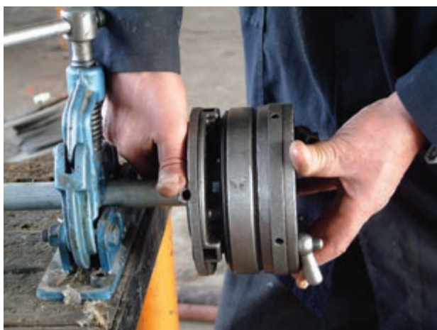
شکل ۴-۶۴- سفت کردن سه نظام حدیده
