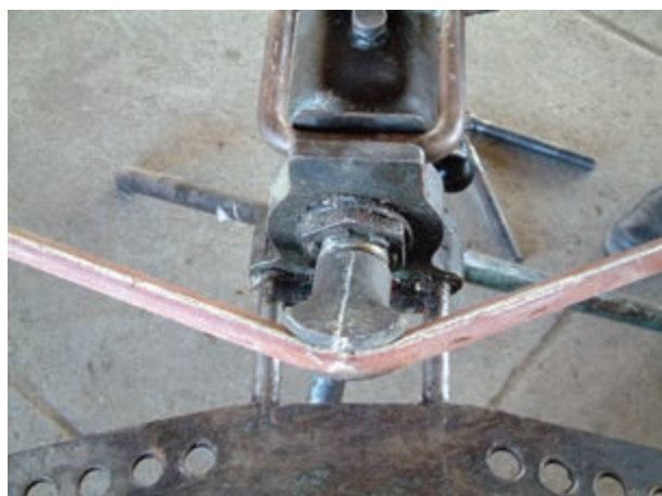
شکل ۳-۲۵- پایان عمل خم‌کاری
