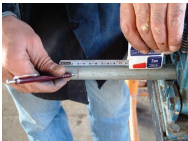
شکل ۷-۱- علامت‌گذاری کردن لوله با متر و مداد
