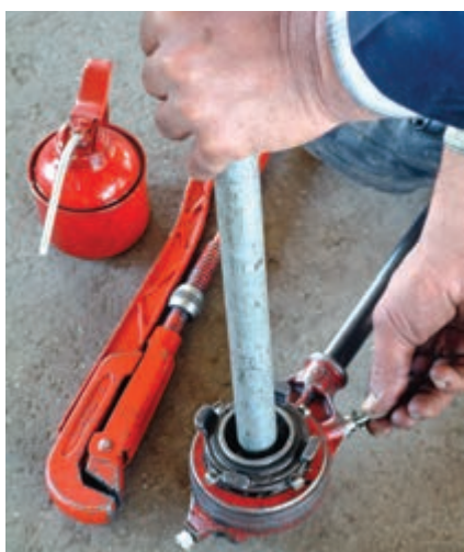
شکل ۱۱۸-۵- قرار دادن ضامن ها در جهت حدیده کردن و حرکت دادن لوله توأم با فشار در جهت دنده شدن لوله
