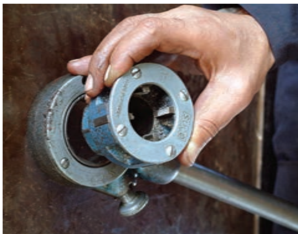
شکل ۴-۴۴- خارج کردن پارچه از بدنه‌ى حديدە
