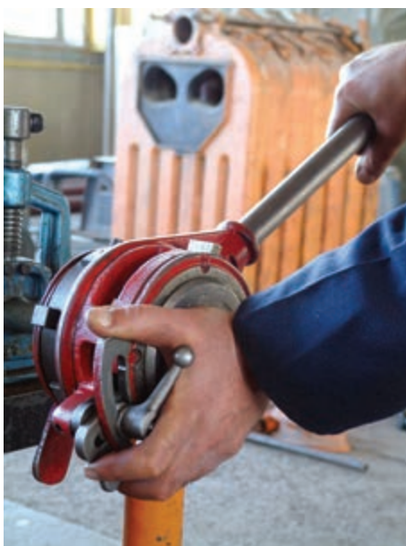
شکل ۴-۱۲۲- عمل درگیر کردن پارچه‌ها با سر لوله
