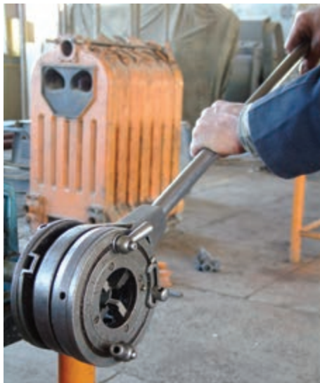
شکل ۴-۶۷- دنده کردن لوله
