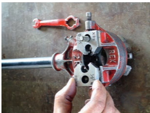
شکل ۴-۲۶ قرار دادن پارچه‌ها در محل خود
