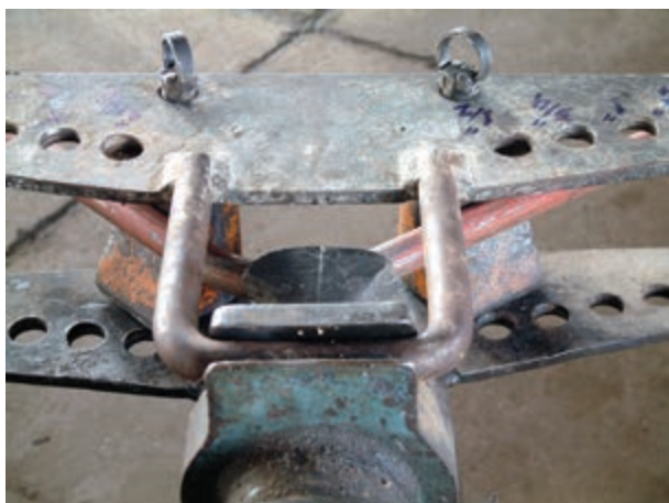
ب- باز کردن خم لوله‌ی خم شده
