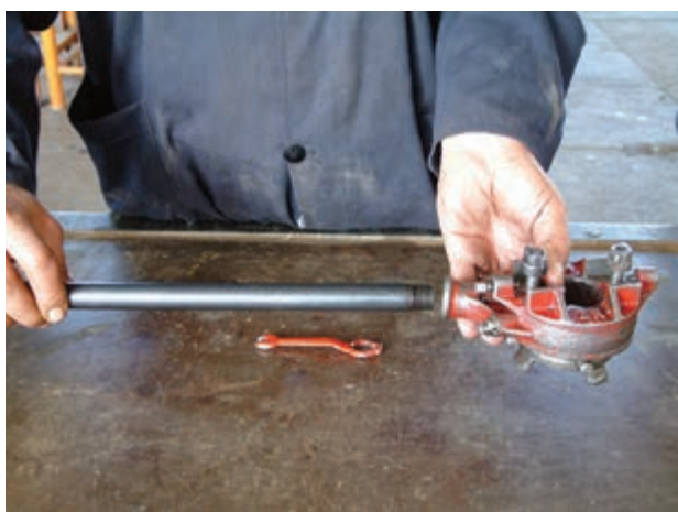
شکل ۴-۲۵ اتصال دسته‌ی حدیده به بدنه‌ی حدیده
