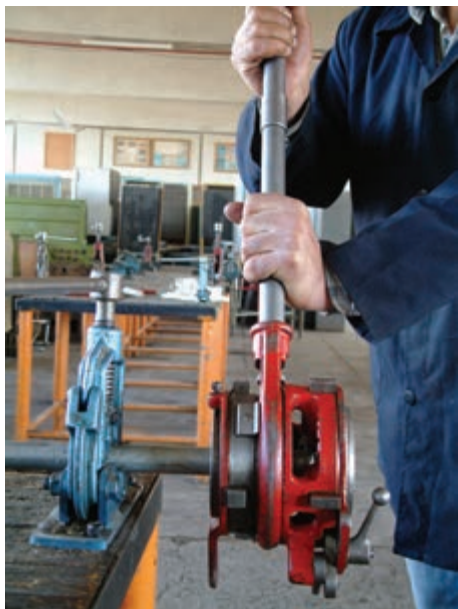
شکل ۱۲۶-۴- باز کردن حدیده از لوله
