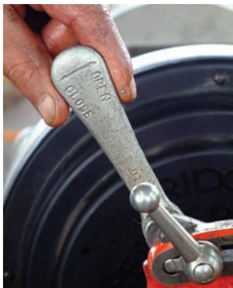
شکل ۴-۹۷ - کشیدن ضامن تنظیم به عقب
