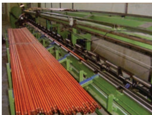
شکل ۵-۹- لوله‌ی مسی به صورت شاخه‌ای
