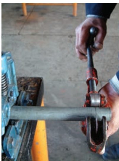
شکل ۴-۷۷- لوله‌بر در حال گردش به دور لوله
