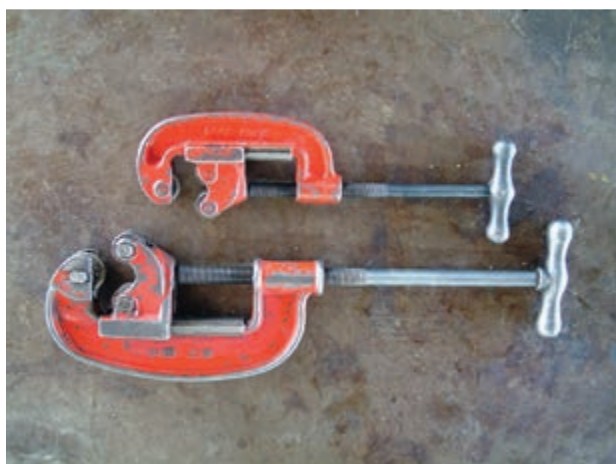
شکل ۱-۶۳- لوله‌بر در دو اندازه‌ی متفاوت
