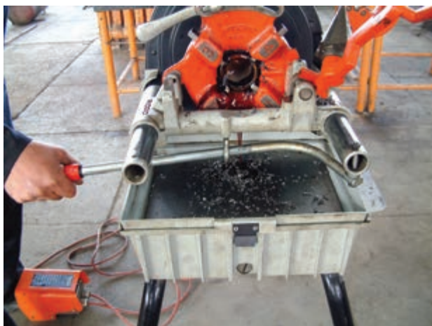
شكل ۴-۸۵- پلیسه‌های ریخته شده بر روی صفحه‌ی مشبک حاصل از عمل حديدكاري
