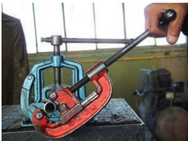
شکل ۱-۵۶- گرداندن لوله‌بُر به دور لوله
