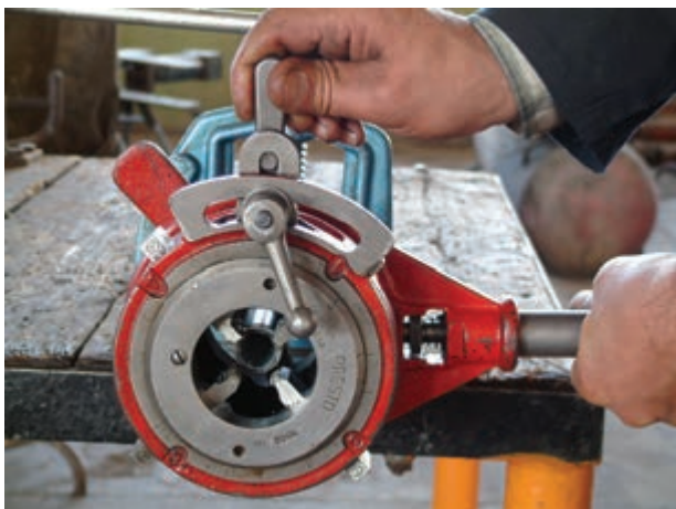
شکل ۱۲۵-۴- کم کردن بار پارچه‌های حدیده
