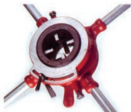
شکل ۴-۵۲- حديد‌ي چهار پارچه‌ي چهار دسته
