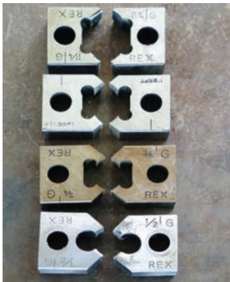
شکل ۴-۲۳- پارچه‌های حدیده‌ی دستی دو پارچه
