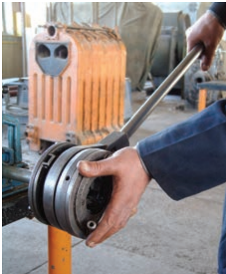
شکل ۴-۶۶- درگیر کردن حدیده با سر لوله
