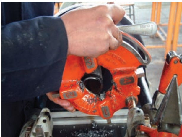
شکل ۴-۹۰ جدا کردن تنه‌ی حديد از دستگاه
