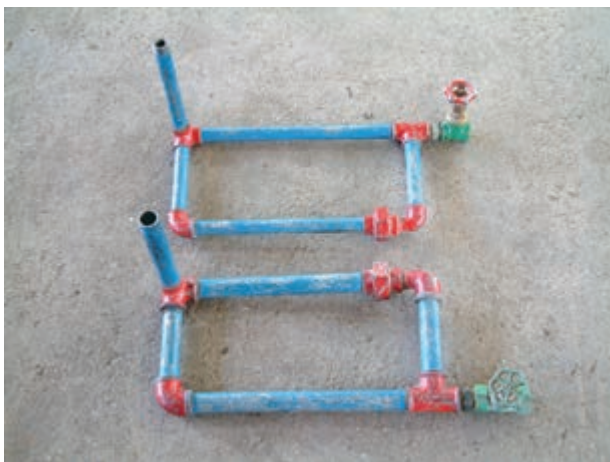
شکل ۵-۱۱۰- مدار بسته لوله‌کشی
