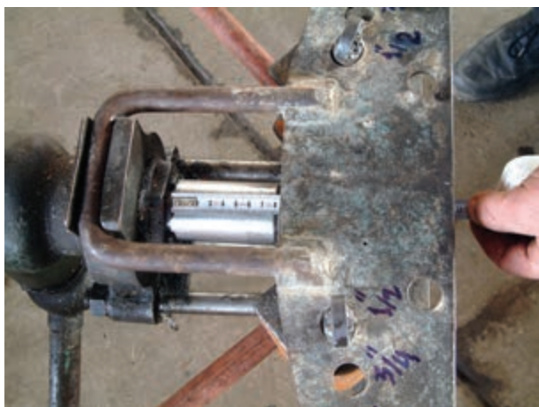
شکل ۳-۲۷- اندازه‌گیری طول پیستون خارج شده از سیلندر
