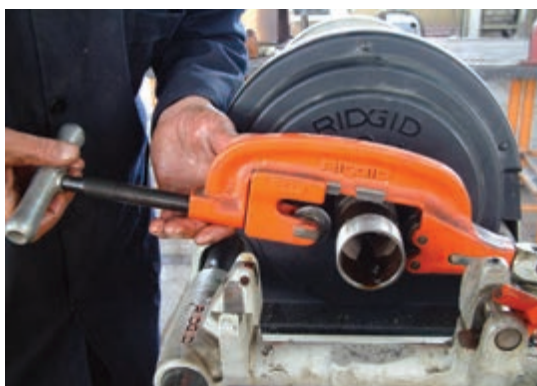
شکل ۴-۱۰۱- بریدن لوله به وسیله‌ی لوله‌بر
