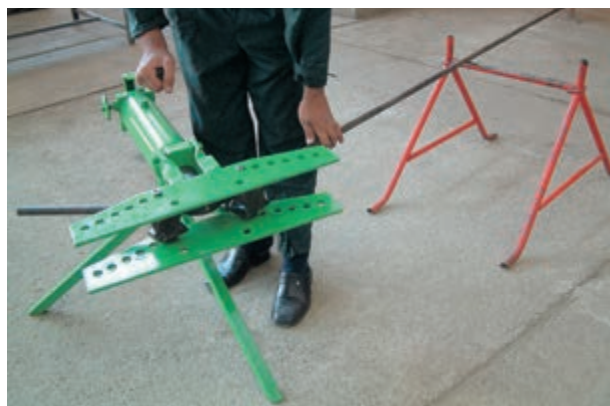
شکل ۳-۴۲- استفاده از خرک در خم کاری
