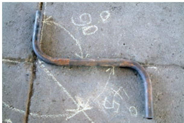
شکل ۳-۴۱- عدم دویدگی لوله‌ی دو خم
