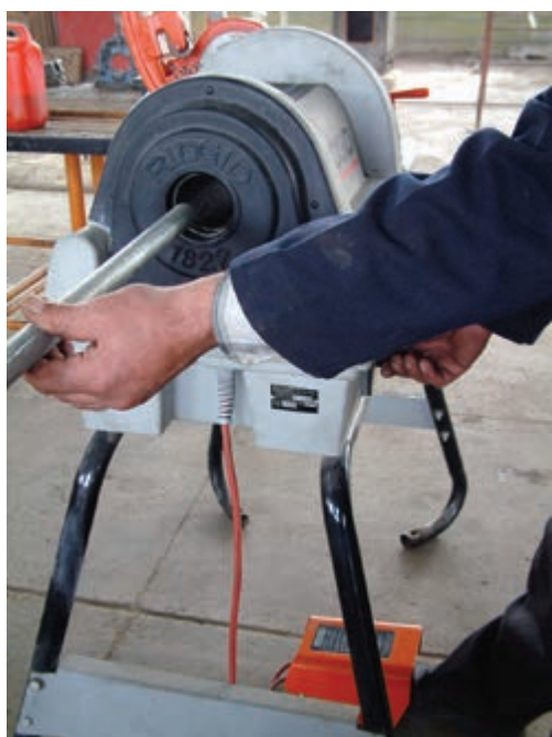
شکل ۱۳۱-۴- قراردادن لوله در حدیده‌ی ماشینی
