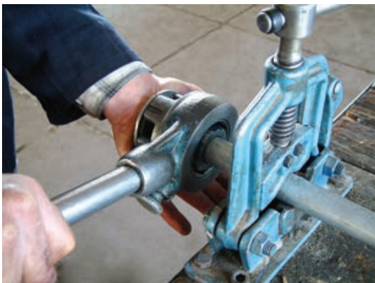
شکل ۱۵۱-۵- حدیده کردن لوله‌ها
