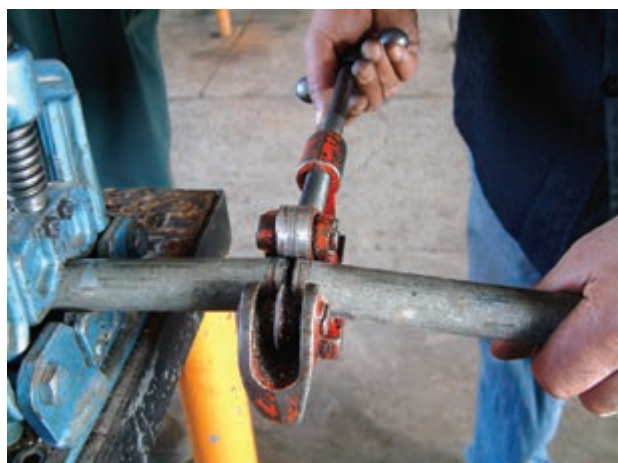
شکل ۱-۵۹ - انتهای عمل بُرش‌کاری
