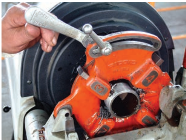
شکل ۴-۷۸- عمل حدیده کاری با ماشین
