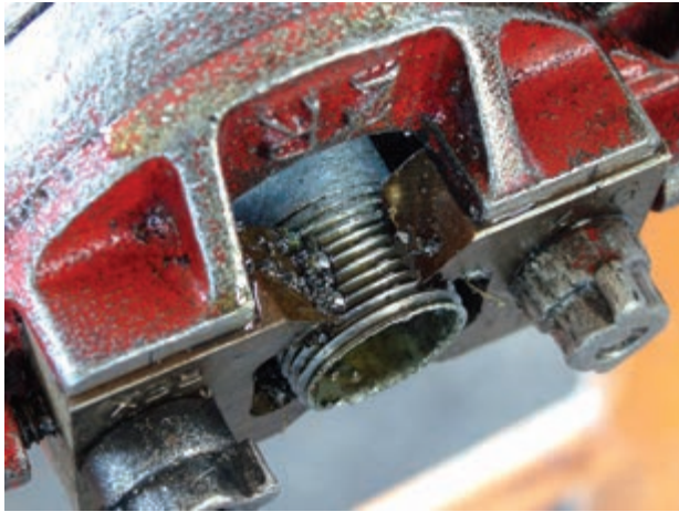
شکل ۴-۳۶- عبور دو دندانه از انتهای پارچه
