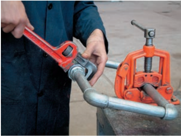
شکل ۱۰۶-۵- نحوه‌ی غلط سفت کردن مهره ماسوره
