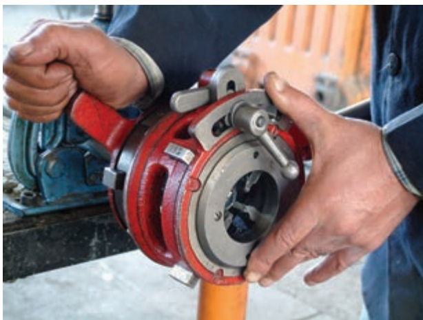
شكل ۴-۱۱۴- سفت كردن فلكه‌ي چهار نظام
