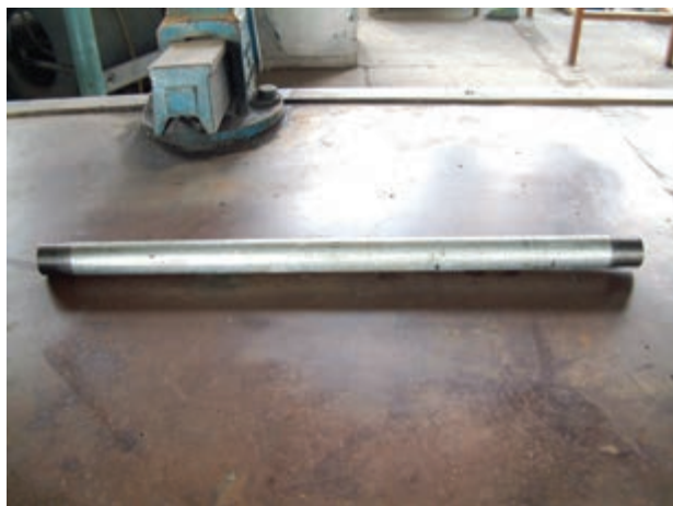
شکل ۱۴۱-۴- لوله‌ی دو سر دنده شده
