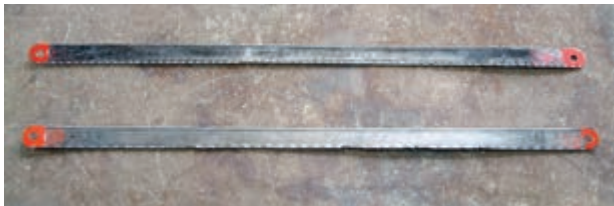
شکل ۱-۴۰ از بین رفتن دندانهای تیغه اژه
