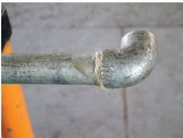
شکل ۹۸-۵- فیتینگ بدون لبه
