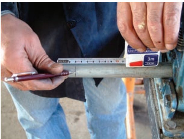
شکل ۵۳-۱- مشخص کردن محل برش
