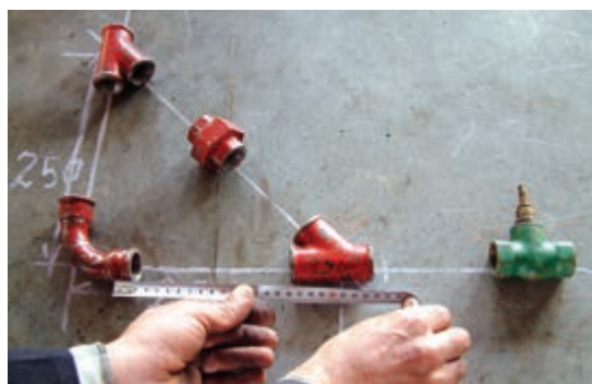
شکل ۱۳۴-۵ اندازه‌گیری لوله‌های مورد نیاز
