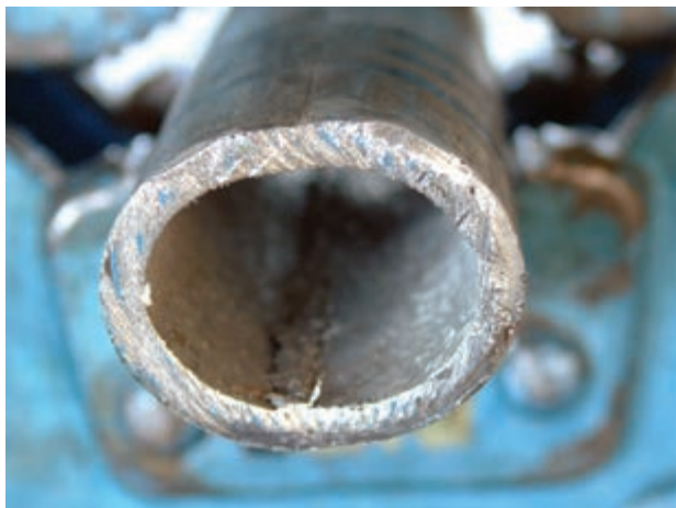
شکل ۱-۶۱- لوله‌ی دو پهن شده
