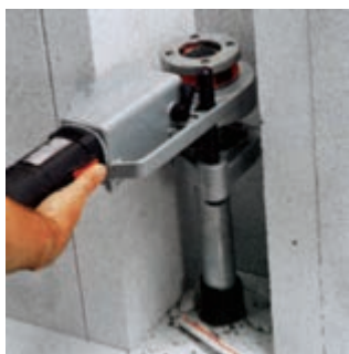
شکل ۴-۱۰۵ - طرز استفاده از حديدى
