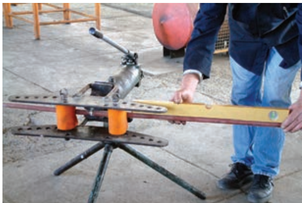
شکل ۳-۴۳- کنترل افقی بودن لوله در خم کاری
