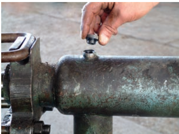
شکل ۱۵-۳ سرپوش مجرای ورودی روغن
