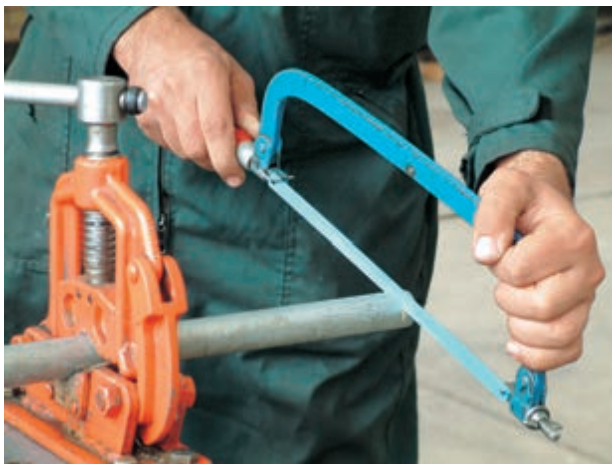
شکل ۵۰-۱- عدم رعایت فاصله‌ی مناسب از لب گیره
