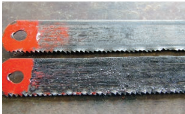
شکل ۱-۴۷- تیغه اره‌های دندان‌ها شکسته شده
