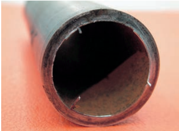
الف - لوله‌ی بریده شده به وسیله‌ی لوله‌بر
