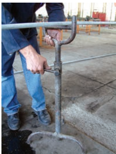
شکل ۴-۷۶- طرز تنظیم خرک به زیر لوله
