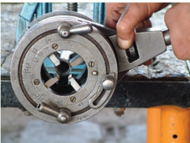
شکل ۴-۵۶- قرار دادن ضامن در حالت F
