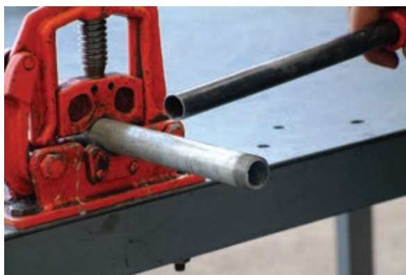
شکل ۴-۱۱۷ جداسازی پلیسه از سر دنده
