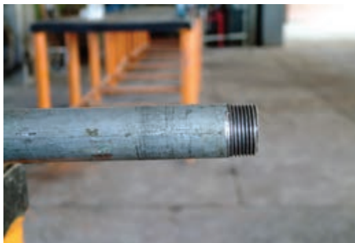
شکل ۵-۴- لوله‌ی فولادی گالوانیزه
