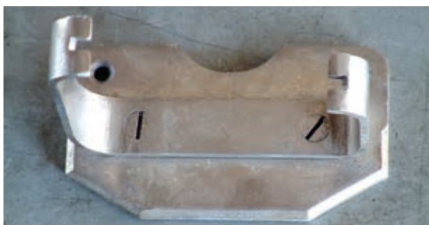
شکل ۴-۵- اتصال موقت با استفاده از پیچ
