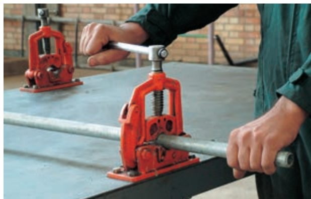
شکل ۳-۵۳- باز کردن شاخه‌ی لوله از گیره‌ی لوله
