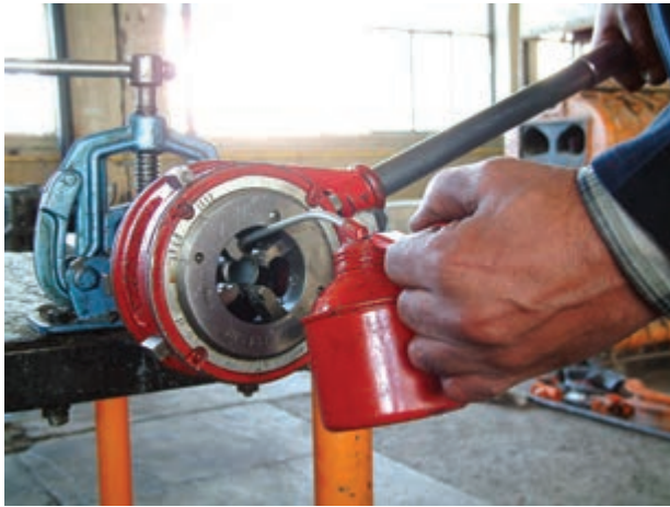
شکل ۱۲۳-۴- استفاده از روغن‌دان در جریان حدیده‌کاری
