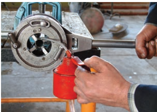
شکل ۴-۶۸- عمل روغن‌کاری در حین حدیده‌کاری
