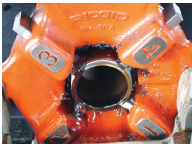
شکل ۴-۹۵- عمل حدیده‌کاری به وسیله حدیده‌ی ماشینی
