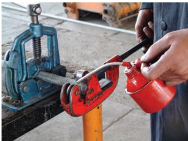
شکل ۱-۵۷- ریختن روغن در محل تماس
