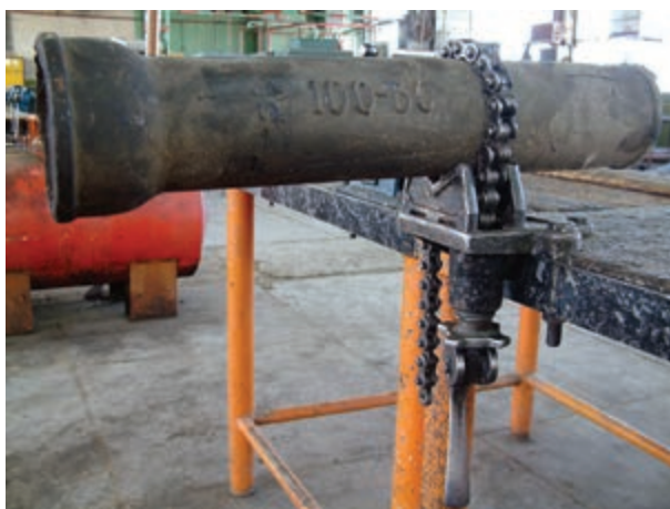
شکل ۱-۳۴- بستن لوله به گیره‌ی زنجیری
