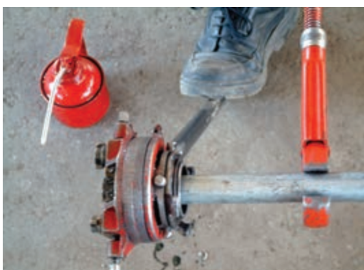
شکل ۵-۱۲۳- عمل باز كردن سردنده از پارچه‌هاى حديدكاري
