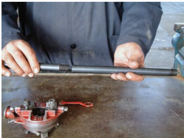
شکل ۴-۲۴ اتصال دسته‌ی دو تکه به یک‌دیگر
