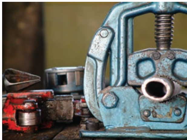
شکل ۱۶-۲- لوله‌ی دو پهن شده
