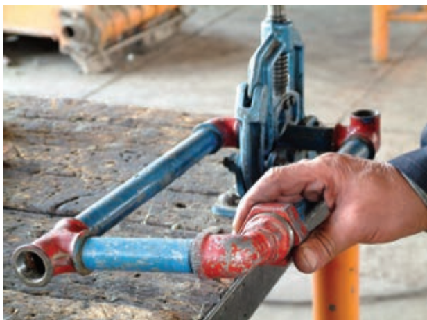
شکل ۵-۱۶۰- بستن مهره ماسوره به وسیله‌ی دست
