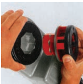
شکل ۴-۱۰۴ - تعويض پارچه هاى حديدى
