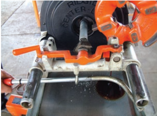
شکل ۱۳۲-۴- عمل بُرقوکاری
