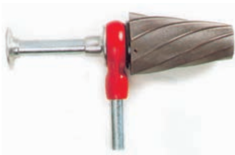
شکل ۲-۴- بُرقوی چند شیاره‌ی مارپیچ
