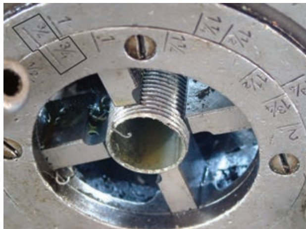
شکل ۴-۶۹- حد صحیح حدیده کردن لوله ی \frac{3}{4} "
