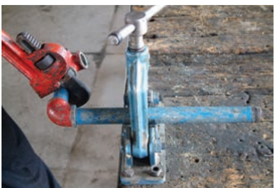
شکل ۱۵۴-۵- بستن لوله‌ی ضلع دوم مدار
