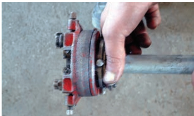
شکل ۱۲۴-۵- باز کردن فلکهای چهار نظام حدیده
