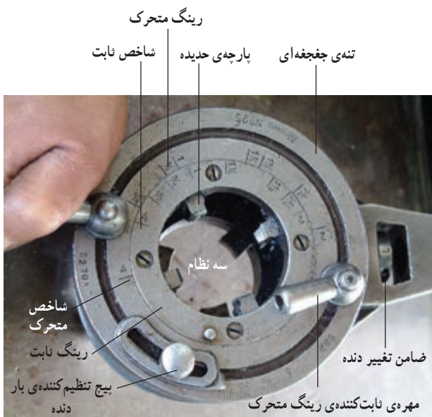
شکل ۴-۵۵- اجزای حدیده‌ی دستی چهارپارچه
