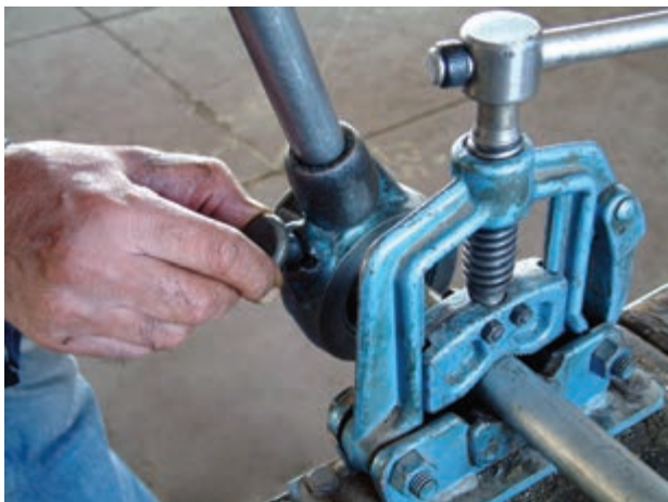
شکل ۴-۴۶- قرار دادن ضامن در جهت حدیده کردن
