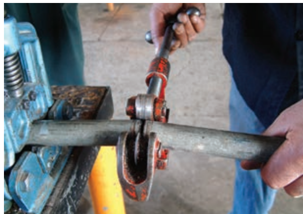
شکل ۳-۵۲- بریدن لوله‌ی محاسبه شده
