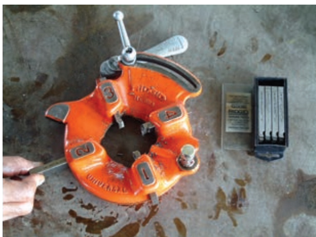
شکل ۴-۹۲ جا زدن پارچه‌ها در شيارهای تنه‌ی حديد
