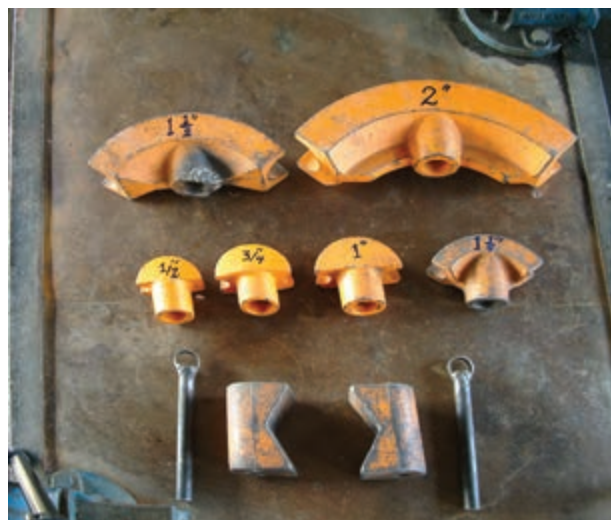
شکل ۳-۲۰- پارچه‌ها و لقمه‌های خم‌کن هیدرولیکی
