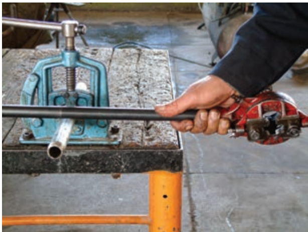
شکل ۴-۴۰ جدا کردن پلیسه‌ها از سر دنده
