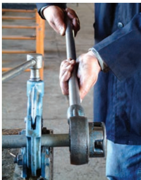
شکل ۴-۵۰- باز کردن حدیده از لوله
