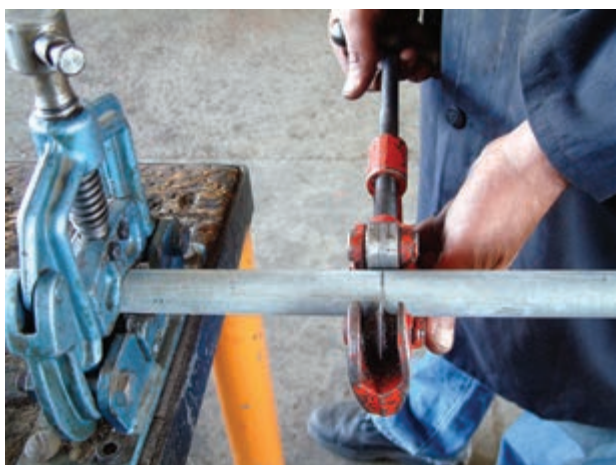
شکل ۱-۶۲- سفت کردن دسته‌ی لوله‌بر به اندازه‌ی لازم
