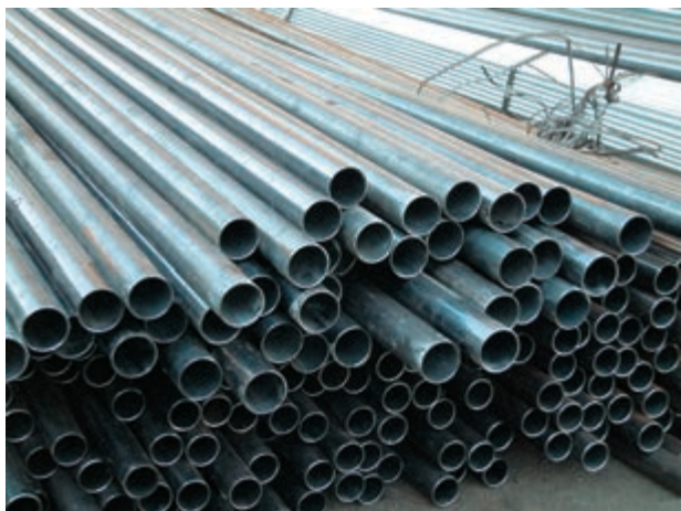
شکل ۴-۹- لوله‌های فولادی
