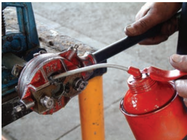
شکل ۴-۳۵- روغن کاری
