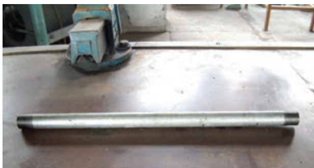
شکل ۴-۶- لوله ی دو سر دنده شده
