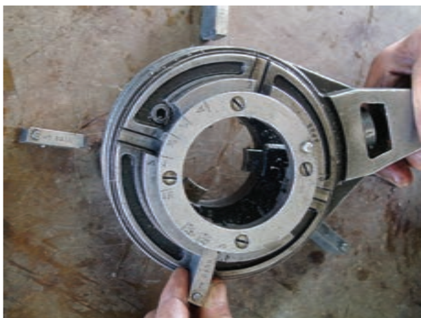
شکل ۴-۵۹- خارج کردن پارچه‌ها از حدیده
