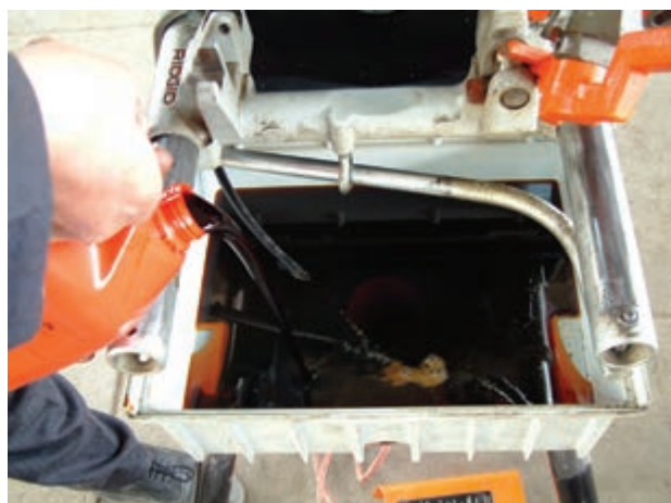
شکل ۴-۸۳- مخزن روغن حدیده‌ی ماشینی
