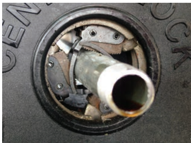
شکل ۴-۷۳ - سه نظام ثانویه‌ی حدیده‌ی ماشینی
