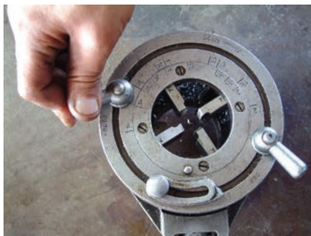
شکل ۴-۶۲- سفت کردن مهره‌های ثابت‌کننده‌ی رینگ متحرک
