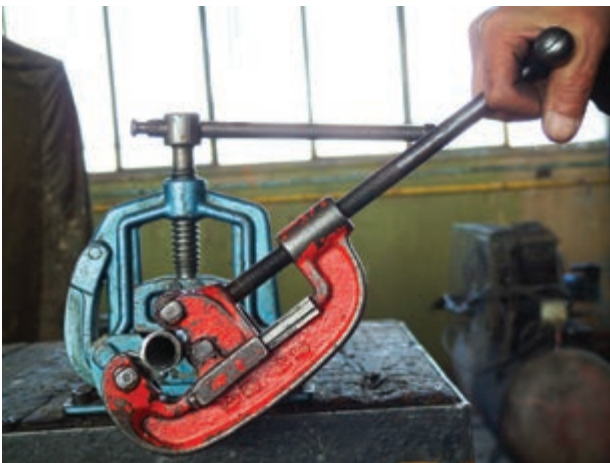
شکل ۱۵۰-۵- بریدن لوله ها
