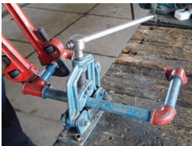
شکل ۵-۱۵۶- بستن ضلع سوم مدار به سهراهی
