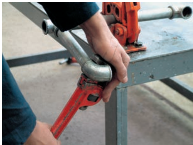
شکل ۱۰۵-۵- روش غلط سفت کردن مدار
