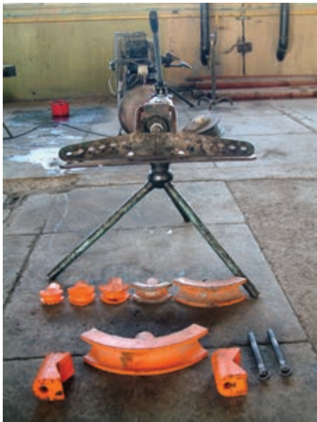
شکل ۱۳-۳ اجزای خم کن هیدرولیکی
