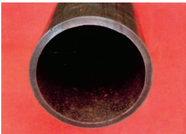
شکل ۴-۱۳- لوله‌ی فولادی بدون درز
