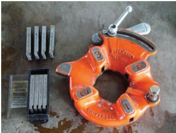
شکل ۸۸-۴- تنه‌ی حدیده و پارچه‌های آن
