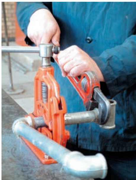
شکل ۱۰۳-۵- نحوه‌ی صحت سفت کردن فیتینگ به لوله
