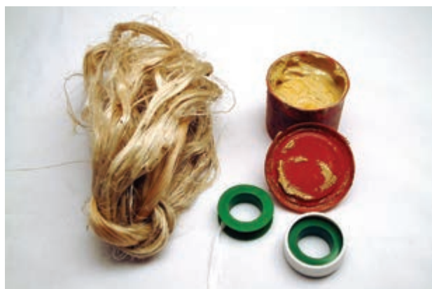
شکل ۴۸-۵- مواد آببندی لوله کشی آب و فاضلاب
