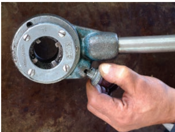
شکل ۴-۴۳- خارج کردن ضامن از شيار
