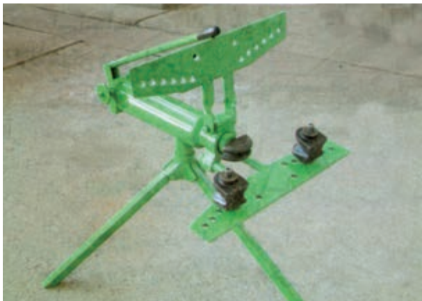
شکل ۳-۴۸ قرار گرفتن لقمه در محل مناسب خود
