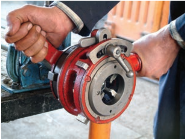
شکل ۴-۱۲۰- بستن اهرم فلکهای چهار نظام
