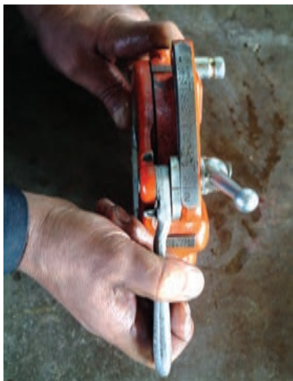
شکل ۴-۹۳- تنظیم حدیده به اندازه‌ی لوله‌ی ۲ اینچ
