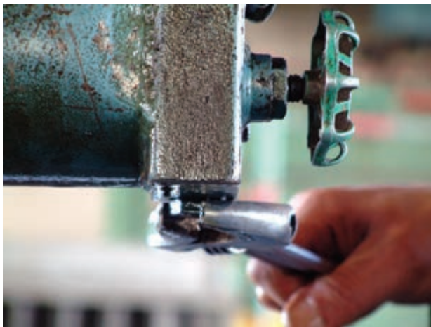
شکل ۱۴-۳ باز کردن درپوش تخلیه ی روغن
