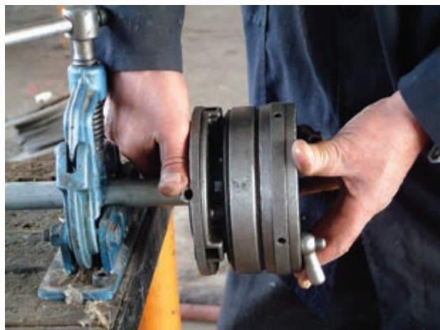
شکل ۴-۷۱- باز کردن سه نظام حدیده
