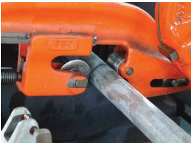
شکل ۴-۱۳۷- بریدن لوله به وسیله ی لوله بُر
