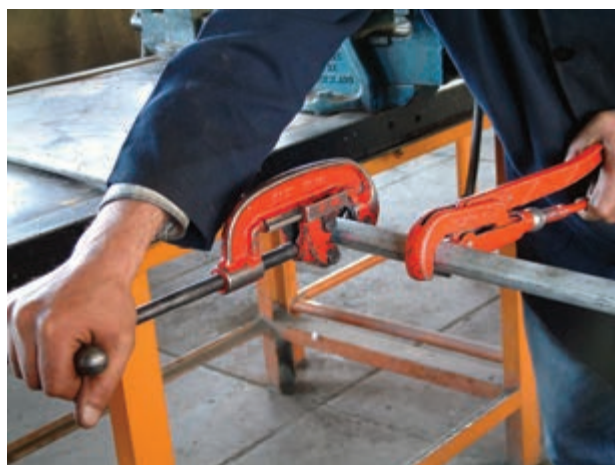
شکل ۱۱۶-۵- ادامه‌ی برش‌کاری لوله
