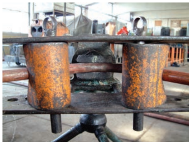
الف- باز کردن خم لوله‌ی خم شده
