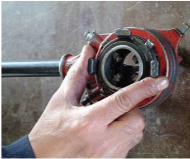
شکل ۴-۲۱- فلکه‌ی چهار نظام حدیده‌ی دستی دو پارچه
