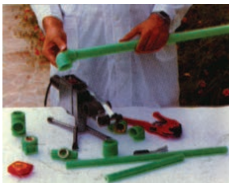
شکل ۵-۲۹- اتصال لوله و فیتینگ پلی‌پروپیلنی پس از خنک شدن
