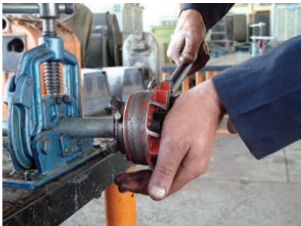
شکل ۴-۳۳- درگیر نمودن پارچه‌های حدیده با لوله
