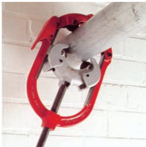
شکل ۱-۲۳- لوله‌بر دستی چهار تیغه
