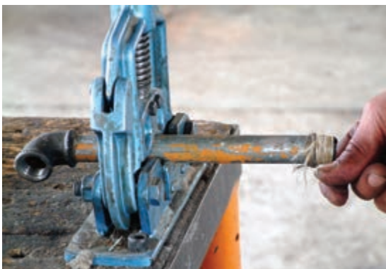
شکل ۱۵۳-۵- خمیر و کنف کردن سردنده‌ی بعدی
