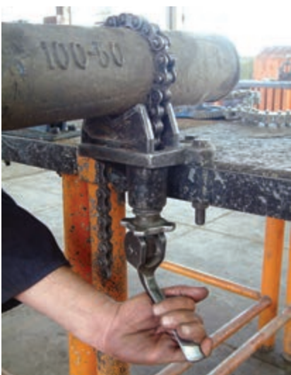
شکل ۱-۳۳- کشیدن اهرم قفل‌کننده
