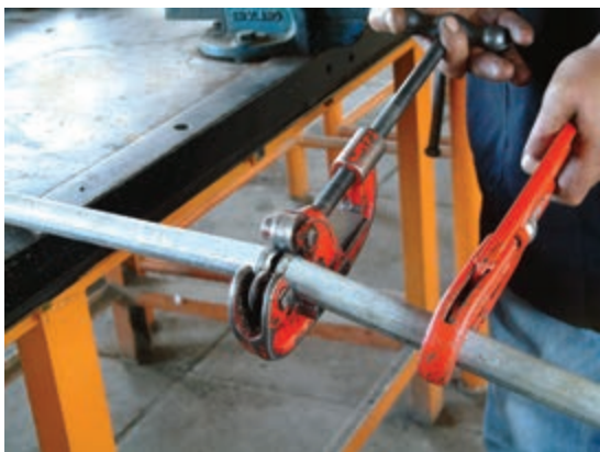
شکل ۱۱۷-۵- بریده شدن لوله و خاتمی کار
