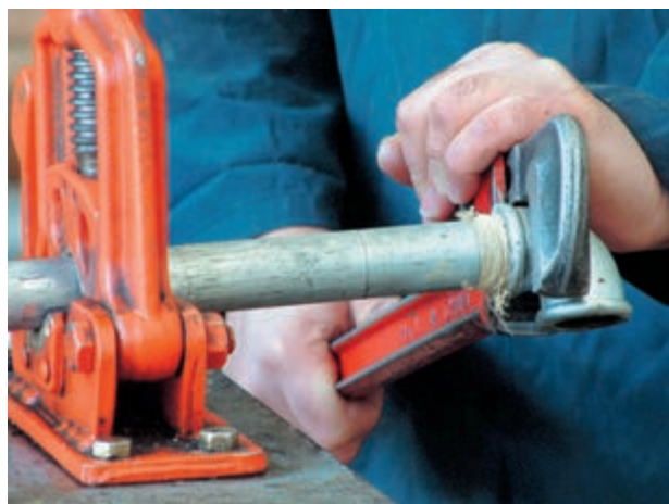
شکل ۹۲-۵- سفت کردن فیتینگ به وسیله‌ی آچار لوله‌گیر
