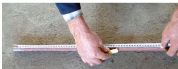
شکل ۳-۵۴- خط‌کشی لوله و تعیین محل‌های خم
