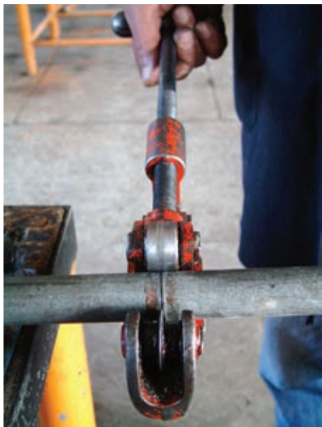
شکل ۱-۵۵- بریدن لوله
