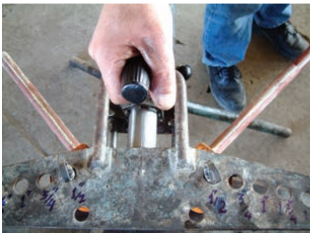
شکل ۱۲-۳- بعد از عمل خم کاری
