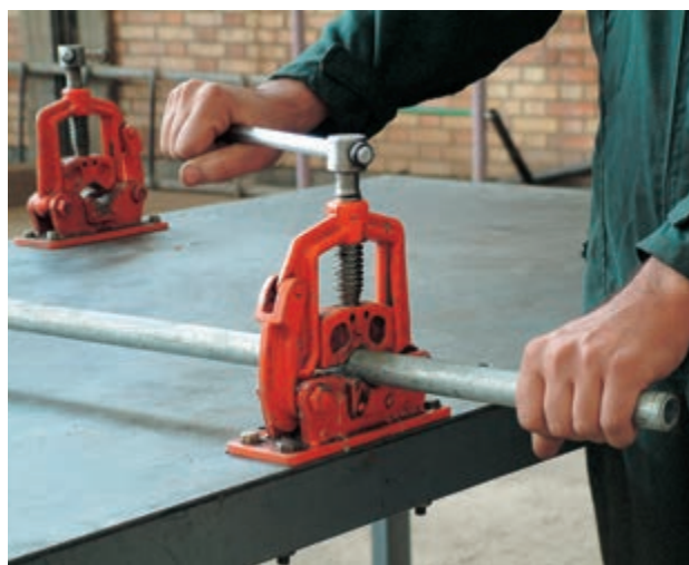
شکل ۱-۲۸ بستن لوله به گیره‌ی لوله
