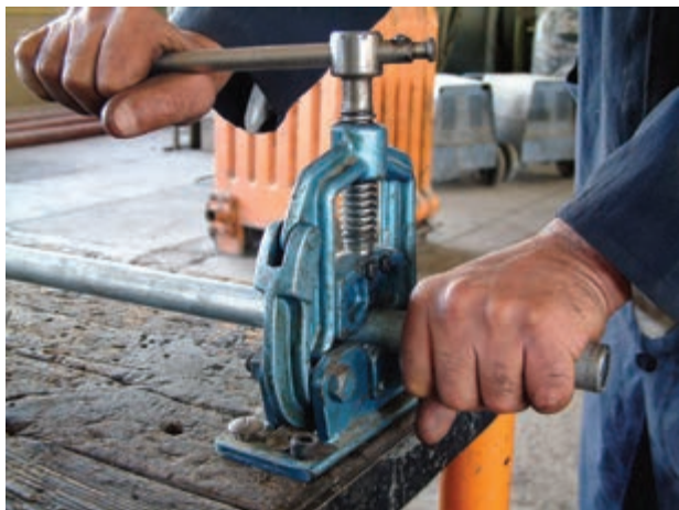
شکل ۱-۳۵- بستن لوله به گیره برای ارّه کاری
