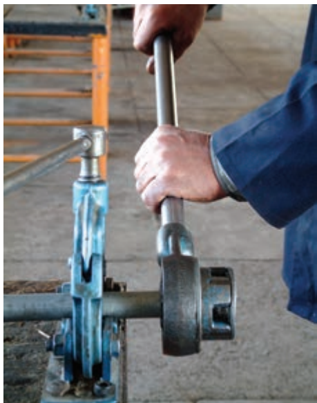
شکل ۴-۴۸- عمل حدیده کاری
