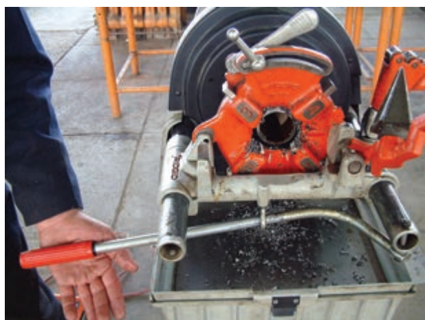
شکل ۴-۹۸ - کشیدن اهرم به عقب پس از حدیده‌کاری
