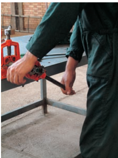
شکل ۱۱۲-۴ حدیده ی متناسب با قطر لوله
