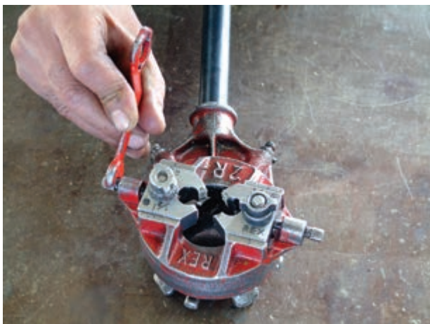
شکل ۴-۲۹- تنظیم کردن حدیده به وسیله‌ی آچار حدیده
