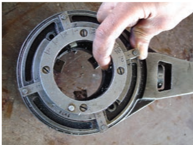
شکل ۴-۶۰- قرار دادن پارچه‌های مناسب در حدیده
