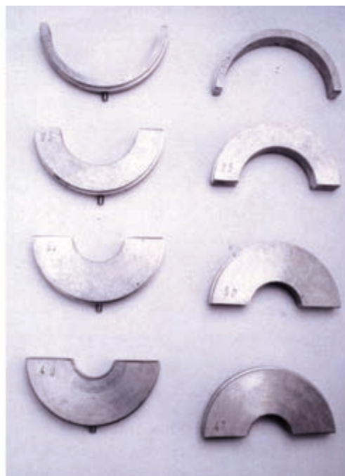
قالب‌های لوله‌بُر و پیخزن پایه‌دار
