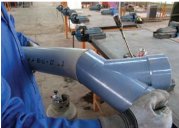
شکل ۲-۹ درست کردن سرکاسه
