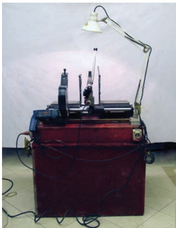
شکل ۳۷-۲ دستگاه جوش لوله و فیتینگ پلی اتیلن
