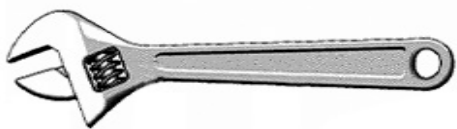
شکل ۱۲۰-۲- نمای ظاهری یک آچار فرانسه
