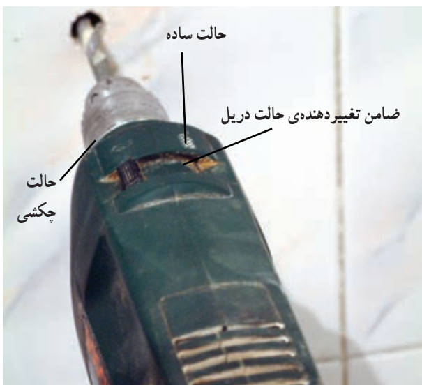
شکل ۲۱۲-۳ سوراخ کردن محل علامت‌گذاری شده
