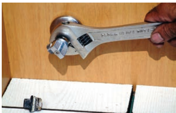
شکل ۳-۲۵۴- سفت کردن شیر پیسوار
