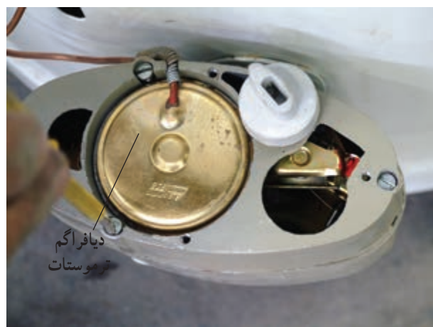
شکل ۵۵-۱- ب - دیافراگم ترموستات
