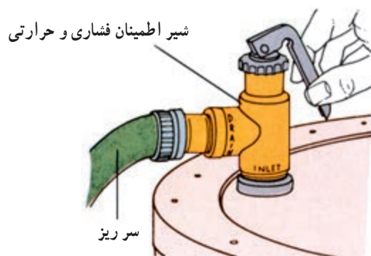
شکل ۲-۱۰۹- شیر اطمینان فشاری - حرارتی
