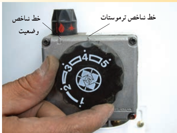
شکل ۱۱۰- تغییر کلید تنظیم دما (ترموستات)
