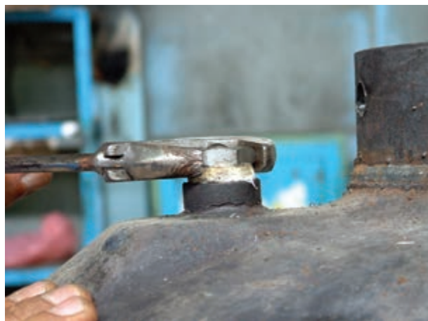
شکل ۱-۲۴- نحوه‌ی بازکردن میله‌ی منیزیم از محل خود
