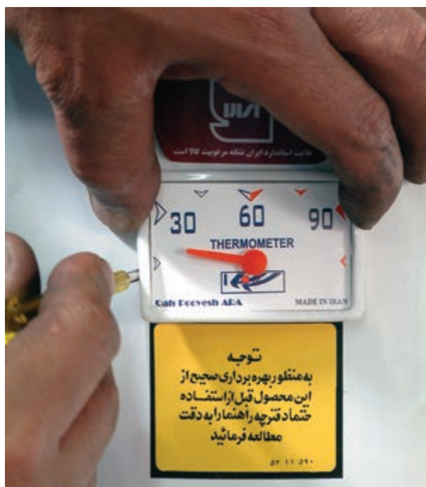
شکل ۱-۱۱۷ جدا کردن ترمومتر از روپوش
