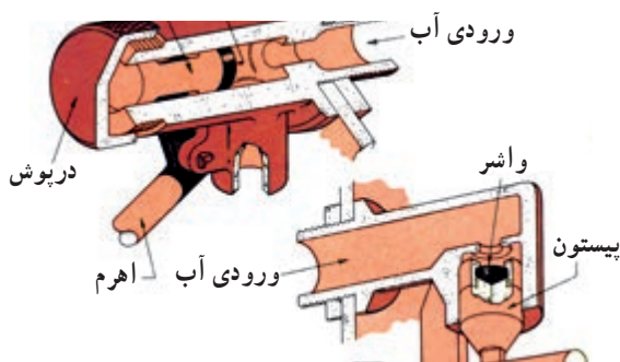
شکل ۱۱۳-۲ اجزای شیر شناور
