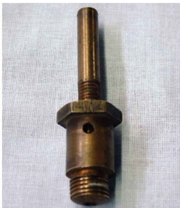
شکل ۱-۳۲- شیر قطع و وصل مخزن سوخت
