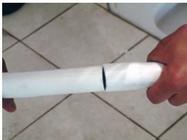
شکل ۳-۲۰۶- جا زدن لوله‌های تخلیه در درون یکدیگر
