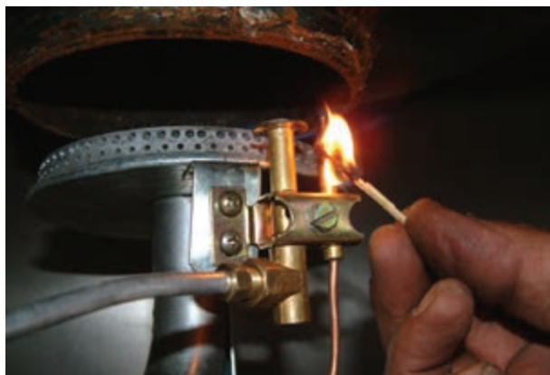
شکل ۱-۱۰۵ مشتعل کردن شمعک به وسیله‌ی شعله‌ی کبریت
