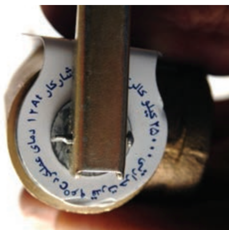
شکل ۲-۱۰۸- شیر اطمینان فشاری و حرارتی
