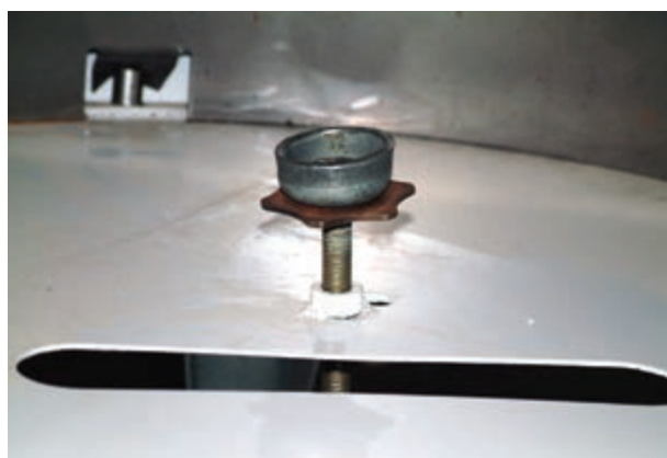
شکل ۹-۱- جک نصب شده بر روی شاسی
