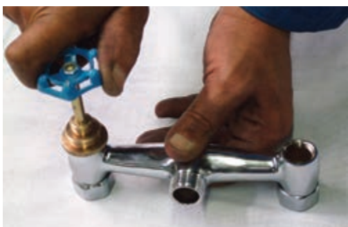
شکل ۲-۶۸- شیر تراش در حال کار شیر تراش
