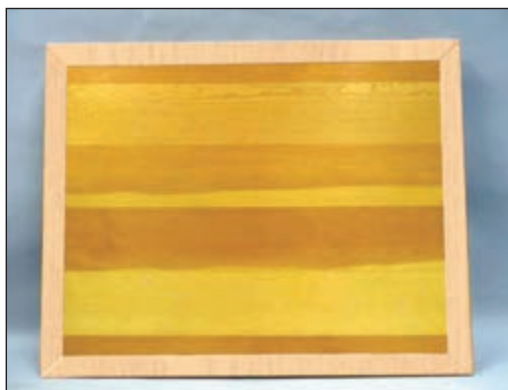
شکل ۱۵-۱ تخته رسم از جنس چوب با زهوار
