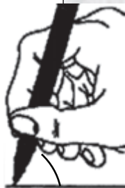
شکل ۳-۱۳ زاویه ی قلم کمتر از ۸۰ درجه نباشد.
