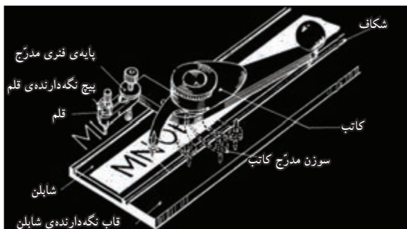
شکل ۹۹-۱ دستگاه پانتوگراف و نحوه ی شابلن نویس با آن
