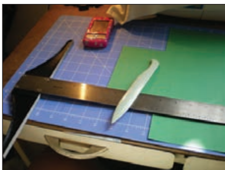
شکل ۱-۳۱ خط کش تی فلزی با سر ثابت
