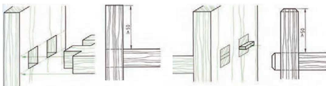
شکل ۵-۷۱: ترسیم اتصال میانی انگشتی در برش پیشانی
