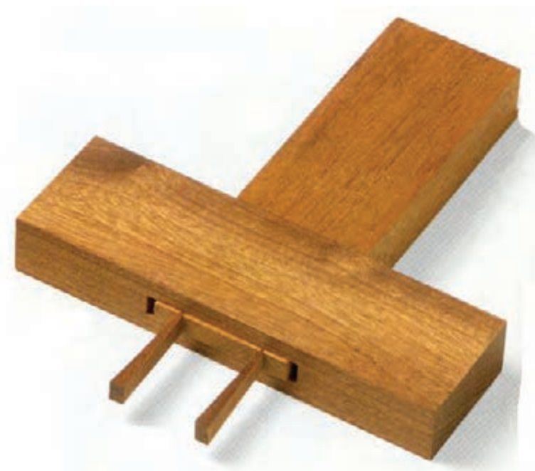
شکل (۳-۱۳۷) تصویر مجسم اتصال میانی کم و زبانه با گوه
