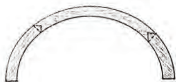
شکل (۳-۱۳۴) اتصال طولی قطعات قوس دار
