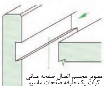
شکل (۳-۱۴۱) تصویر مجسم اتصال صفحه‌ای صفحه‌ای میانی گرات یک طرفه صفحات ماسیو
