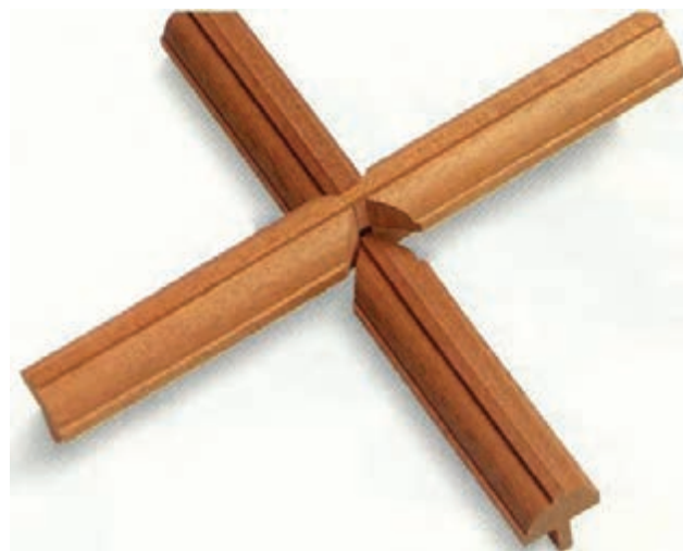
شکل (۳-۱۶۴) تصویر مجسم انفجاری اتصال متقاطع نیم نیم پروفیل شده
