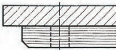
شکل (۴-۲۷) ترسیم هاشور راه چوب و سرچوب ماسیو پیچ شده
