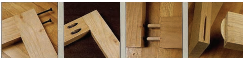
تصویر مجسم اتصال گوشه‌ای بیسکوییتی ساده تصویر مجسم اتصال گوشه‌ای دوبل تصویر مجسم اتصال گوشه‌ای مورب با پیچ تصویر مجسم اتصال با پیچ چوب
