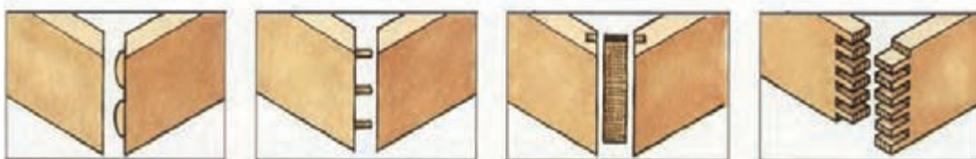
شکل (۵-۴۷) اتصال گوشه‌ای تصویر مجسم اتصالات انگشتی، قلیف زبانه جدا، دوبل و بیسکوییتی
