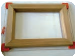
شکل ۲-۳۴- پرداخت قاب ساخته شده، بستن قاب توسط گیره قاب بندی
