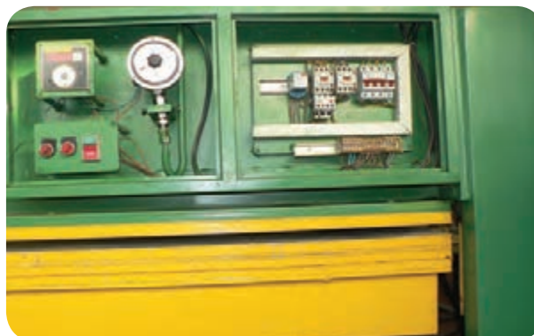
شکل ۸۴-۵: تابلوی فرعی برق نصب شده روی پرس
