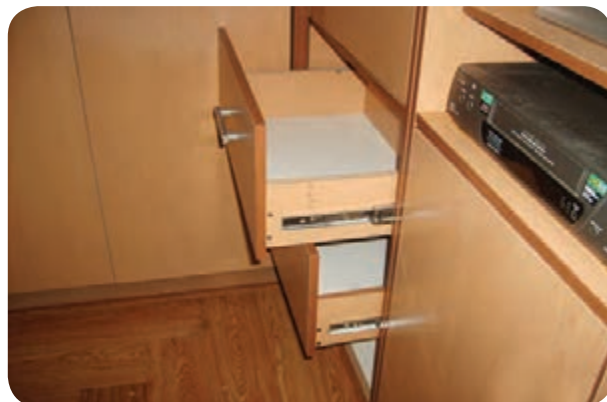
شکل ۱۷۷-۵- نصب کشویی تلسکوپی سه ریله برای کشو
