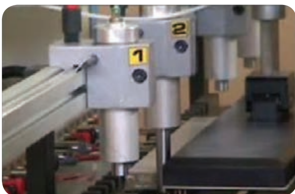
شکل ۳-۷ - قطعه کار، توسط جک‌ها گونیا شده است.
