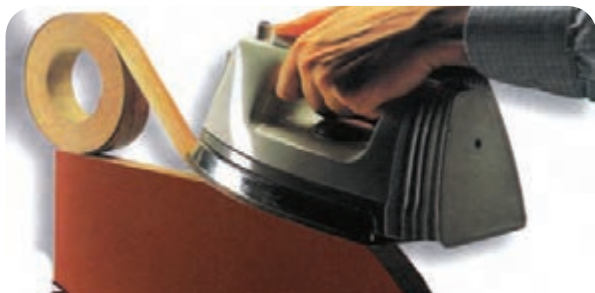
شکل ۴-۱۶ - نوار کردن لبه های قوس دار توسط اتو
