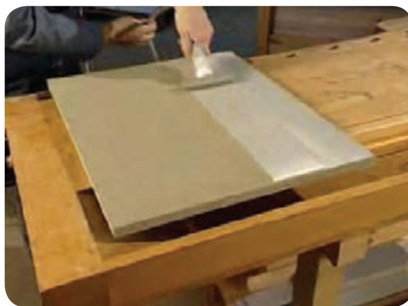
شکل ۹۳-۵- ابزار سرپهن چسب‌زن پنوماتیکی
