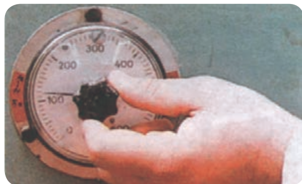
شکل ۷۹-۵ تنظیم فشارسنج پرس
