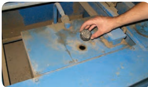
شکل ۸۸-۵- کنترل و تعویض روغن هیدرولیک مخزن
