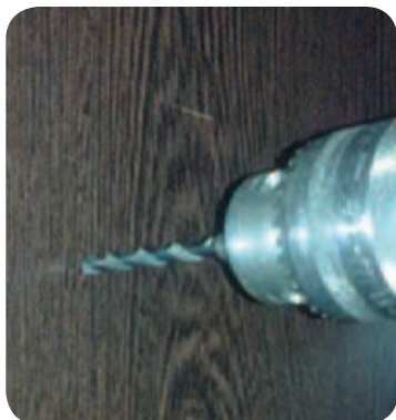
شکل ۱-۶- سوراخکاری دکور با مته چوب یا آهن
