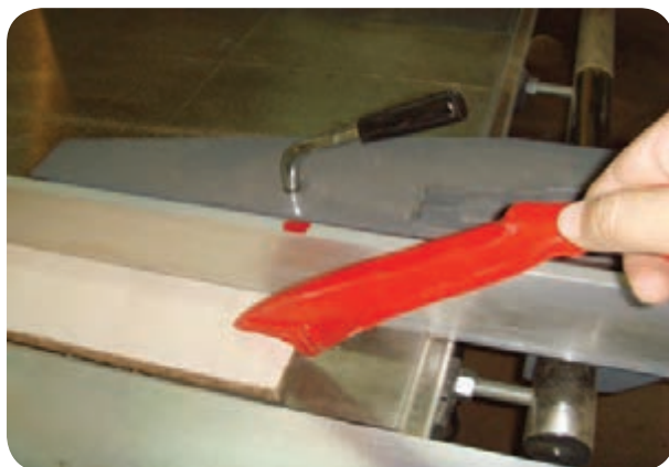
شکل ۵-۶۵- استفاده از وسیله کمکی هدایت قطعه باریک
