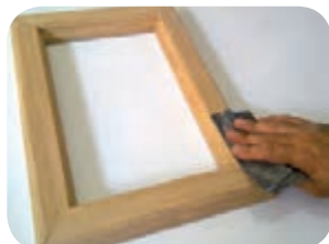
شکل ۲-۳۴- پرداخت قاب ساخته شده، بستن قاب توسط گیره قاب بندی
