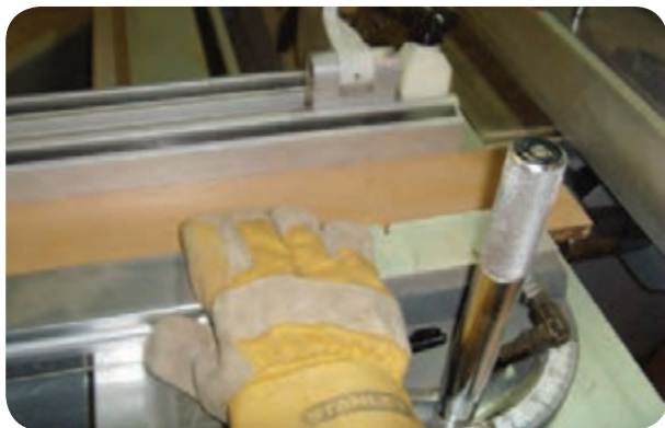
شکل ۵-۱۰۷- استفاده از گونیای کشویی میز متحرک ماشین ارّه پانل بر
