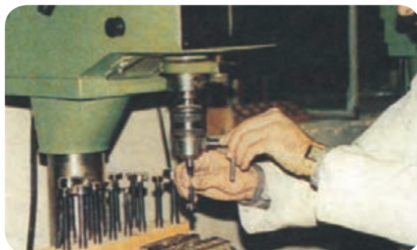
شکل ۵-۳۱- آچار سه نظام و گیره نگه داشتن قطعات کوچک در ماشین دریل ستونی
