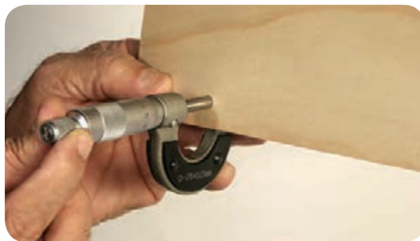
شکل ۷۲-۵ اندازه‌گیری ضخامت روکش با میکرومتر
