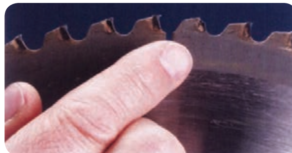
شکل ۴۲-۵ دندان‌های اره شکسته یا کُند شده
