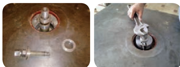
شکل ۲۸-۲- تنظیم کردن تویی در دستگاه فرز
