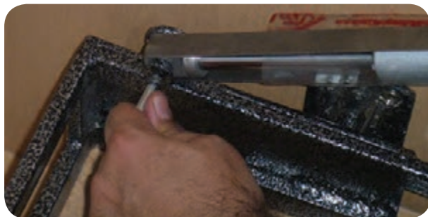
شکل ۵-۱۳۶ محکم کردن پایه‌های جک‌های تختخواب
