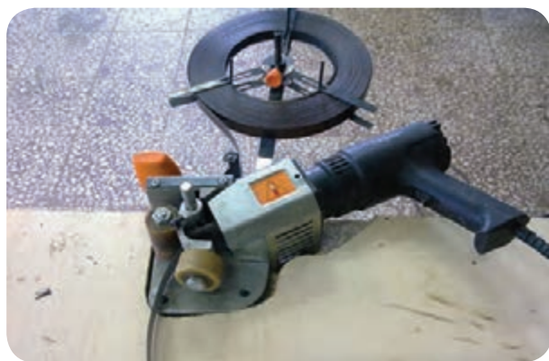
شکل ۴-۲۱ - نحوه استقرار سشوار روی میز
