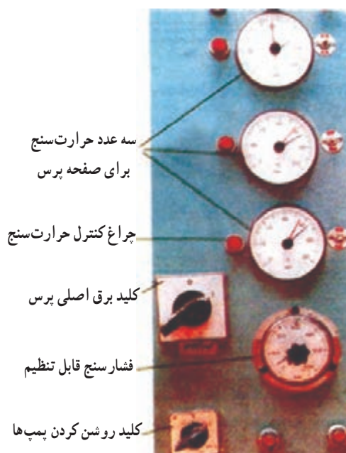
شکل ۸۷-۵- تنظیم اجزای پرس برای چسباندن روکش
