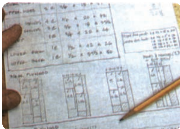
شکل ۵-۲۰- تهیه لیست چوب و خط‌کشی صفحات
