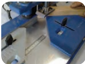
شکل ۲-۳۲- قطعات دم چلچله شده، ایجاد اتصال دم چلچله
