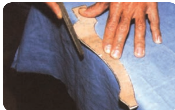
شکل ۵-۲۱ تهیه شابلن خط‌کشی برای ساخت پایه
