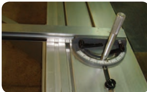
شکل ۵-۵۲- گونیای کوچک قابل تنظیم برای برشکاری
