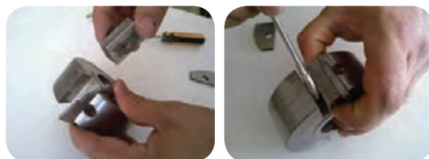
شکل ۲۷-۲- تنظیم و محکم کردن تیغه داخل تویی
