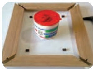
شکل ۲-۳۲- قطعات دم چلچله شده، ایجاد اتصال دم چلچله
