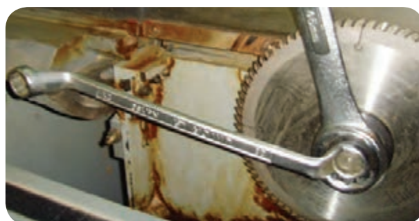
شکل ۵-۵۶- نحوه باز و بسته کردن تیغه اره
