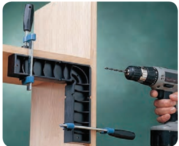
شکل ۱۷۰-۵- استفاده از شابلون برای جلوگیری از دوئیدگی
