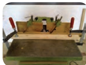
شکل ۲-۳۰- چوب ابزار خورده، ابزار زدن قطعه کار
