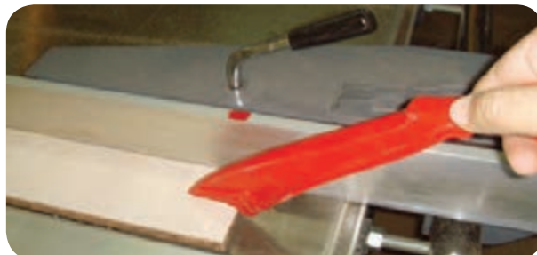
شکل ۵-۱۰۵- هدایت قطعه باریک به وسیله کمکی
