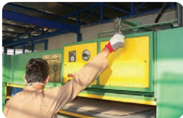
شکل ۹۵-۵- اهرم باز کردن صفحات پرس
