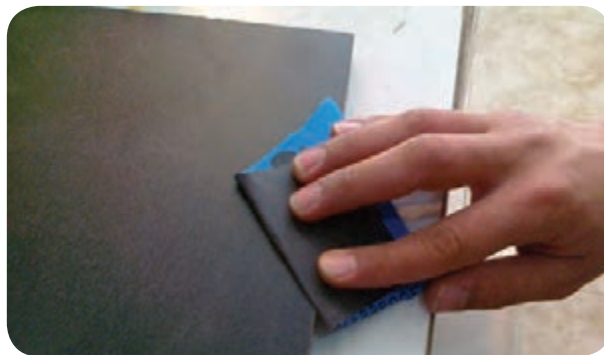
شکل ۴-۳۰ - پرداخت لبه لبه‌های نوار شده با سنباده
