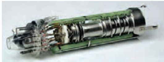
شکل ۱-۵ تفنگ الکترونی تلویزیون رنگی
