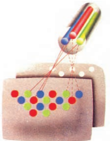
شکل ۲۰-۱ تفنگ الکترونی لامپ تصویر مثلثی ( \Delta )
