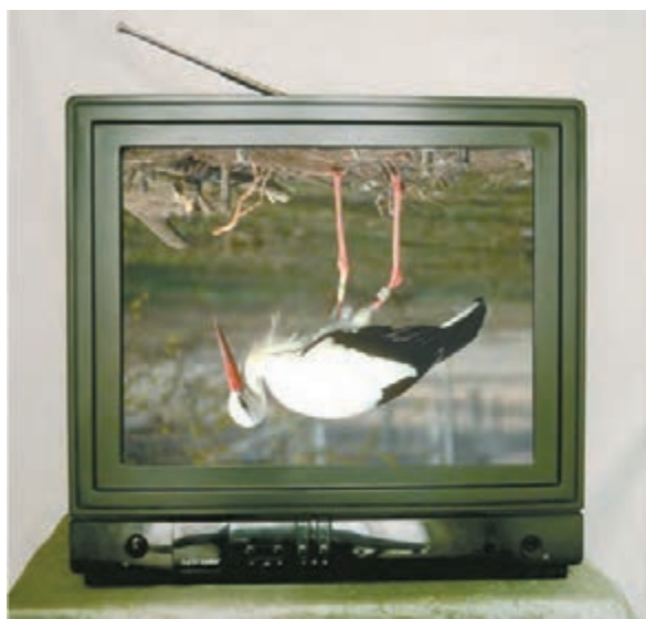
شکل ۲-۹۸- تصویر وارونه روی صفحه‌ی تلویزیون
