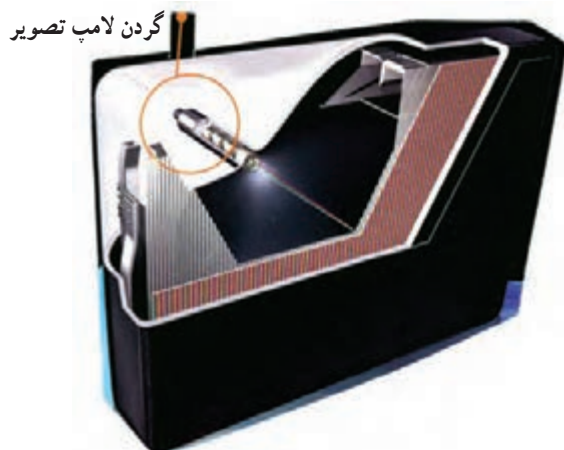
شکل ۱-۳ لامپ تصویر رنگی و گردن آن
