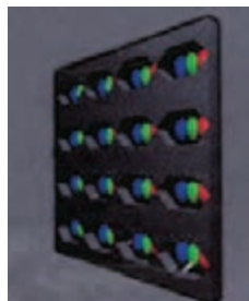
شکل ۱-۲۴- ماسک مشبک در مقیاس بزرگ تر
