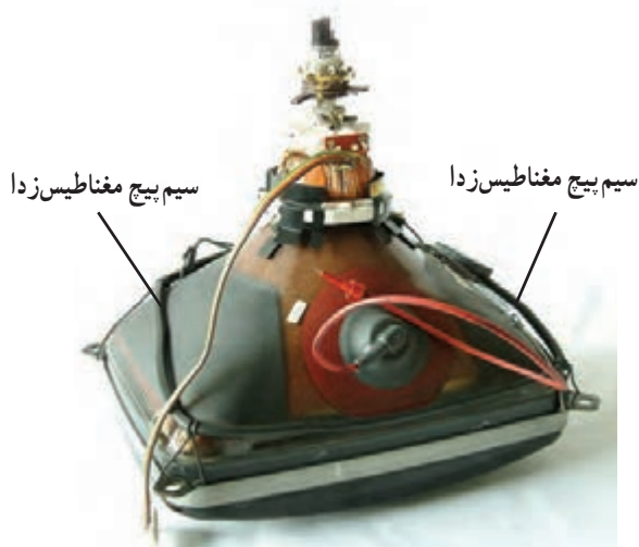
شکل ۱۰۵- مدار سیستم دگوسینگ در تلویزیون گروندیک
