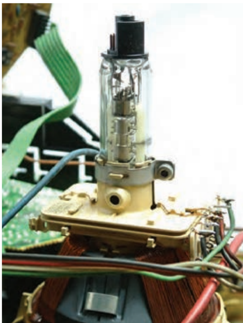
شکل ۱-۷۱-الف - شکل لامپ تصویر و پایه‌های آن
