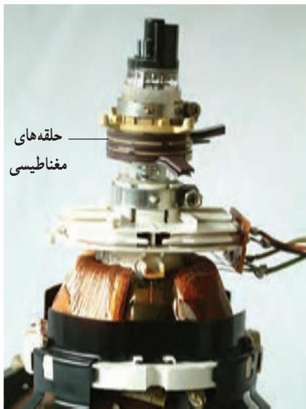
شکل ۹۸-۱ حلقه های مغناطیسی روی گردن لامپ
