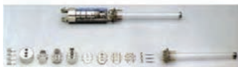
شکل ۱-۷ اجزای یک تفنگ الکترونی
