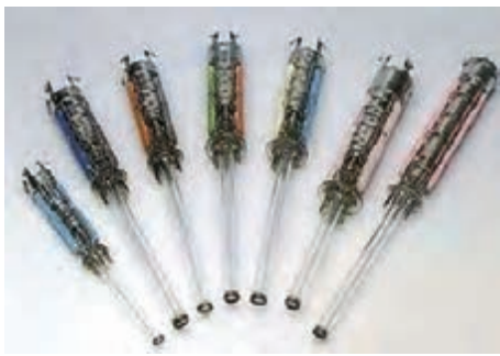
شکل ۱-۴ انواع تفنگ الکترونی
