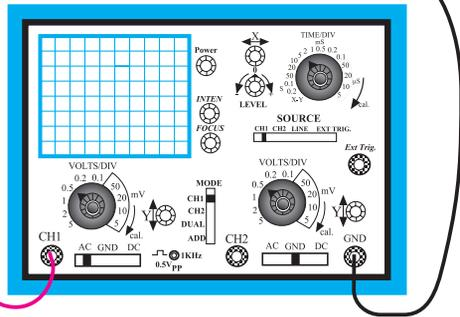
شکل ۱-۶۳- اتصال اسیلوسکوپ به پایه ۷ آی سی
