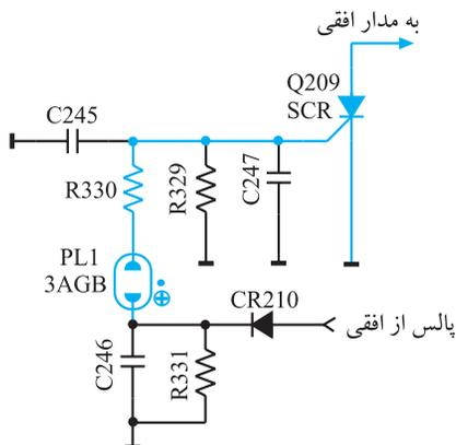
شکل ۱-۱۹۰ مدار کنترل ولتاژ زیاد
