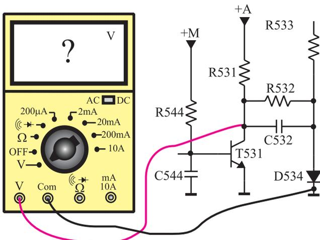
شکل ۱-۱۸۳- اتصال ولت‌متر به کلکتور امیتر T531
