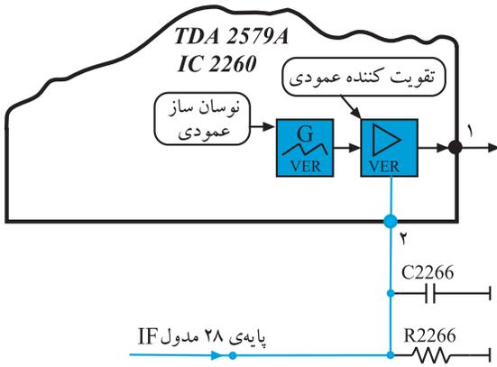
شکل ۲-۳۷ مسير فیدبک به پایه ی ۲ آی سی
