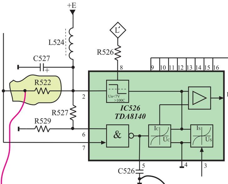
● چون سیگنال ایجاد شده توسط نوسان ساز افقی به طبقه ۵۲۶ درایور خروجی افقی یا آی سی ۵۲۶ اعمال می شود برای مشاهده ی نوسان های ایجاد شده توسط اسیلاتور افقی مطابق شکل ۱-۶۳ اسیلوسکوپ را به پایه ۷ آی سی ۵۲۶ یا یک سر مقاومت R522 اتصال دهید.
