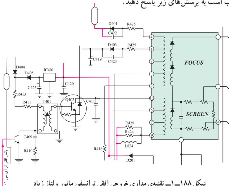
شکل ۱-۱۸۸- نقشه‌ی مداری خروجی افقی ترانسفورماتور ولتاژ زیاد
