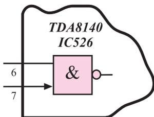
شکل ۱-۹۹- پایه های ۶ و ۷ آی سی
