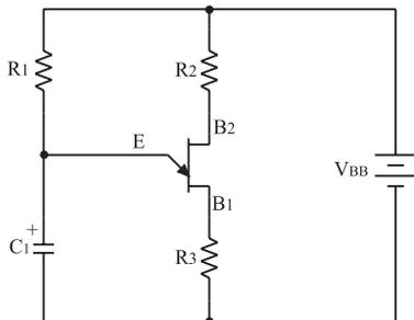
شکل ۱۱-۲ مدار یک نوسان ساز با UJT
