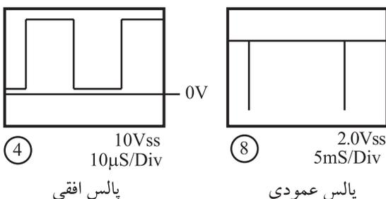
■ تولید سیگنال هایی با فرکانس ۱۵۶۲۵ هرتز برای بخش خروجی افقی و ۵۰ هرتز برای بخش خروجی عمودی. شکل ۱-۲۱ پالس های ایجاد شده توسط آی سی را نشان می دهد.
