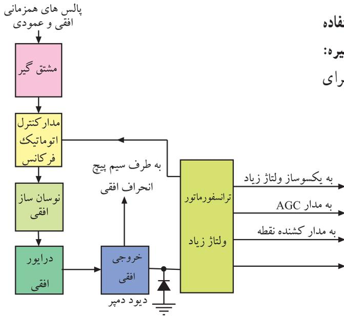
شکل ۱-۴- نقشه بلوکی تهیه سیگنال‌هایی از افقی
