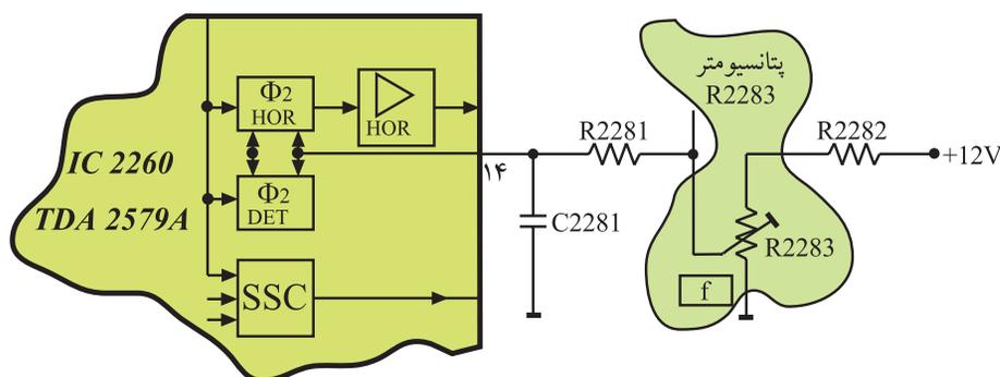
شکل ۱-۷۴ - پتانسیومتر تنظیم کننده‌ی فاز
