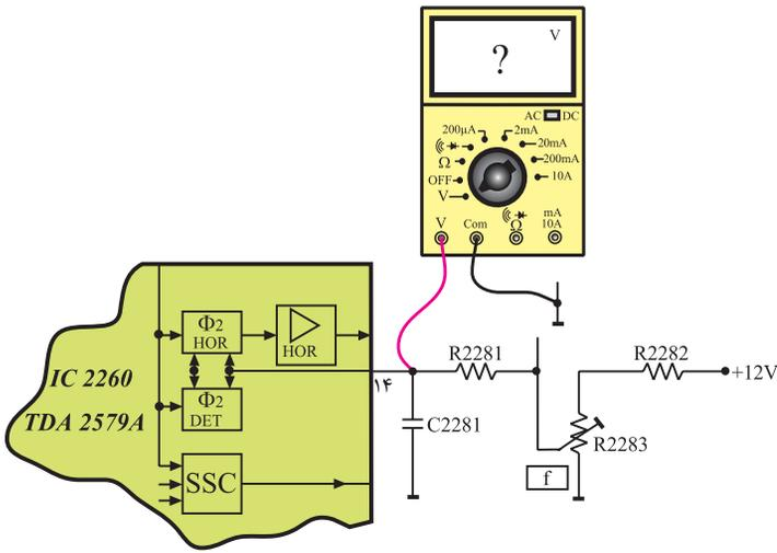
شکل ۱-۶۲- اتصال ولت متر به پایه ۱۴ آی سی
