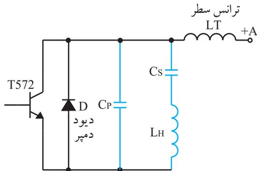
شکل ۱-۱۱۷- مدار معادل خروجی افقی
