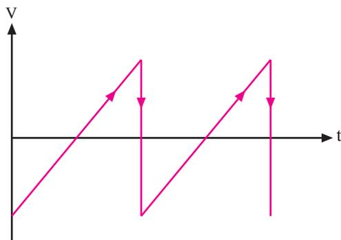
شکل ۱۳-۱- موج دنداناره تولید شده توسط نوسان ساز افقی
