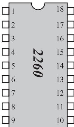
شکل ۱-۲۰- شماره پایه های آی سی ۲۲۶°
