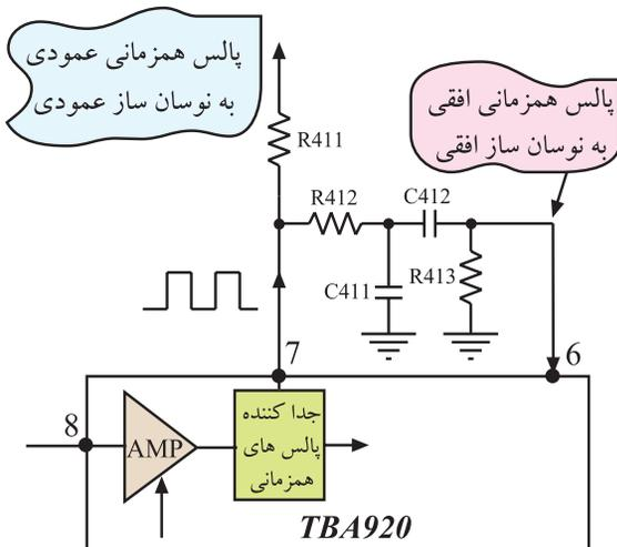
در مدار جدا کننده پالس همزمانی، پالس همزمانی از سیگنال مرکب تصویر جدا می شود و از طریق پایه ۷ آی سی به مدارهای نوسان ساز عمودی و نوسان ساز افقی اعمال می شود. شکل ۱۱-۱ مسیر خروج پالس همزمانی را از پایه ۷ آی سی نشان می دهد.
