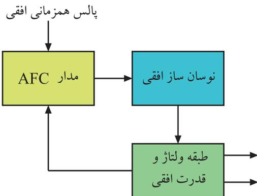
شکل ۱-۲۲- ارتباط نوسان ساز با مدار AFC
