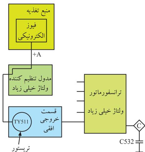
شکل ۱-۱۵۸- ارتباط فیوز الکترونیکی و ترانسفورماتور ولتاژ زیاد
