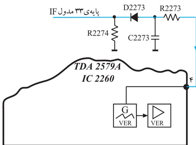
شکل ۲-۴۲- فیدبک به پایه ۴ آی سی
