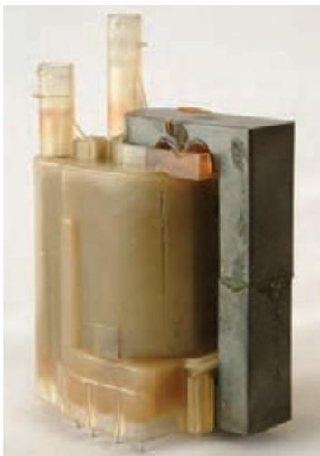
شکل ۱-۱۱۱- ترانسفورماتور ولتاژ زیاد
