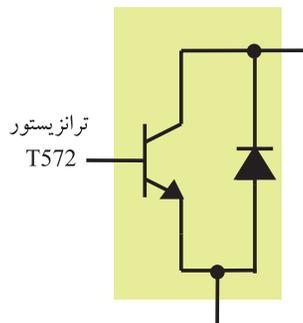
شکل ۱-۱۰۷- ترانزیستور T572 همراه با دیود دمپر
