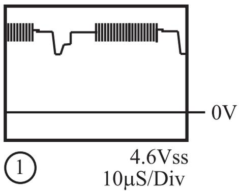
شکل ۲-۴۴- موج پایه ۵ آی سی
