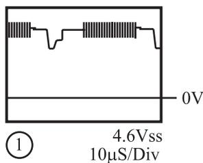
شکل ۱-۳۴- شکل موج ورودی پایه ۵ آی سی
