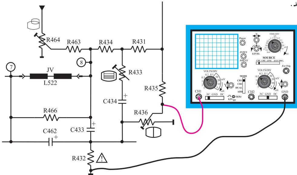
شکل ۱۰۶-۲- اتصال اسکوپ به سر متغیر مقاومت R۴۳۶
