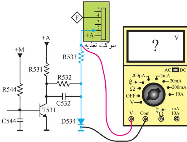
شکل ۱-۱۸۴- اتصال ولت متر به مقاومت R533
