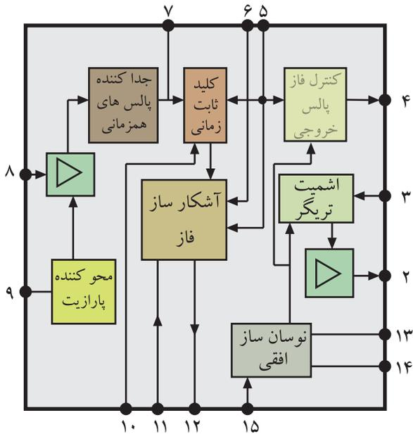
شکل ۱-۷- نقشه بلوکی مدارهای داخل آی‌سی TBA۹۲۰
