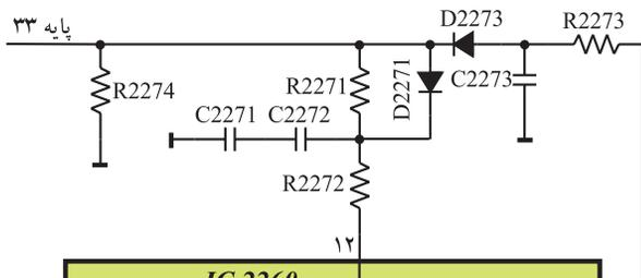
پایه ۱۲: به پایه ۱۲ آی سی نمونه‌ای از پالس خروجی افقی فیدبک می‌شود. این فیدبک در مدار آشکارساز فاز افقی و مدار تهیه‌ی پالس‌های ترکیبی افقی و عمودی (SSC) به کار می‌رود. شکل ۱-۴۱ قطعات موجود در مسیر پایه ۱۲ را نشان می‌دهد.
