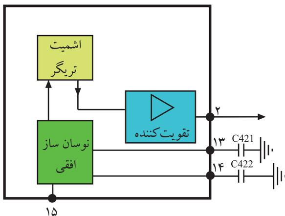
شکل ۱۴-۱- بلوک دیاگرام نوسان ساز و اشمیت تریگر
