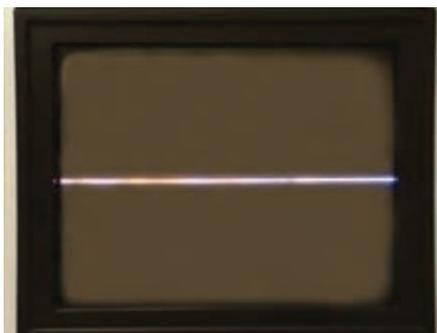
شکل ۲-۴۰ نوسان ساز عمودی از کار افتاده است.
