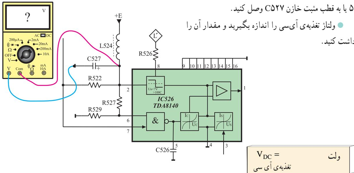
شکل ۱-۱۶۹- اتصال ولت‌متر به پایه ۲ آی‌سی
