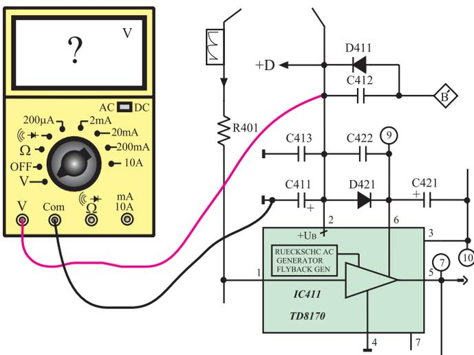
شکل ۲-۹۴- اتصال ولت‌متر برای اندازه‌گیری ولتاژ +D
