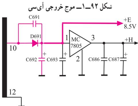
شکل ۱-۹۳- مدار تهیه‌ی ولتاژ +E تغذیه‌ی آی‌سی
