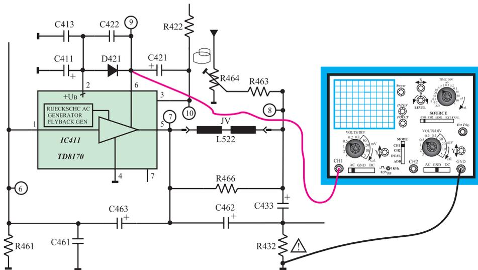
شکل ۱-۲- اتصال اسکوپ به پایه‌ی ۶ آی‌سی ۴۱۱
