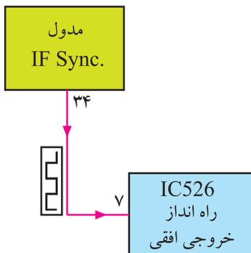
شکل ۴۰-۱ اتصال پایه‌ی ۳۴ مدول IF به پایه‌ی ۷ آی‌سی ۵۲۶
