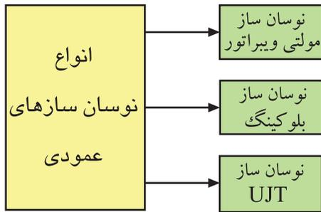
شکل ۲-۴- انواع نوسان ساز عمودی
