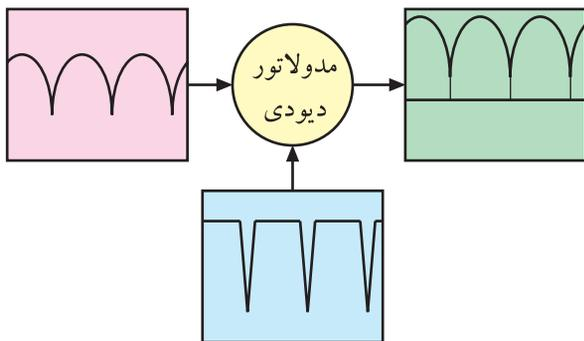
شکل ۲-۸۳- موج‌های ورودی و خروجی مدولاتور دیودی
