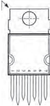
شکل ۲-۴۸- پایه‌های آی‌سی ۴۱۱
