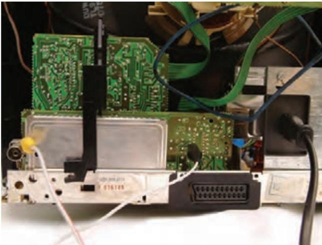
شکل ۱-۶۸- پایه ۵ آی سی ۲۲۶۰ به شاسی اتصال کوتاه شده است.
