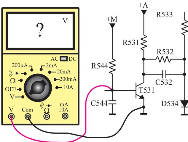
شکل ۱-۱۸۲- اتصال ولت‌متر به بیس‌امیتر ترانزیستور T531
