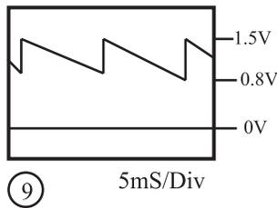
شکل ۱-۳۰- شکل موج پایه‌ی شماره‌ی ۲ آی‌سی
