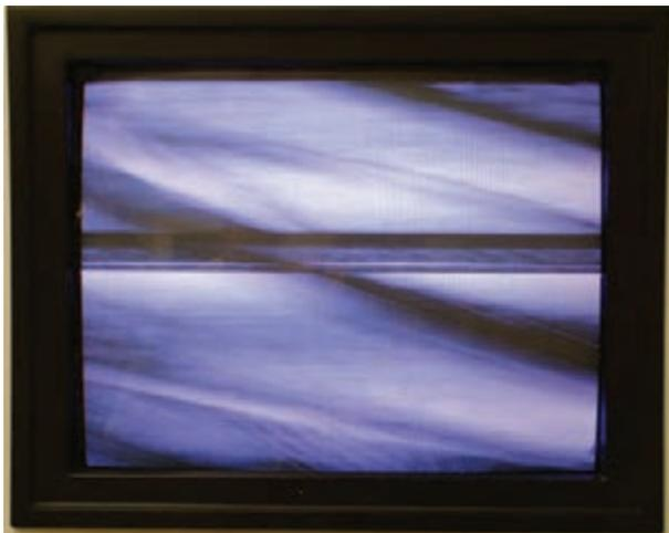
شکل ۴۹-۱- عدم تنظیم فرکانس نوسان ساز افقی
