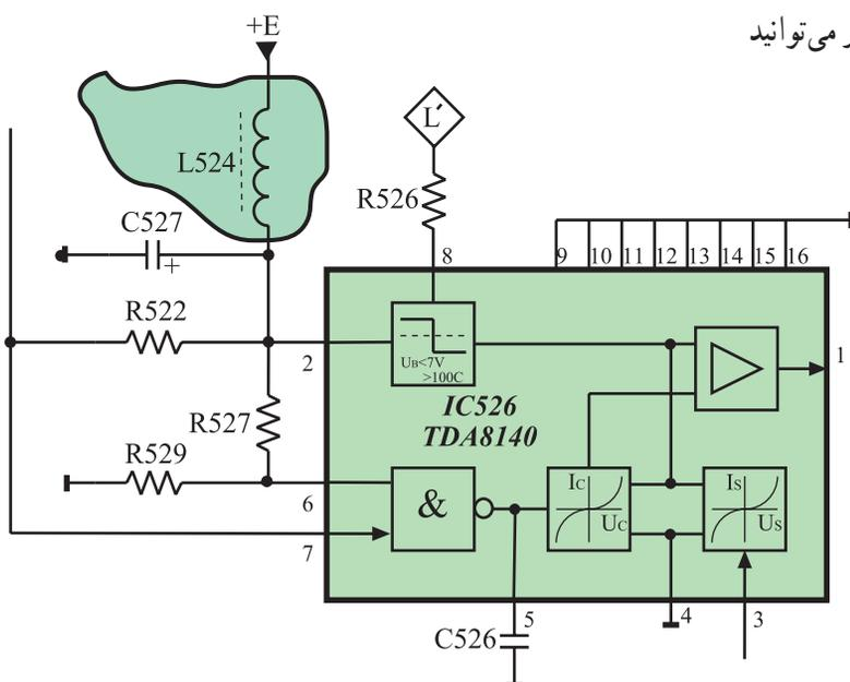
شکل ۱-۱۷۰- جای سیم‌پیچ L524 در نقشه‌ی مدار
