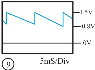
شکل ۲-۳۸ موج برگشتی به پایه ی ۲ آی سی
