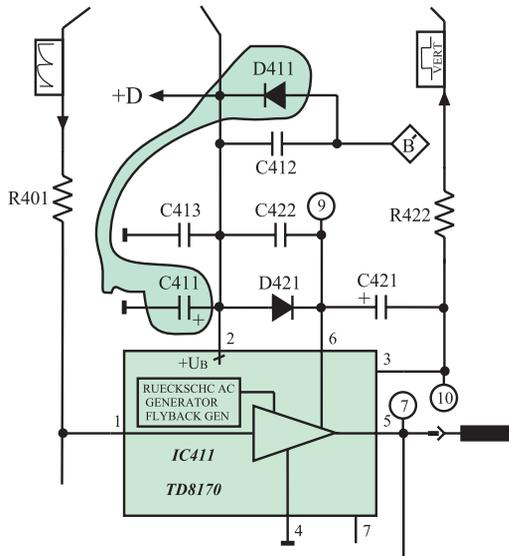
شکل ۲-۵۹- یک سوساز و صافی ولتاژ +D
