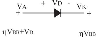
شکل ۱۰-۲ ولتاژهای کاتد و آند دیود نسبت به سیم مشترک در هنگام وصل دیود
