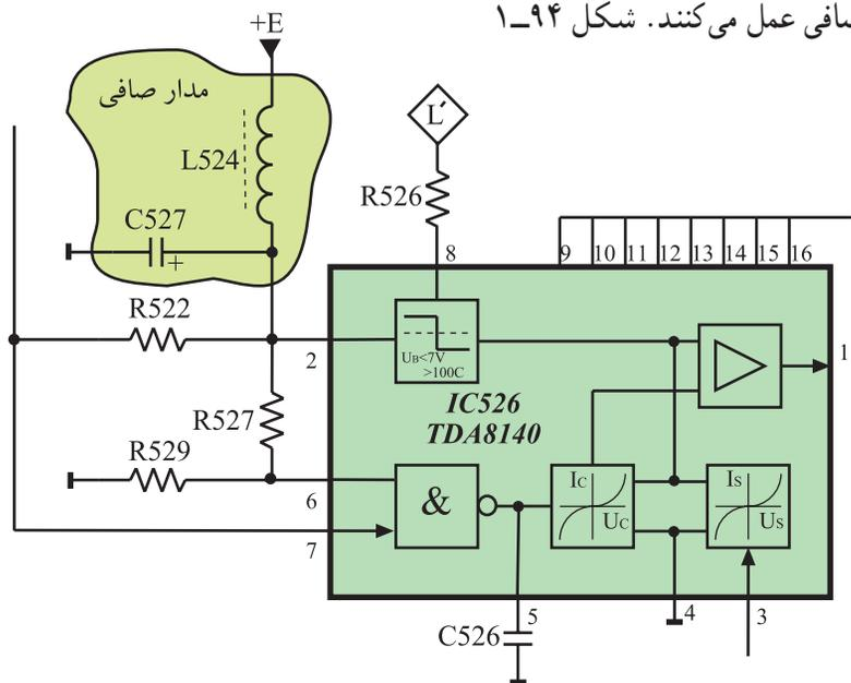
شکل ۱-۹۴ - صافی در مسیر ولتاژ +E
