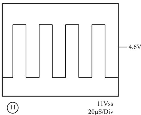
شکل ۱-۹۸- شکل موج ورودی به پایه ۷ آی سی
