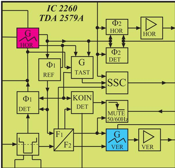
شکل ۱-۱۸- بلوک دیاگرام داخلی آی سی ۲۲۶°
