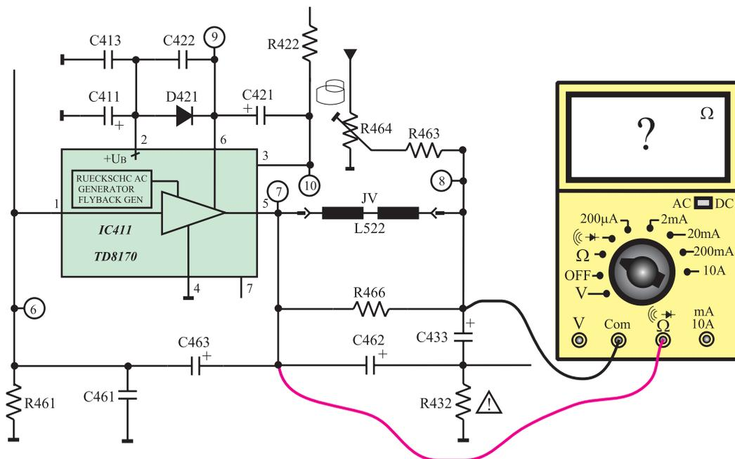
شکل ۳-۱۰-۲- اتصال اهم‌متر به دو سر سیم‌پیچ انحراف عمودی
