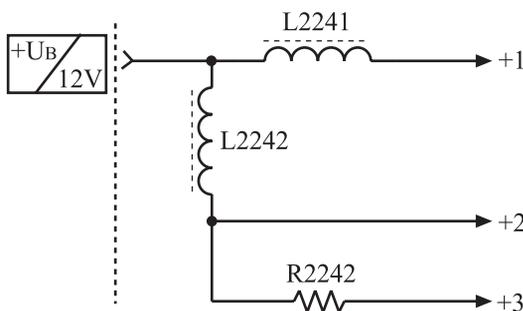
شکل ۵۰-۱- سه ولتاژ به نام های +۱ و +۲ و +۳ از ولتاژ +B که برابر ۱۲ ولت است فراهم می شود.
