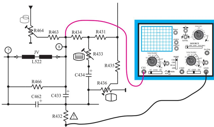
شکل ۱۱۲-۲ اتصال اسکوپ به یک سر مقاومت R۴۶۳
