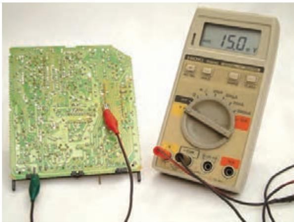
شکل ۱-۵۹- اتصال غیر صحیح مولتی‌متر به پایه‌ی آی‌سی
