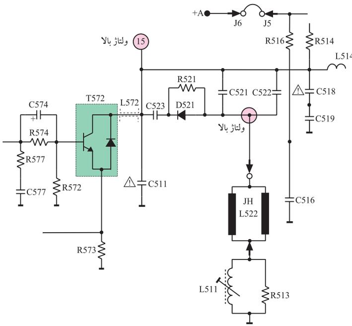
شکل ۱-۱۶۶- بعضی نقاط ولتاژ بالا در خروجی افقی
