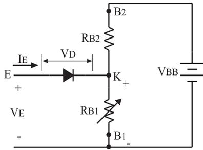
شکل ۹-۲ اتصال ولتاژ به پایه های UJT
