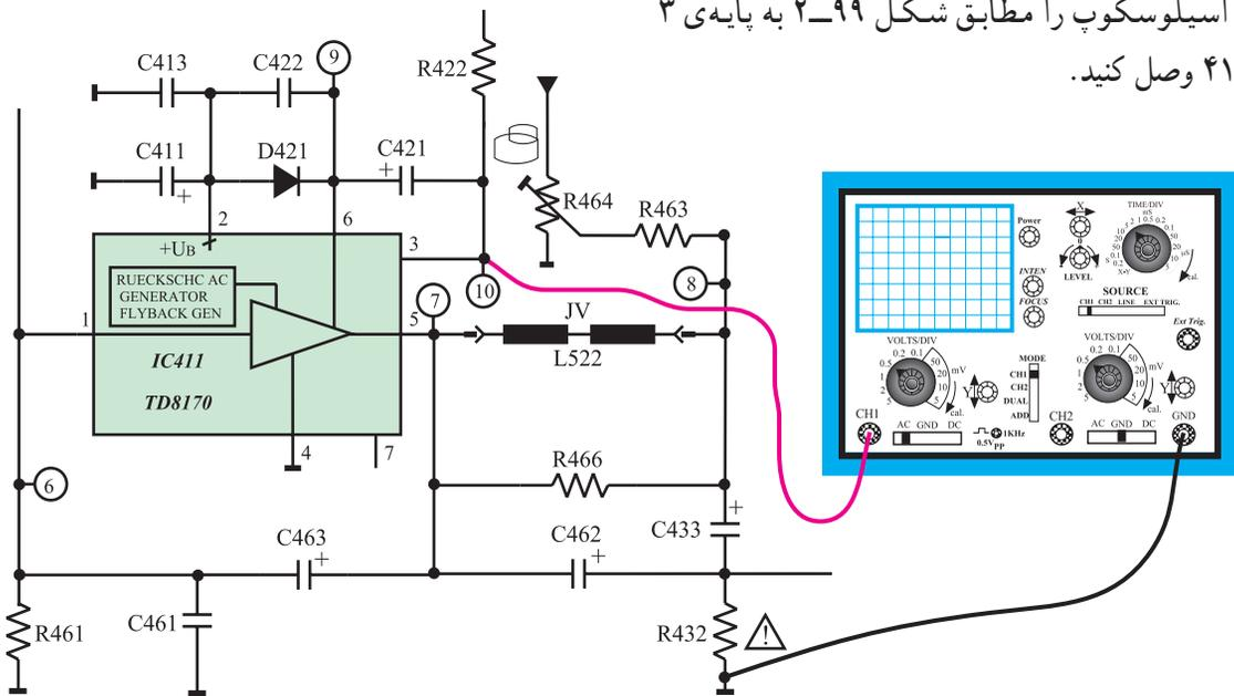
شکل ۹۹-۲- اتصال به پایه ۳ آی سی ۴۱۱
