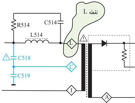
شکل ۱-۱۰۱- تهیهی ولتاژ  $L'$  از ترانس سطر
