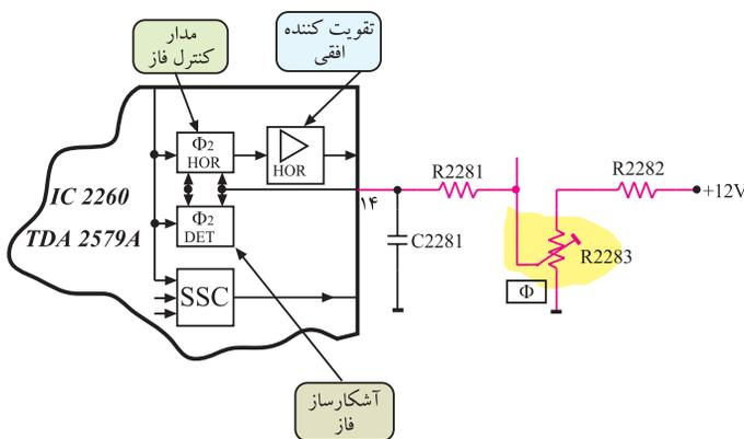
پایه ۱۴: از این پایه برای کنترل و تنظیم فاز پالس های افقی استفاده می شود. به بلوک کنترل کننده فاز داخل آی سی، مطابق شکل ۱-۴۷ و به وسیله مقاومت R۲۲۸۲ و پتانسیومتر R۲۲۸۳ و مقاومت R۲۲۸۱ ولتاژی DC اعمال می شود. با تغییر پتانسیومتر، مقدار ولتاژ تغییر می کند و فاز موج اصلاح می شود.
