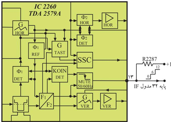
پایه ۱۳: پایه ۱۳، خروجی پالس انطباق (Koin) است. همان طور که در مبحث واحد کنترل توضیح داده شد، در شرایط متفاوت از این پایه سه سطح ولتاژ خارج می شود. شکل ۱-۴۵ پایه ۱۳ و سطوح ولتاژ خارج شده از آن را نشان می دهد. همچنین از طریق این پایه طبق شکل ۱-۴۶، به پایه ۲ آی سی TBA۱۲۱ فرمان داده می شود. با این فرمان در هنگام عدم پخش برنامه، فرمان سکوت (Mute) صادر می شود که مدار تقویت کننده IF صدا را قطع می کند و به این ترتیب هیچ صدایی از بلندگو شنیده نمی شود.
