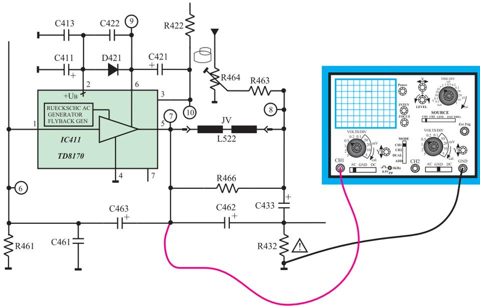
شکل ۹۷-۲- اتصال اسکوپ به خروجی آی سی ۴۱۱
