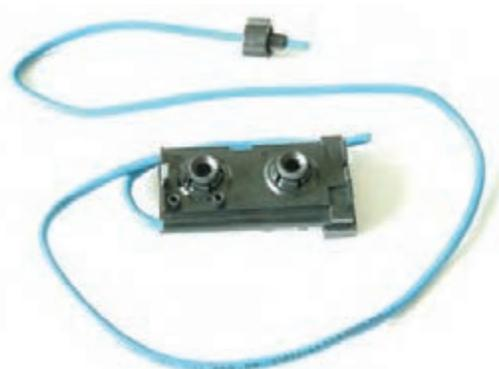
شکل ۱-۱۴۲- شکل ظاهری پتانسیومتر
