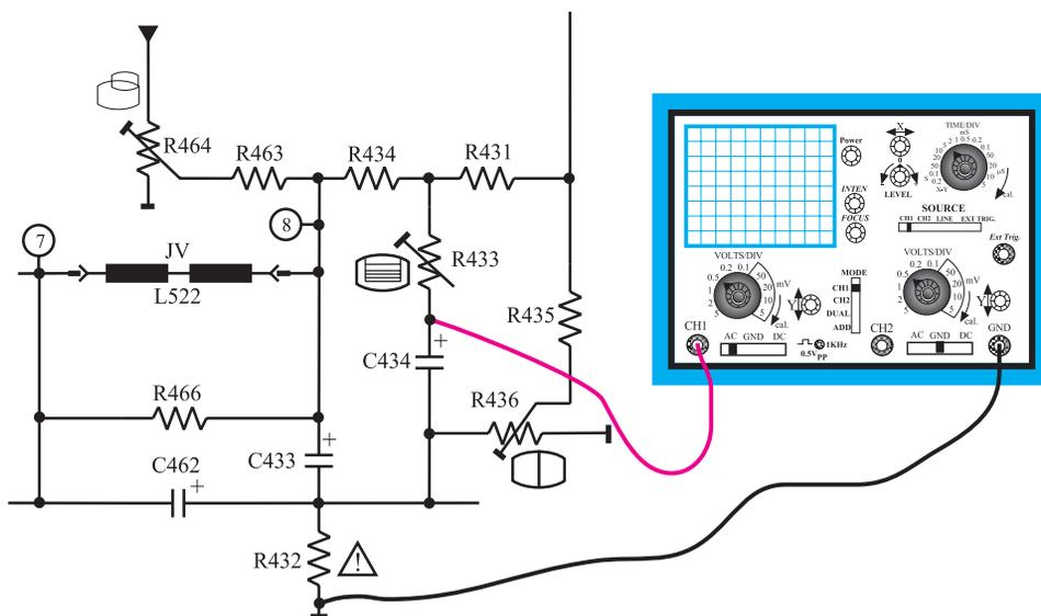
شکل ۲-۱۰۸- اتصال اسکوپ به جوشن مثبت خازن C۴۳۴
