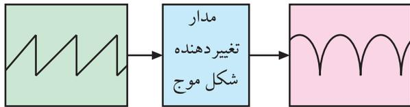
شکل ۲-۸۱- موج ورودی و خروجی تغییردهنده‌ی شکل موج
