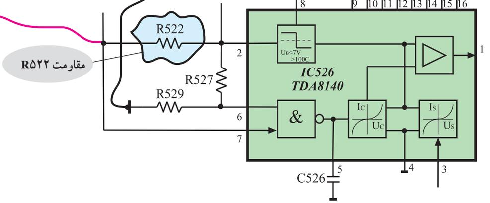
شکل ۱۷۱-۱- اتصال اسیلوسکوپ به پایه ۷ آی سی
