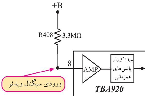
سیگنال مرکب تصویر از مسیر داخلی آی سی وارد تقویت کننده می شود و پس از تقویت به جدا کننده پالس همزمانی راه می یابد. مقاومت  $R408$ ، بایاس تقویت کننده را تأمین می کند. شکل ۱۰-۱ بلوک تقویت کننده و جدا کننده پالس همزمانی را در داخل آی سی نشان می دهد.
