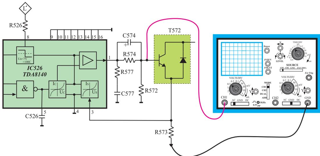
شکل ۱۷۵-۱- اتصال اسیلوسکوپ به بیس ترانزیستور T572
