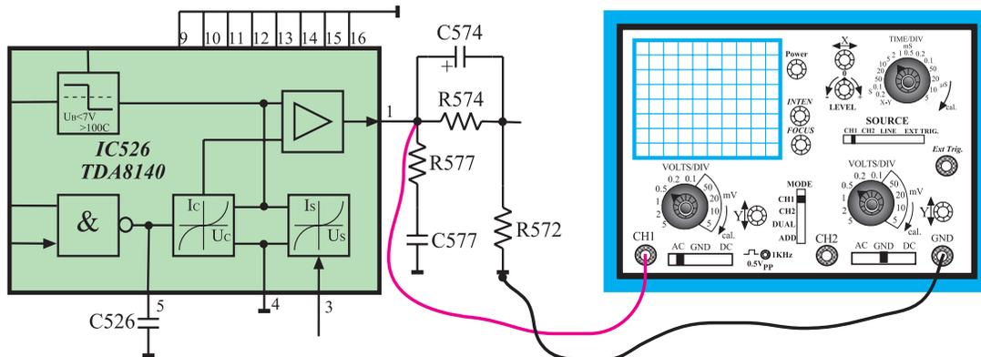
شکل ۱-۱۷۳ - اتصال اسیلوسکوپ به خروجی آی سی ۵۲۶
