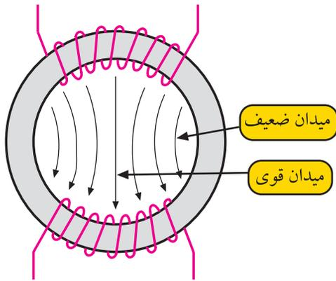
شکل ۷۳-۲- توزیع خطوط نیرو بین دو قطب مغناطیسی سیم بیج‌های انحراف افقی
