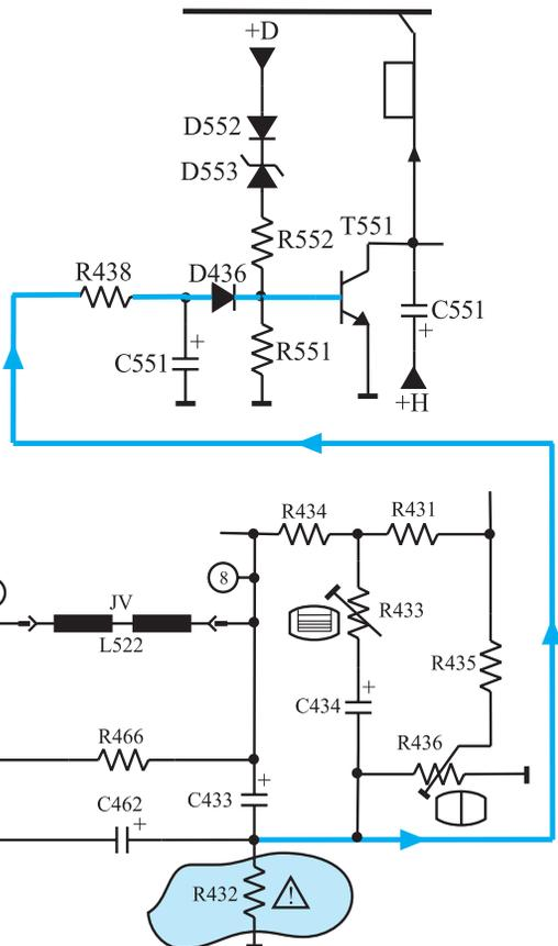
شکل ۲-۶۶ مسیر اتصال ولتاژ دو سر مقاومت R432 به ترانزیستور محافظ لامپ تصویر
