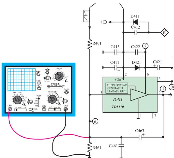
شکل ۹۵-۲- اتصال اسکوپ به ورودی آی سی ۴۱۱
