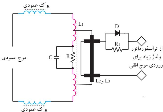
شکل ۲-۸۶- سیم پیچ انحراف عمودی همراه با مدار جبران‌کننده‌ی اختلال بالشتکی بالا و پایین
