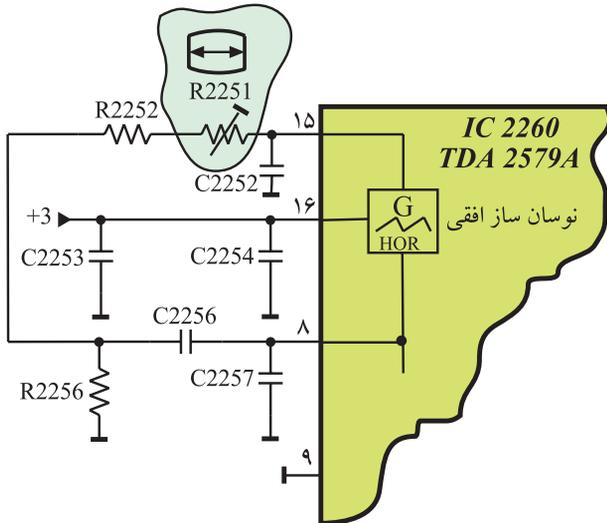
شکل ۴۸-۱- قطعات نوسان ساز در پایه ۱۵
