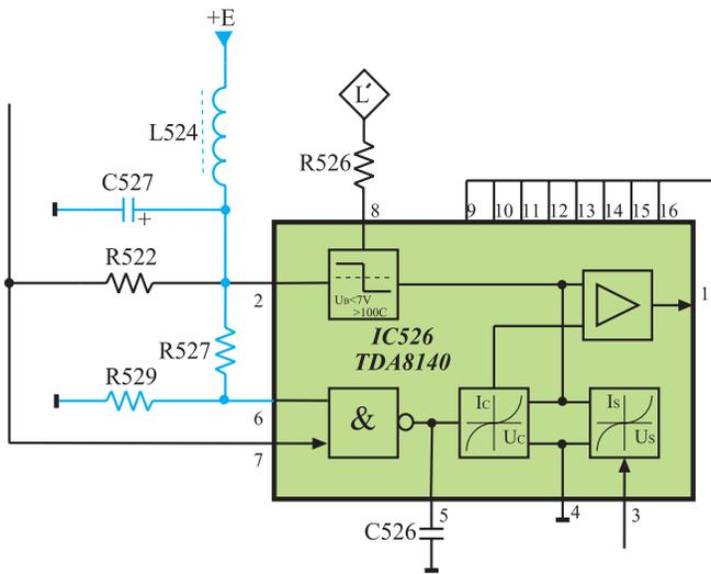
شکل ۱-۹۷- مدار تهیه ولتاژ برای پایه ۶ آی سی
