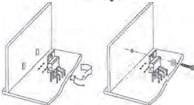
شکل ۲-۴۷ شکل ظاهری و نحوه ی نصب آی سی روی گرماگیر ۸۳
