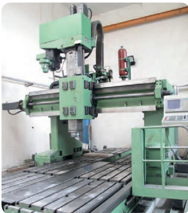
نمونه‌ای از یک دستگاه فرز CNC
