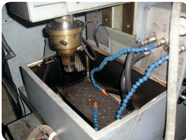
نمونه‌ای از ماشین CNC EDM
