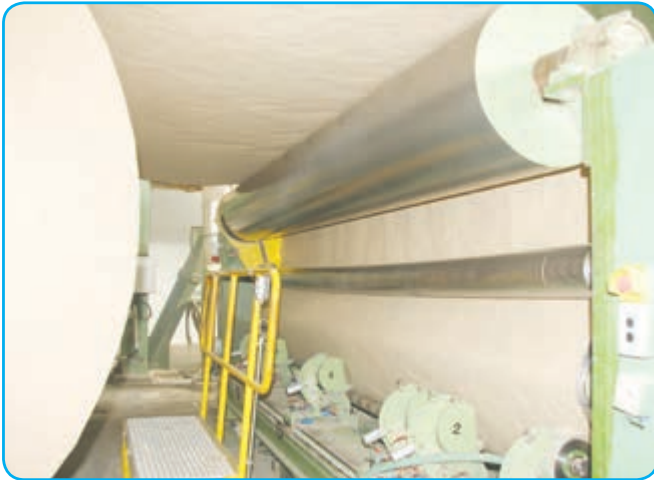
غلتک آهنی برای صاف کردن خمیر کاغذ
