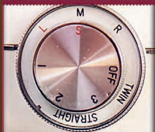
تنظیم کننده جهت میل سوزن
