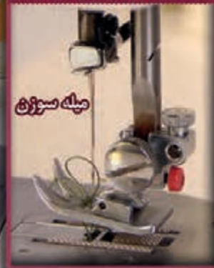
میله نگهدارنده سوزن
