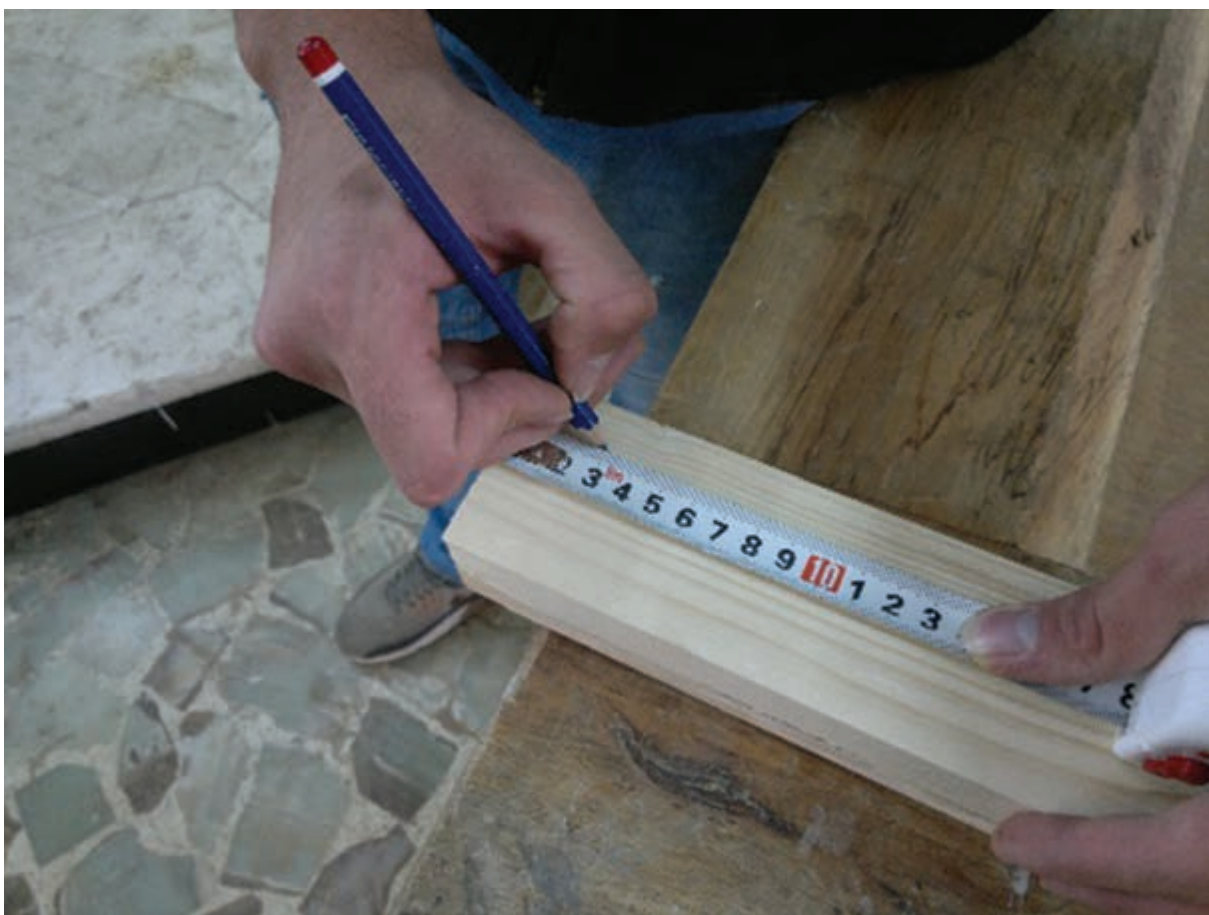
اندازه‌گیری و اندازه‌گذاری صحیح قطعه کار
