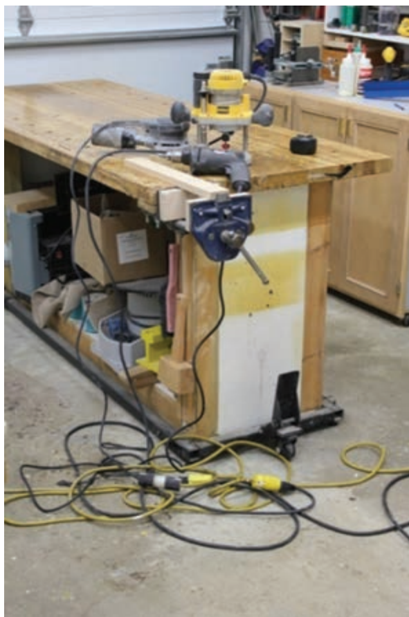
استفاده از پریز زمینی (نامنظم بودن سیم‌ها)
