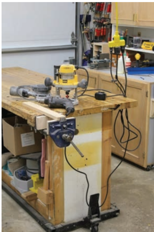
استفاده از پریز سقفی (منظم بودن سیم‌ها)
