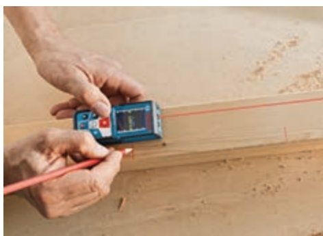
اندازه‌گیری با متر لیزری
