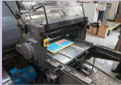
تصویر ۱۰ نصب قالب روی ماشین لترپرس
