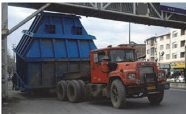
شکل ۱۹- مسیر نامناسب حمل بار ترافیکی
