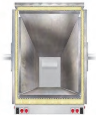
شکل ۷- اتاق عایق‌بندی شده
