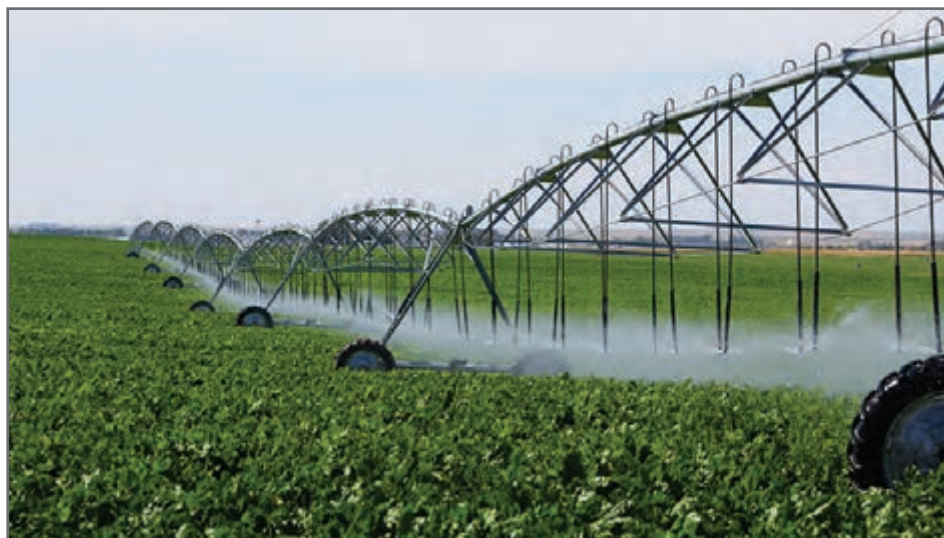
شکل ۱۶- سیستم آبیاری بارانی چرخ دوار (ویل موو)
