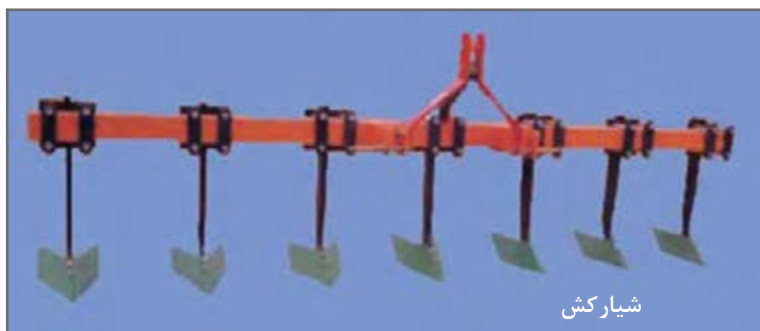
شکل ۳۰- انواع شیارکش (فاروئر)
