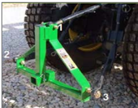
شکل ۸- نقاط اتصال سه‌گانه تراکتور
