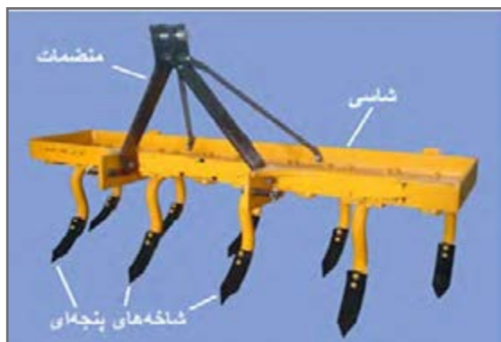
شکل ۱۰- کولتیواتور شاخه‌ای
