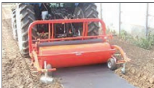
شکل ۳۵- دستگاه مالچ‌کش
