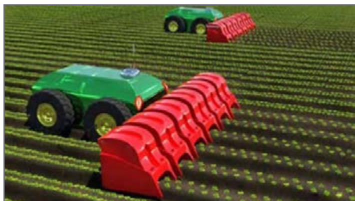
شکل ۱۷- ماشین تنک‌کننده کاهو
