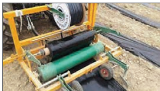
شکل ۳۵- دستگاه مالچ‌کش
