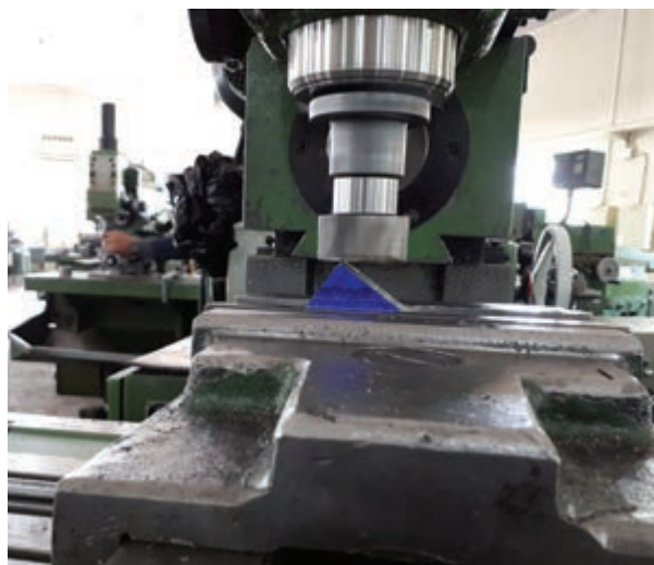
شکل ۱۸- خط کشی و بستن قطعه در گیره
