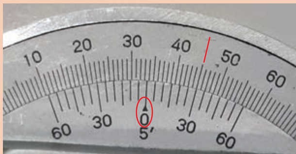
شکل ۱۲- اندازه تنظیمی با زاویه‌سنج
