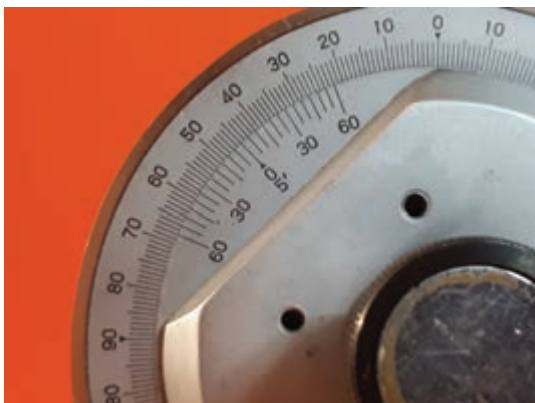
شکل ۴۴- کنترل زاویه قطعه شماره ۲ با زاویه سنج ۵ دقیقه
