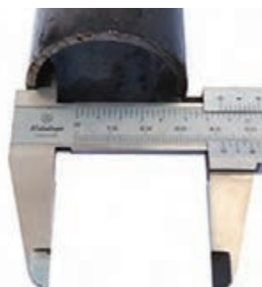
شکل ۴۸ - شاخک‌های داخل‌سنج کولیس
