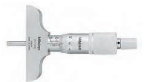
شکل ۵۳ - میکرومتر عمق‌سنج
