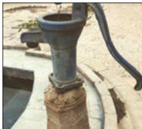
شکل ۲- تلمبه آب (سیلندر پیستونی قدیمی)
