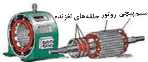
شکل ۴ - الکترو موتور با روتور سیم‌پیچی
