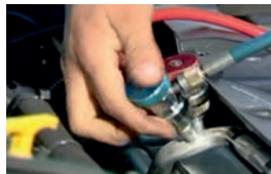
گاز کولر با دستگاه تخلیه شود.
