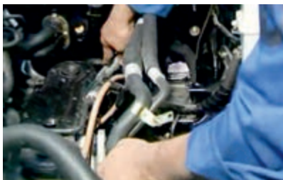
شیلنگ‌های بخاری و تهویه مطبوع جدا شوند.
