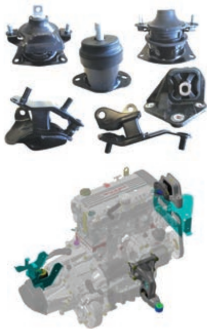
شکل ۹-۶- محل بستن دسته‌موتور
