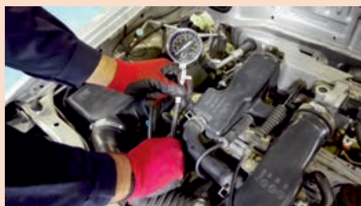
۳- دستگاه کمپرس سنج جایگزین شمع سیلندر شود.
