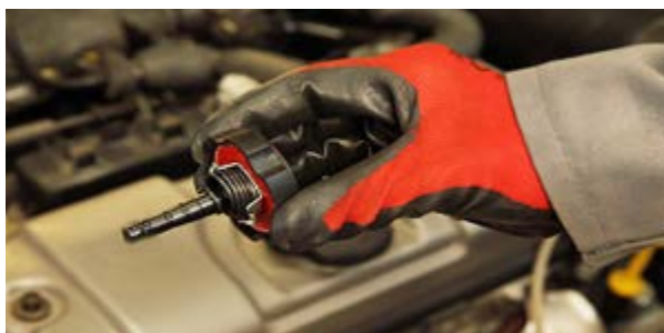
شکل ۵-۷- شاخص‌های روی درپوش مخزن مایع هیدرولیک فرمان
