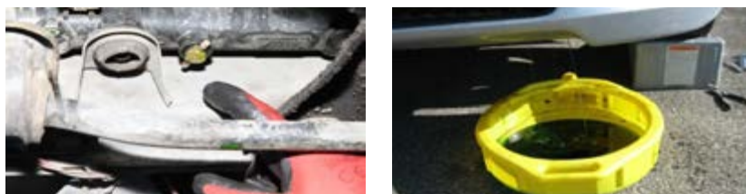
شکل ۷-۲۹- تخلیه مایع خنک کننده موتور به روش دستی
