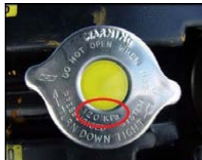
شکل ۷-۲۵- محل نوشته شدن فشار کارکرد روی در چند رادیاتور
