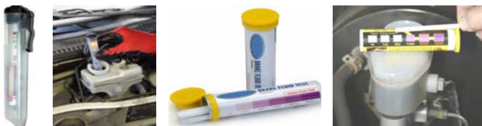
شکل ۶-۶- آزمایش کیفیت مایع هیدرولیک ترمز
