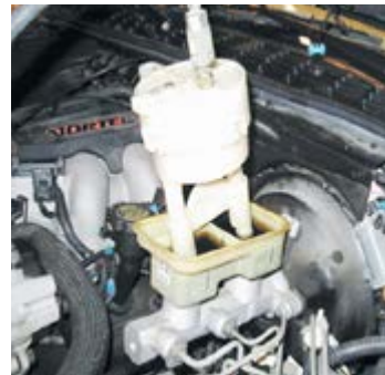
شکل ۱۴-۶- عوض کردن و هواگیری سیستم هیدرولیک ترمز با دستگاه تزریق تحت فشار
