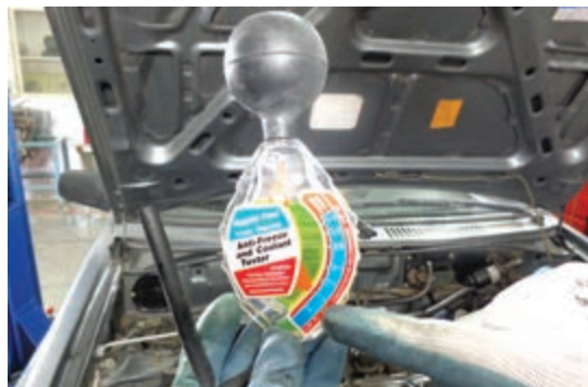
شکل ۷-۸- روش استفاده از هیدرومتر
