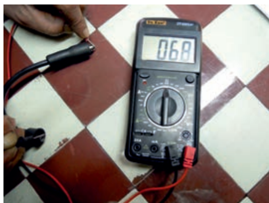
شکل ۳۸-۸- آزمایش اهمی وایر شمع
