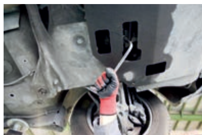
۱ پیچ تخلیه روغن بسته شود.
