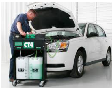
شکل ۲۷-۷- روش های تخلیه مایع خنک کننده
