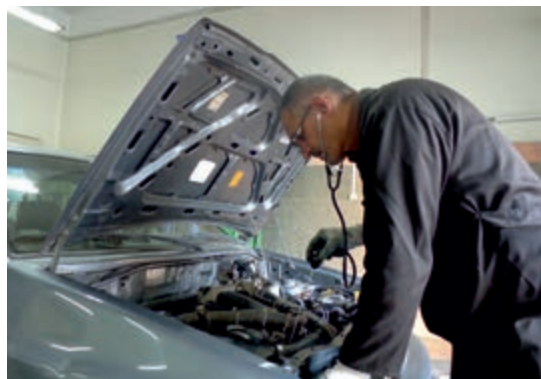
روش استفاده از استاتسکوپ
