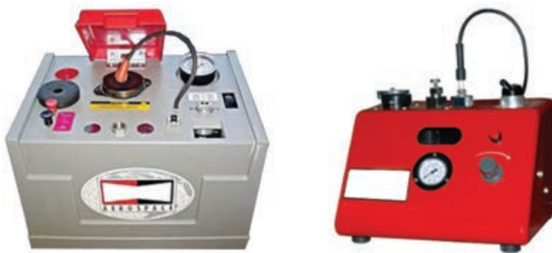
شکل ۳۷-۸- دستگاه شمع پاک‌کن با توانایی آزمایش شمع
