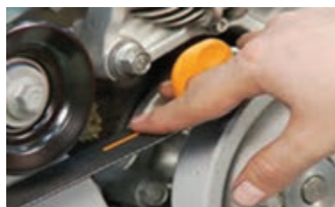
شکل ۲-۱۴- گوشه مکانیکی (استاتسکوپ) و ابزار بررسی فاصله تسمه و شیار پولی
