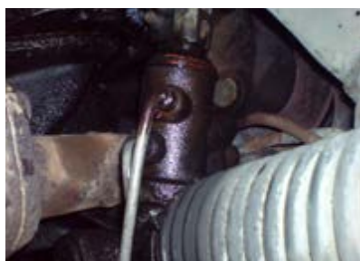
۲ نشتی شیر هیدرولیک فرمان (تقسیم‌کننده) بررسی شود.
