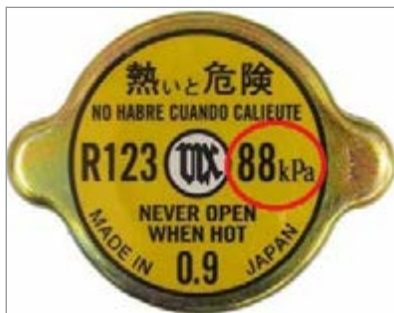
شکل ۷-۲۵- محل نوشته شدن فشار کارکرد روی در چند رادیاتور
