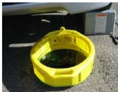
شکل ۲۷-۷- روش های تخلیه مایع خنک کننده
