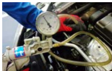
۳ با دستگاه پمپ دستی فشاری حدود ۱۶۵-۱۸۵kpa ایجاد شود.
