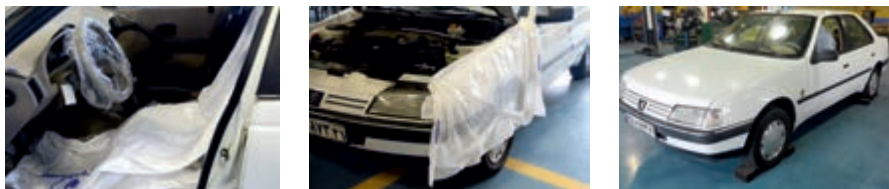
شکل ۹-۲- آماده‌سازی خودرو برای باز کردن موتور
