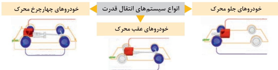
شکل ۱-۲۰- اجزای اصلی سیستم انتقال قدرت
