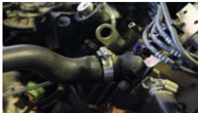
۴ اطراف محفظه ترموستات بررسی شود.
