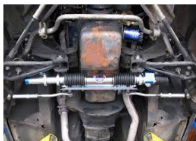
۳ پس از قرار گرفتن خودرو روی جک بالابر، از زیر خودرو مدار هیدرولیک فرمان بررسی شود.
