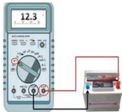
شکل ۱۱-۷ اندازه‌گیری ولتاژ
