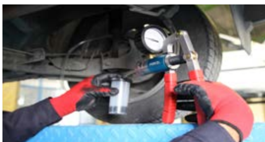
شکل ۶-۱۲- نمونه‌ای از دستگاه خلأیی هواگیری سیستم ترمز
