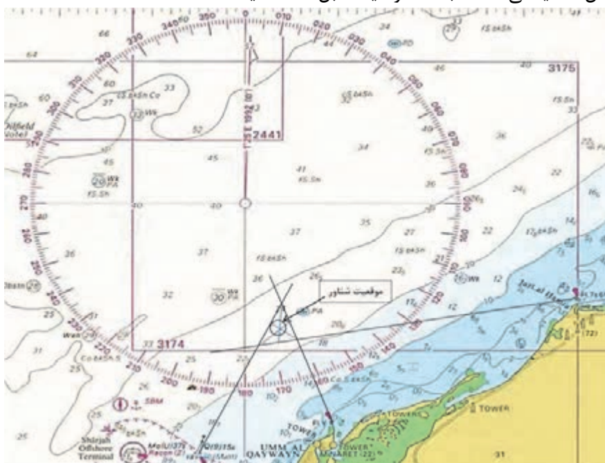
شکل ۶- تعیین موقعیت با استفاده از سه سمت
