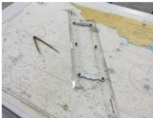
شکل ۱۲- ناوبری تخمینی روی نقشه
