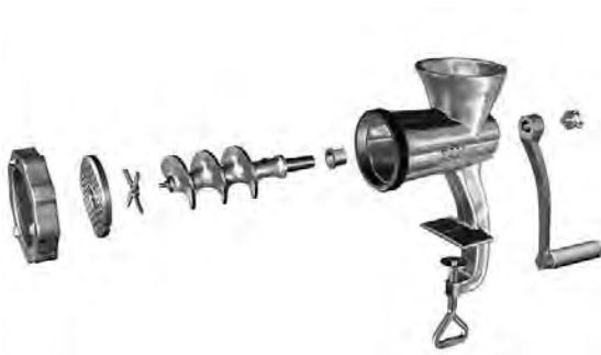
شکل ۶۷- تصویر سه بعدی انفجاری چرخ‌گوشت دستی
