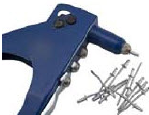
شکل ۳-۳۰ انتخاب درست میخ پرچ در دستگاه پرچ
