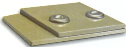
شکل ۳-۲۳ نحوه انتخاب صحیح اتصال میخ پرچ
