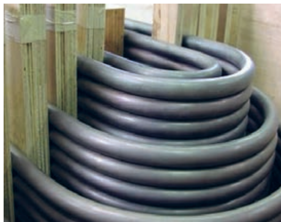
شکل ۳-۷ برگشت پذیری در خم کاری
