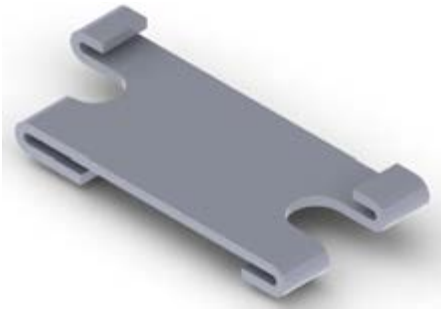
شکل ۳-۸ جهت‌های مخالف خم کاری
