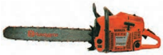
شکل ۱۴-۲- اره موتوری (بنزینی) جهت قطع درخت
