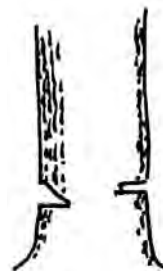
شکل ۲-۱۶- مرحله دوم، عمل برش درخت در جهتی که باید بر روی زمین بیفتد.
