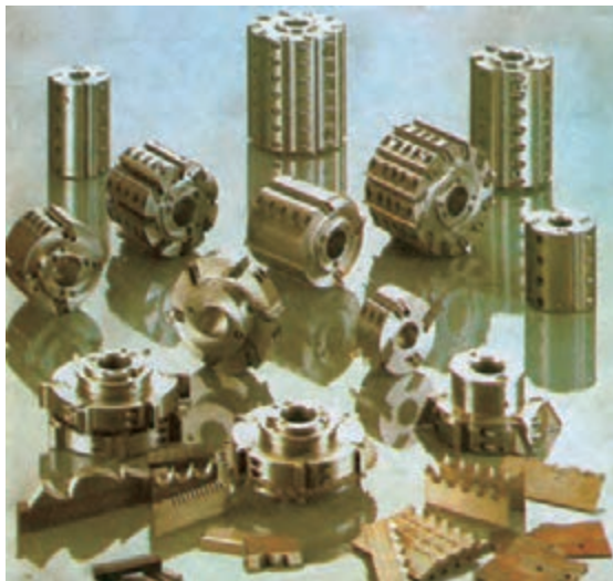
شکل ۴-۲۶- انواع توپی با تیغه‌های متفاوت
