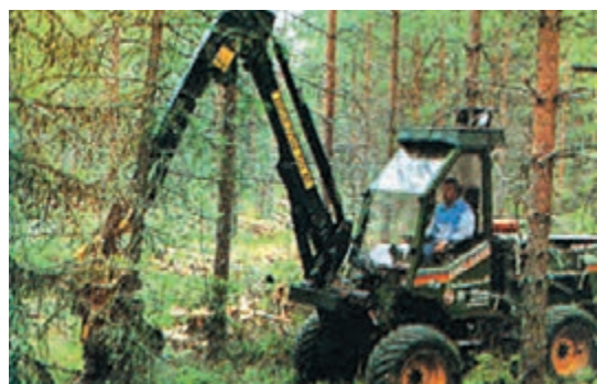
شکل ۲-۱۹- برای قطع درختان از ماشین مخصوص که برای این منظور ساخته شده است، استفاده می شود.
