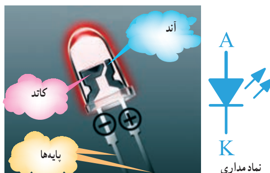
شکل ۳۰-۱۳- نماد فنی و ساختمان داخلی LED
