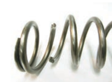
شکل ۱-۵- استهلاک و شکست قطعات
