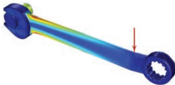
شکل ۵-۱۲- قسمت‌های بحرانی یک آچار هنگام بارگذاری
