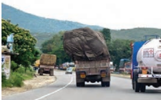
شکل ۱۱- عدم تعادل و انحراف کامیون در جاده به دلیل بار زیاد
