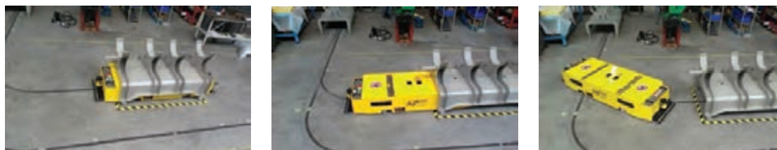
شکل ۲۹- مراحل حرکت ماشین اتوماتیک بر روی ریل
