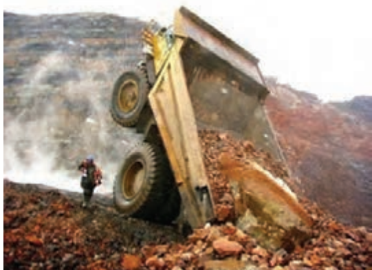
شکل ۱۰- واژگونی کامیون به دلیل بار زیاد
