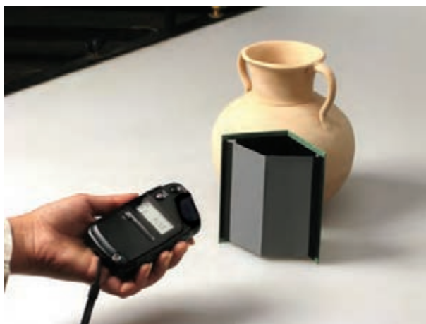
تصویر ۹-۷- نورسنجی بازتابی از کارت خاکستری
