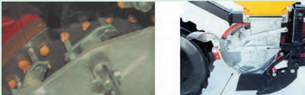
شکل ۳۶-۳. تنظیم تک‌دانه‌کن در ردیف‌کار نیوماتیکی
