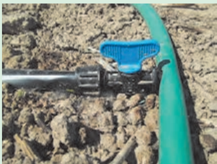
شکل ۱۹-۵. اتصال نوار به لوله و شیر
