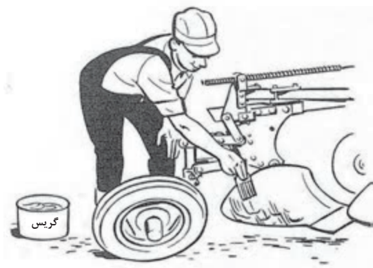
شکل ۵۲-۱. اندود کردن قطعات گاوآهن با مواد ضدزنگ
