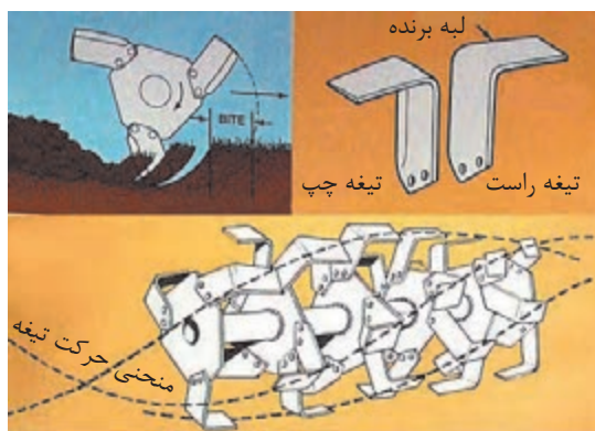
شکل ۱۵-۱. آرایش مارپیچ تیغه‌های گاواهن دوار
