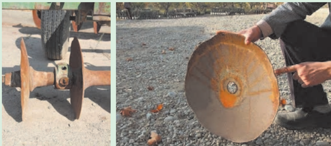
شکل ۱۵-۲. بررسی بشقاب‌ها و یاتاقان‌ها
