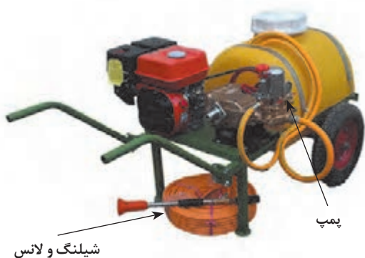
شکل ۲۹-۴. سم‌پاش فرغونی و اجزای آن
