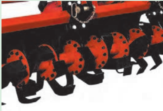
شکل ۲۲-۱. نقاط اتصال تیغه‌ها به فلانچ
