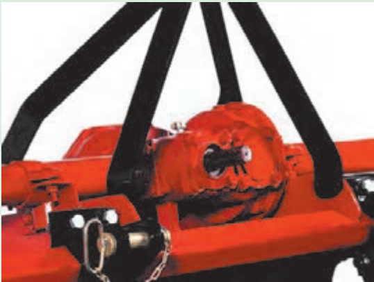
شکل ۲۳-۱. محور انتقال نیرو و نقاط اتصال
