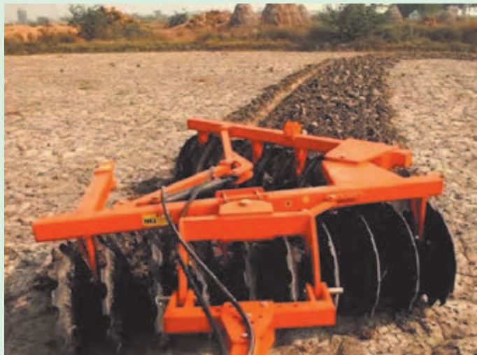
الف. تنظیم زاویه برش به وسیله جک
