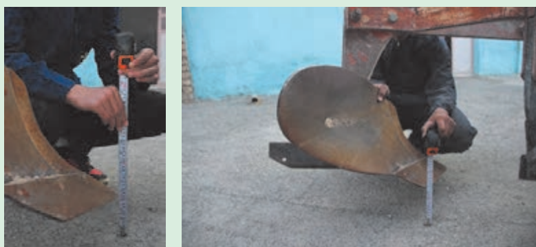
شکل ۳۰-۱. اندازه‌گیری فاصله تیغه جهت تراز عرضی
