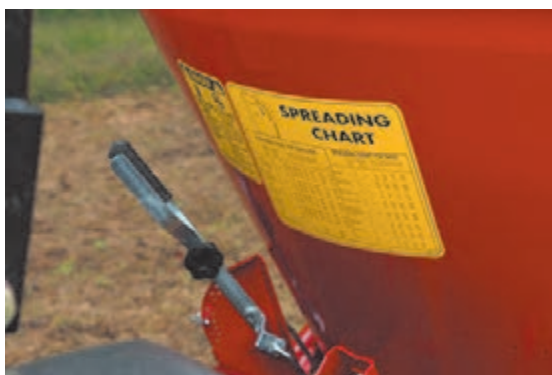
ب- اهرم تنظیم دریچه تخلیه مخزن در کودپاش دورانی
