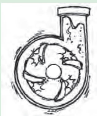
شکل ۲۹-۵. کاویتاسیون در پروانه پمپ
