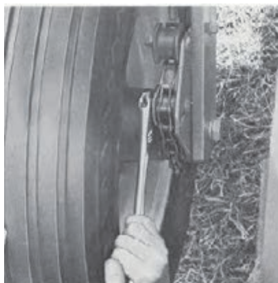
شکل ۳-۴۴. قبل از شروع کاشت کلیه پیچ و مهره‌ها را بررسی کنید.
