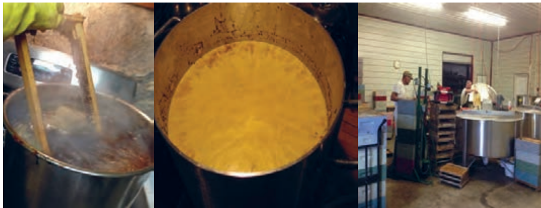
استخراج با استفاده از غوطه‌ور کردن در داخل آب جوش
