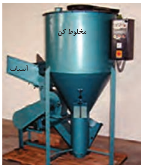
دستگاه آسیاب و مخلوط‌کن عمودی
