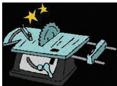
شکل ۳۱- نبود حفاظ در محل‌های متحرک دستگاه
