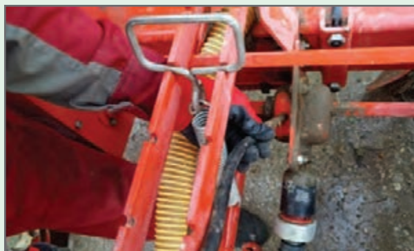
شکل ۱۲- گریس کاری تمام گریس خورهای ماشین ردیف کار
