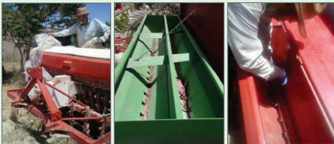
شکل ۴۰- برداشتن روکش ماشین و تمیز کردن داخل مخزن و مخزن
