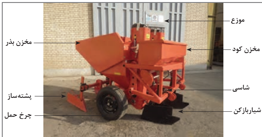
شکل ۲- غده کار خودکار دوردیفه همراه با مخزن کود
