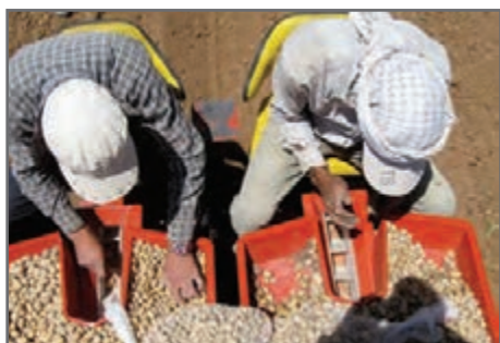
شکل ۴- غده کار نیمه خودکار با موزع افقی مخصوص سیب زمینی‌های ریز
