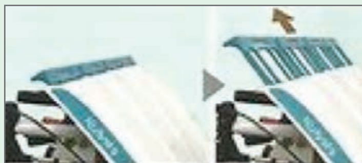
شکل ۲۹- خارج کردن سینی حامل نشاها
