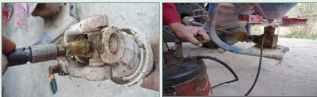
شکل ۱۶- گریس کاری گاردان و بذریاش
