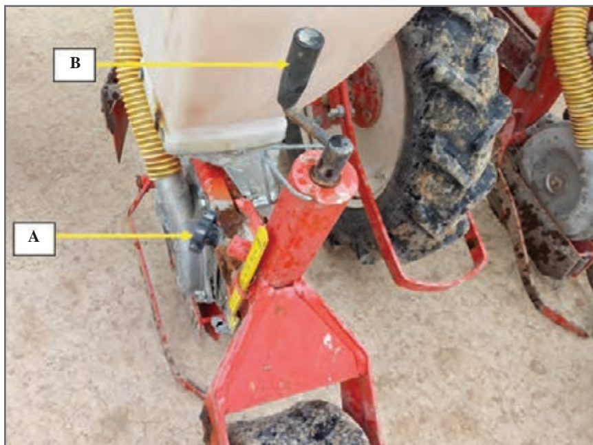
شکل ۲۱- تنظیم چرخ فشاردهنده
