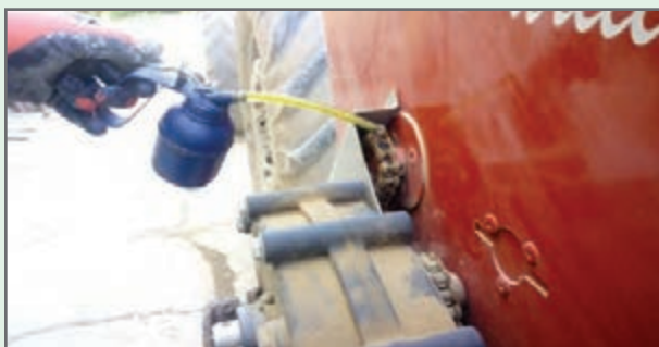
شکل ۴۳- روغن کاری چرخ دنده‌ها
