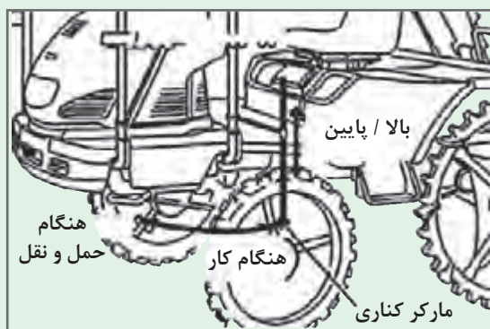
شکل ۱۷- مارکر در دو حالت حمل و نقل و کار
