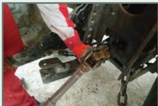
شکل ۱۰- نصب گاردان بین بذریاش و تراکتور
