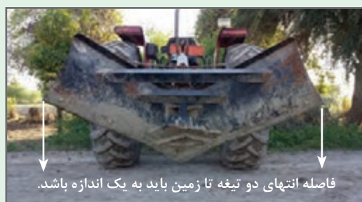
شکل ۲۵- تنظیم تراز عرضی نه‌رکن
