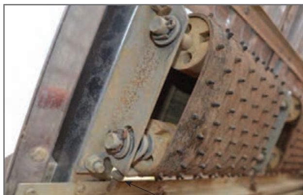
شکل ۲۳- تنظیم کشش تسمه انتقال نشاها
