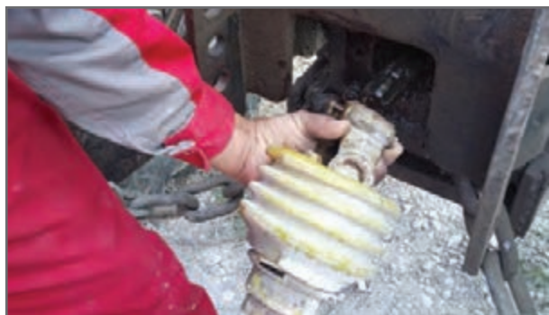
شکل ۱۲- اتصال گاردان به تراکتور
