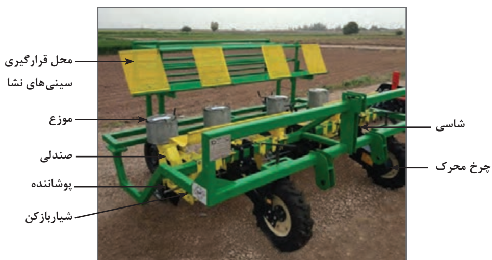
شکل ۴- اجزای ساختمانی یک نمونه نشاکار صیفی
