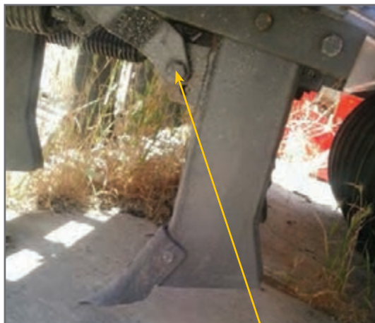
شکل ۵۴- سوراخ روی بازوی بیلچه شیار بازکن
