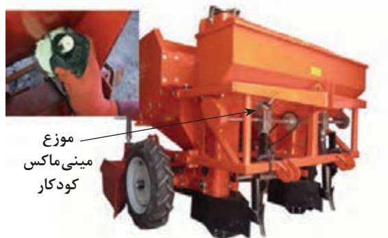
شکل ۱۵- تنظیم موزع میینی ماکس کودکار
