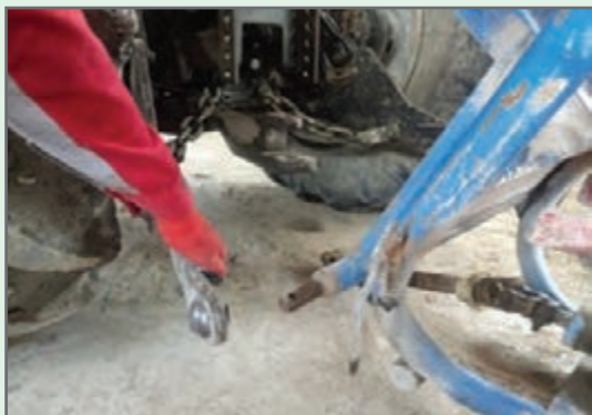
شکل ۹- اتصال بذریاش به بازوهای کناری تراکتور
