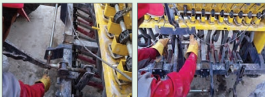
شکل ۱۳- متصل کردن خطی کار به تراکتور
