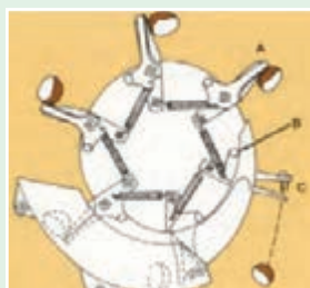
شکل ۷- تصویر شماتیک نحوه کار موزع انگشتی
