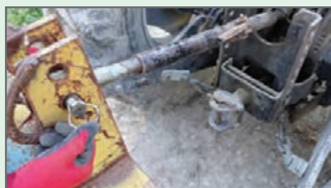
شکل ۲۳- اتصال بازوی وسط تراکتور به نه‌رکن
