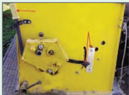
شکل ۱۷- اهرم تنظیم ریزش بذر
