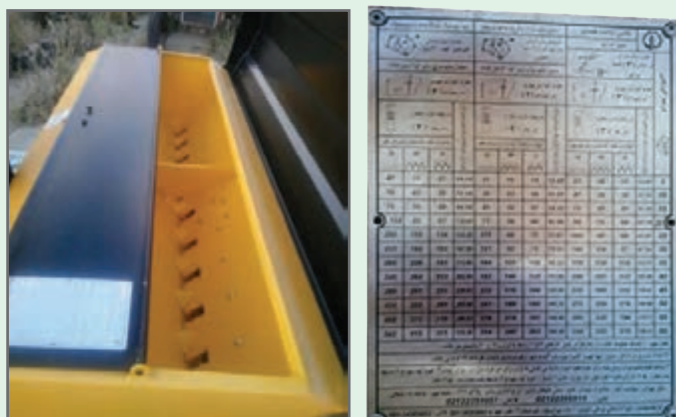
شکل ۵۶- برچسب روی ماشین کارنده در مورد تنظیمات کارنده
