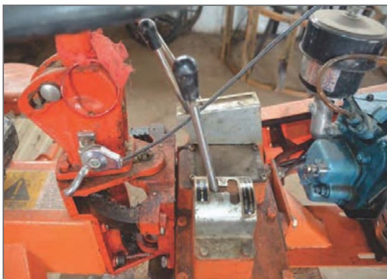
شکل ۲۰- اهرم تنظیم فاصله بین کپه نشاها روی ردیف
