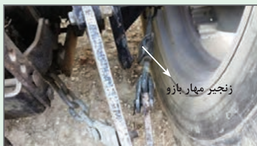
شکل ۲۴- زنجیر مهار برای تنظیم تعادلی
