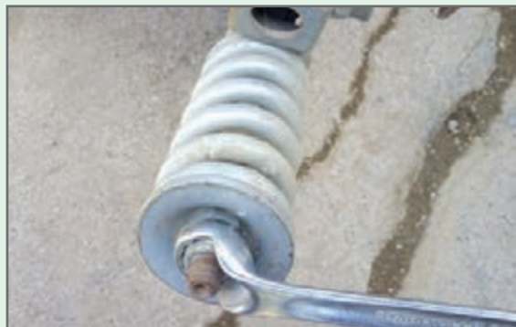
شکل ۴۵- آچارکشی نقاط اتصال اجزا و قطعات
