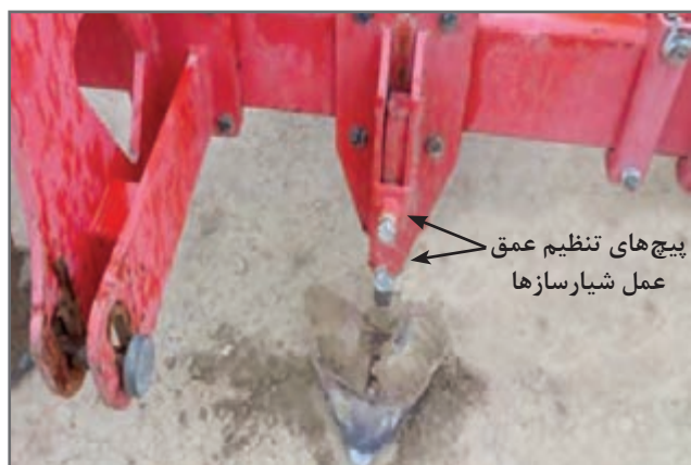
شکل ۱۷- پیچ‌های تنظیم عمق شیارساز
