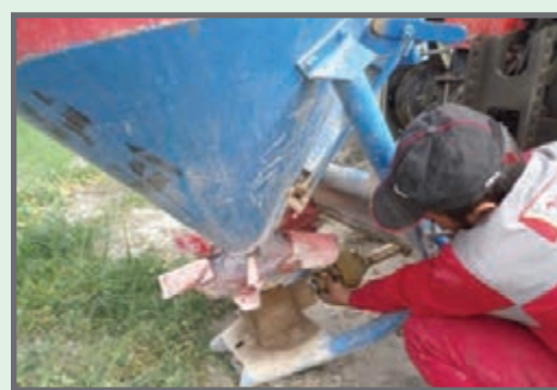
شکل ۱۰- نصب گاردان بین بذریاش و تراکتور
