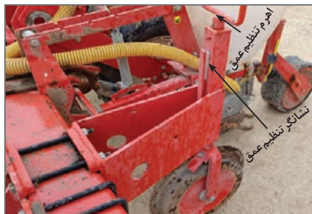
شکل ۱۸- تنظیم عمق کاشت
