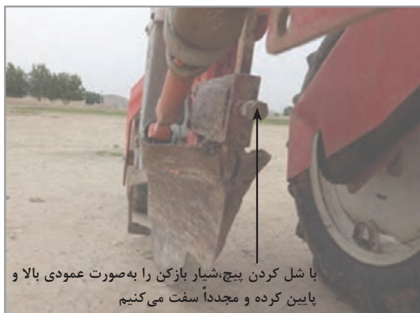
شکل ۲۰- تنظیم شیار بازکن
