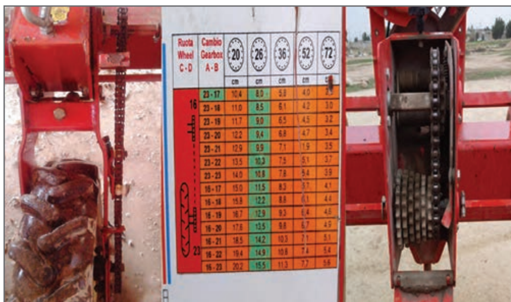
شکل ۲۵- تغییر در وضعیت چرخ دنده‌ها
