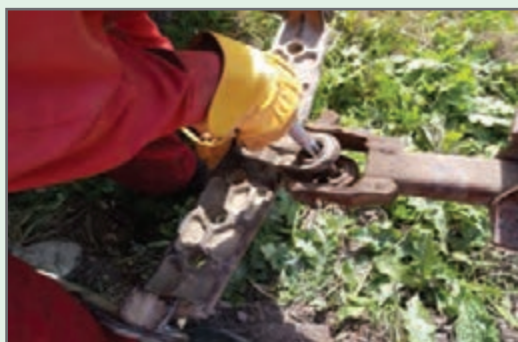
شکل ۱۱- اتصال دیسک کششی هیدرولیکی
