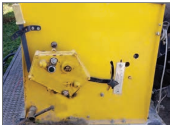
شکل ۱۵- جعبه دنده و درجه ریزش بذر
