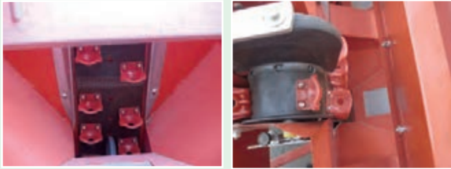
شکل ۱۶- موزع پیاله‌ای یک و دو ردیفه
