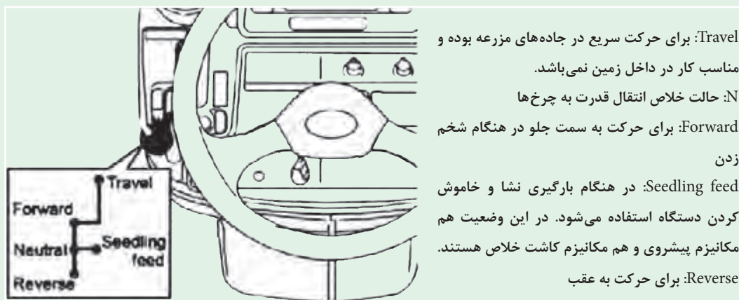
شکل ۱۹- شماتیک آرایش دنده‌های نشاکار یا نامار
