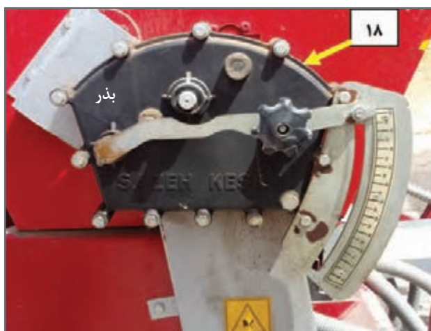
شکل ۳۸- جعبه دنده تنظیم ریزش بذر
