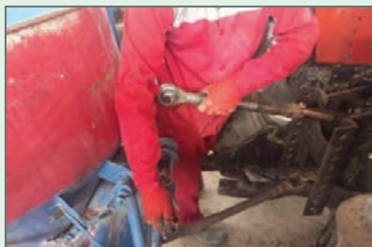
شکل ۱۱- اتصال بازوی وسط تراکتور به بذریاش
