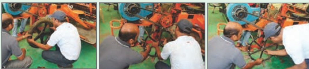
شکل ۲۸- تعویض چرخ‌های نشاکار
