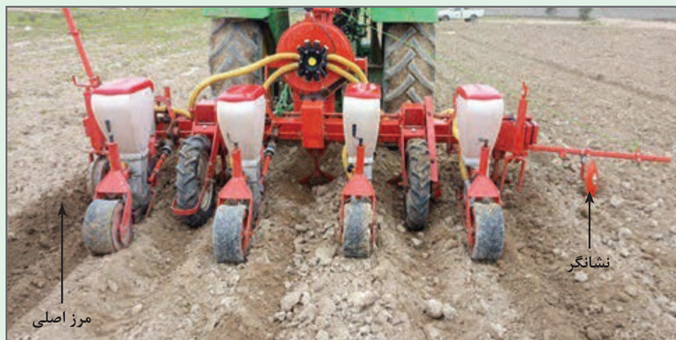
شکل ۲۷- کاشت بذر با ردیف‌کار پنوماتیکی
