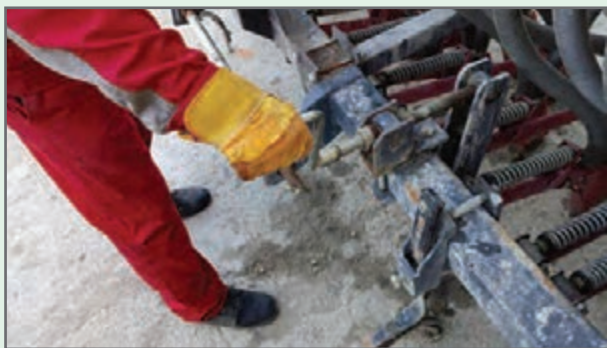
شکل ۲۱- تنظیم عمق کاشت
