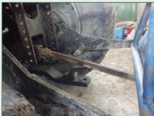
شکل ۸- کنار زدن مالبند ثابت
