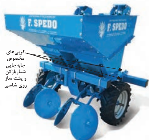
شکل ۱۰- کری های مخصوص تنظیم اندازه پشته
