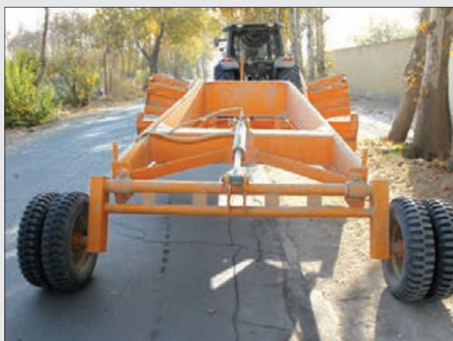
شکل ۱۸-۵- تنظیم وضعیت چرخ ها به روش مکانیکی
