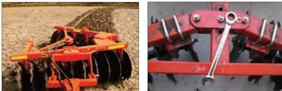
شکل ۲۸-۴ تغییر زاویه استقرار ردیف بشقاب‌ها روی شاسی
