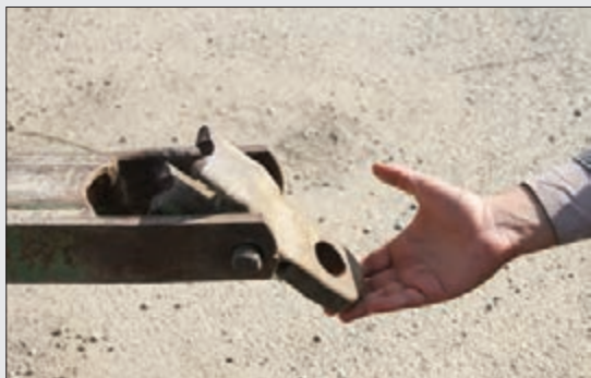
شکل ۱۲-۵- شکستگی نقطه اتصال صاف کننده
