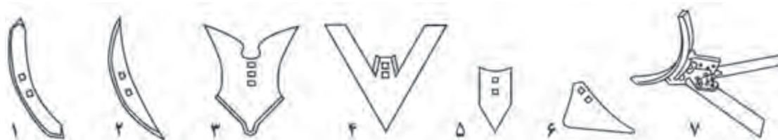
۱- قلمی ۵- بیلچه ای ۲- دندانه ای ۶- کفشکی ۳- شیار بازکن ۴- پنجه غازی ۷- قلمی پنجه غازی مرکب
