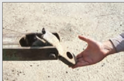
شکل ۱۸-۴- شکستگی نقطه اتصال و بشقاب
