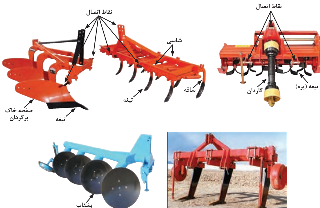
شکل ۱۹-۳ انواع گاواهن‌ها و نمایش ساختار کلی آن
