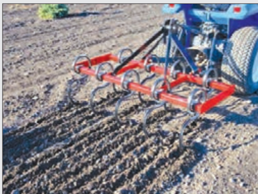
شکل ۳۳-۴ کولتیواتور با شاخه های فنری
