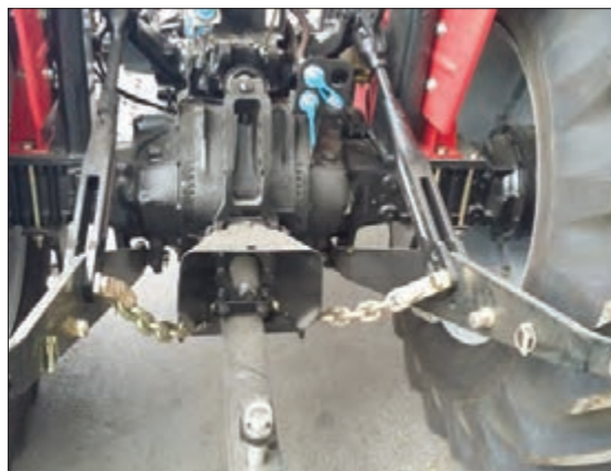
شکل ۳۲-۳- زنجیر تنظیم تعادل یا نوسان گیر
