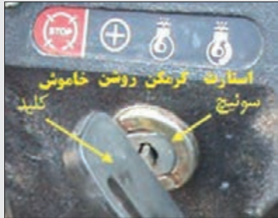
شکل ۱۴-۱ سوئیچ و وضعیت‌های آن
