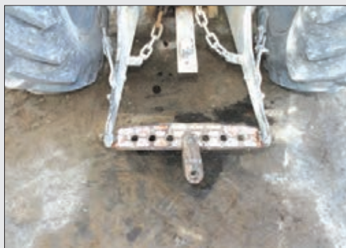
شکل ۲۹-۴- مالبند بلند و اتصال سه نقطه
