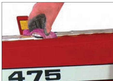
شکل ۴۵-۱ نحوه باز کردن درب رادیاتور
