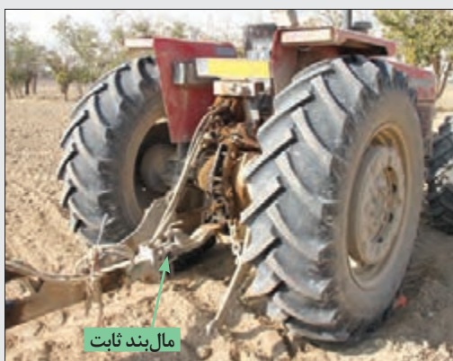
شکل ۱۶-۵- نقطه اتصال در صاف‌کننده کششی
