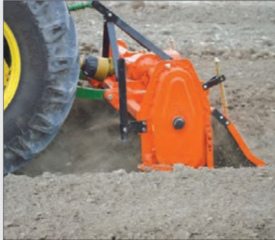
شکل ۳۴-۴- تنظیم درپوش و عمق کار
