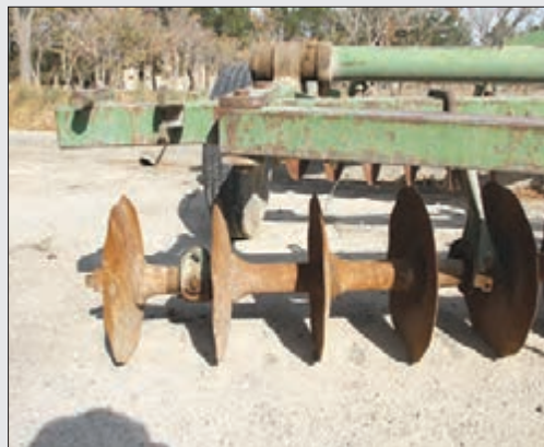
شکل ۱۹-۴ یاتاقان خراب بشقاب
