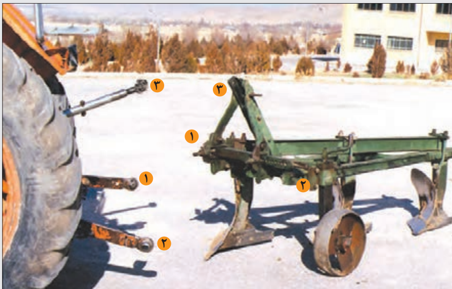
شکل ۲۸-۳- اتصال گاواهن به تراکتور
