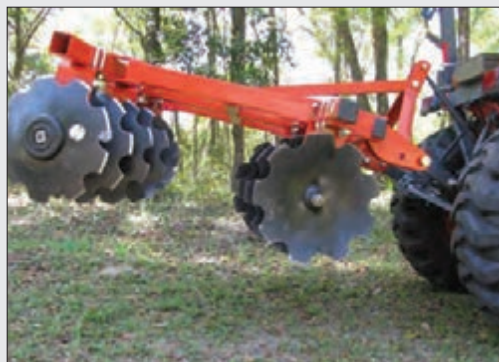
شکل ۲۹-۴- مالبند بلند و اتصال سه نقطه
