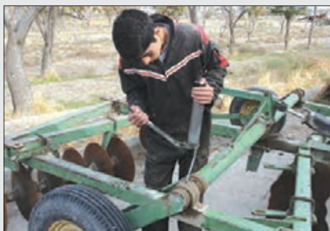
شکل ۲۱-۴- گریس کاری دیسک
