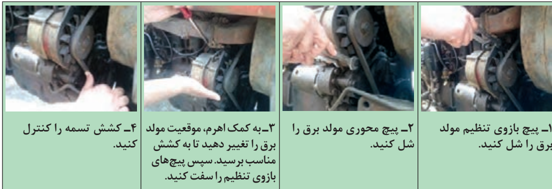
شکل ۱-۴۳- مراحل تنظیم کشش تسمه دینام
