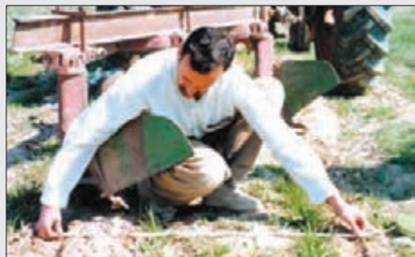
شکل ۳۷-۳- اندازه‌گیری عرض کار گاواهن برگردان دار
