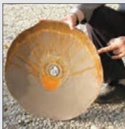
شکل ۱۸-۴- شکستگی نقطه اتصال و بشقاب
