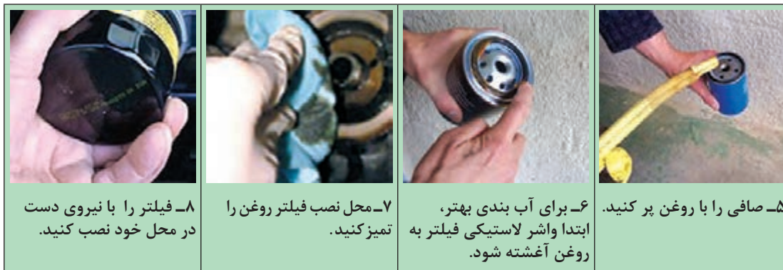
شکل ۵۰-۱- مراحل تعویض صافی روغن
