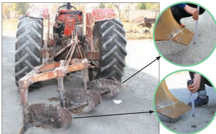
شکل ۳۰- تراز طولی گاوآهن
