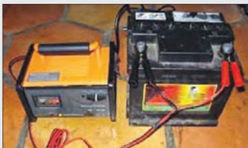
شکل ۵۲-۱- روش شارژ باتری با شارژر
