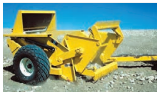
شکل ۲۰-۲- ماشین های سنگ جمع کن و اسکرپیر
