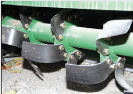
شکل ۲۲-۴ وضعیت درپوش و تیغه‌ها در گاوآهن دوار
