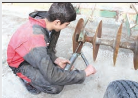
شکل ۲۱-۴- گریس کاری دیسک
