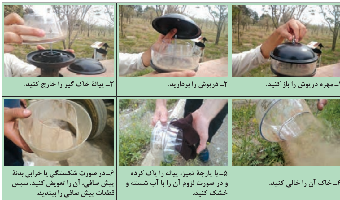
شکل ۳۱-۱- مراحل تمیز کردن پیش صافی
