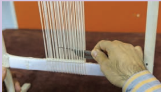
روش های اشتباه در دست گرفتن چاقوی بافت و حرکت آن
