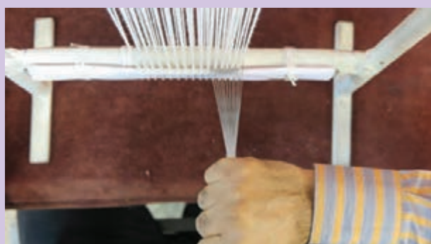
حالت و روش صحیح دفتین زدن
