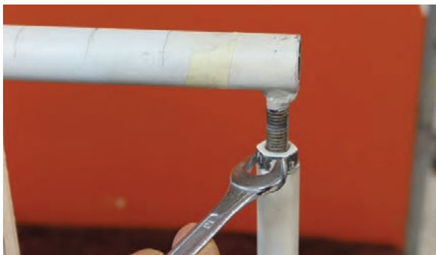
تصویر ۲-۲۹ ▲ سفت کردن مجدد پیچ‌های سر دار
