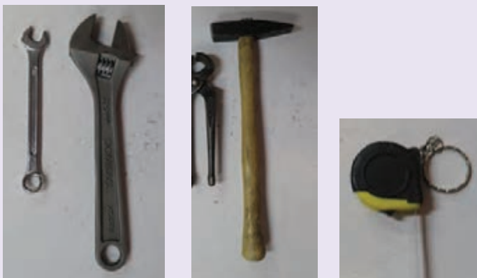
▲ تصویر ۱-۵ ابزار تنظیم دار، متر فلزی، چکش، میخ کش، آچار معمولی و تنظیم شونده
