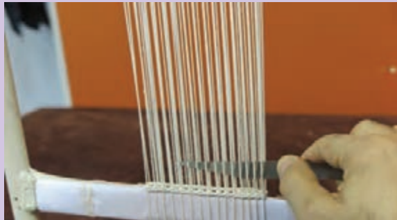
روش اشتباه در دست گرفتن سیخ بودکشی و حرکت آن
