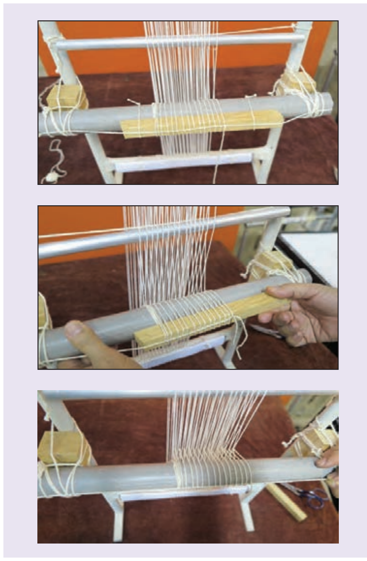
مراحل تکمیل کوچی بندی و خارج ساختن چوب صیقلی تصویر ۳۵-۱ ▲
