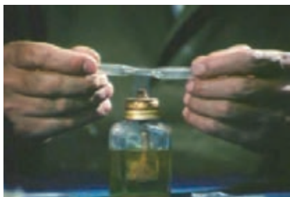
ساخت بطری‌های شیشه‌ای از لوله خودکار
