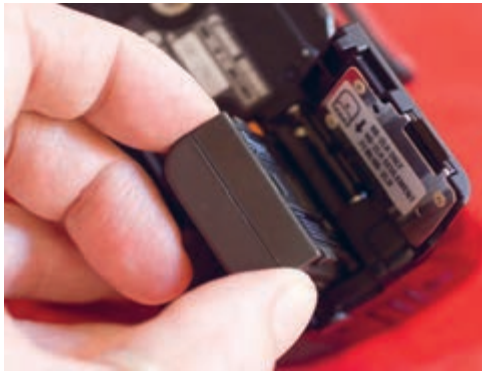
شیوه صحیح نصب باتری دوربین عکاسی
