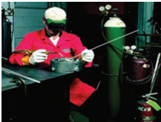
شکل ۱-۴- تجهیزات و فرایند زردجوش
