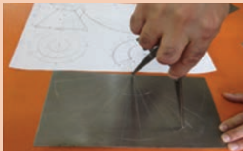
شکل ۳۷-۱- خط کش ورق فلزی با خط کش و پرگار فلزی
