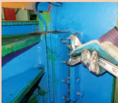
شکل ۱-۱۸- رفع عیوب برش کاری
