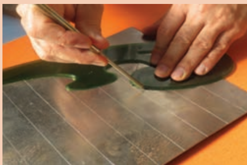
شکل ۳۴-۱- خط کشی ورق فلزی با پیستوله
