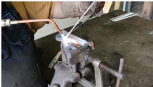
شکل ۴-۱۵- فیکسچر مورد استفاده شده در فرایند زردجوش
