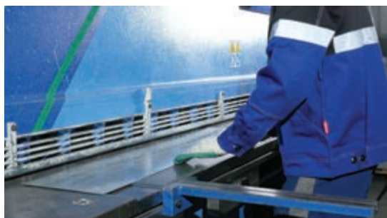
شکل ۲-۱- برش‌کاری با گیوتین
