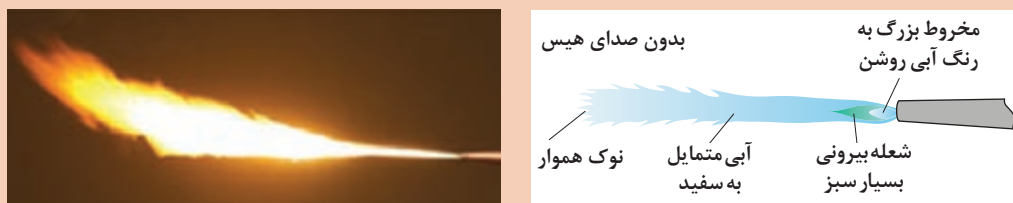
شکل ۳-۳۹- تنظیم شعله احیا (کربن ده)
