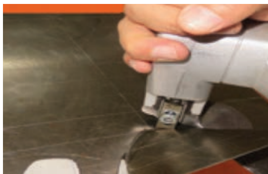
شکل ۱-۳۱- روش برش کاری با نیبلر دستی
