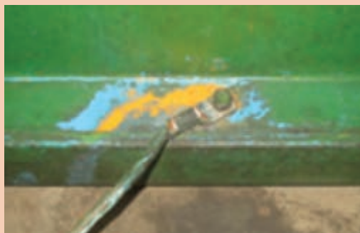
شکل ۱-۲۳- نمونه‌ای از سیم ارت در گیوتین
