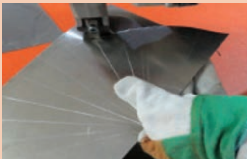
ب) برش کاری منحنی با نیبلر
