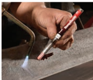
شکل ۴-۱۸- اندازه‌گیری دما توسط گچ‌های حرارتی
