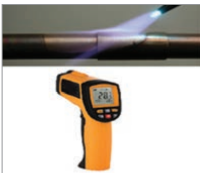
شکل ۴-۱۹- اندازه‌گیری دما توسط ترمومتر
