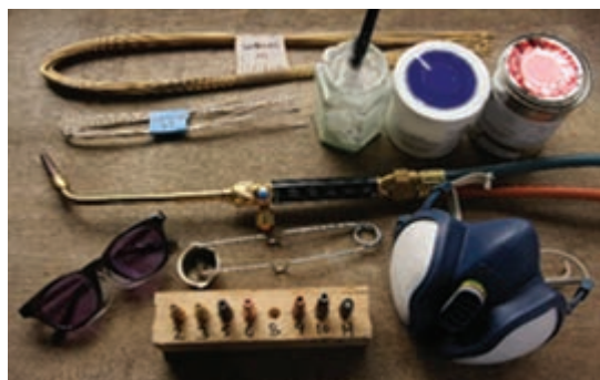
شکل ۷-۴- تجهیزات مورد استفاده فرایند زردجوش
