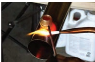
شکل ۴-۱۷- استفاده از شعله اکسی‌استیلن
