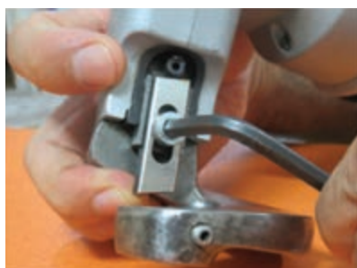
شکل ۱-۲۸- تنظیم فاصله افقی و عمودی تیغه‌ها
