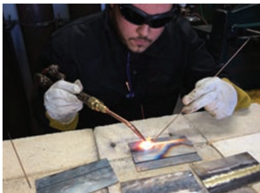
شکل ۶-۴ ذوب کردن فلز پایه و فلز پرکننده
