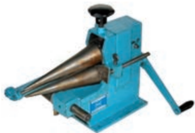
شکل ۲-۲۲ نورد خاص در تولید مخروط ناقص
