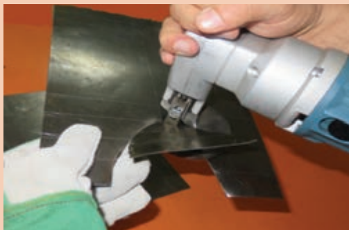
شکل ۳۵-۱- برش کاری با قیچی نیبلر
