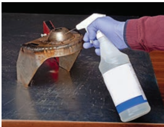
شکل ۴-۲۲- تمیزکاری بعد از جوشکاری توسط محلول شیمیایی
