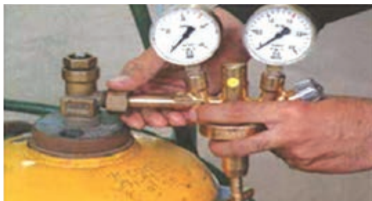
شکل ۳-۱۸- بستن رگولاتور به کپسول
