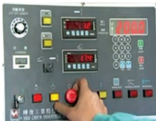
شکل ۹-۱- نمایی از صفحه تنظیمات در گیوتین CNC
