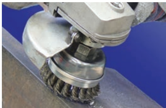
شکل ۱۱-۴- تمیزکاری توسط ابزارهای مکانیکی
