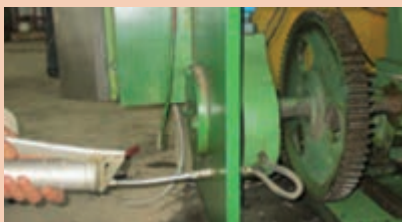
شکل ۱-۱۶- سرویس دوره‌ای گیوتین
