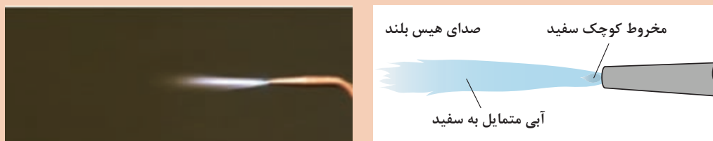
شکل ۳-۴۰- تنظیم شعله اکسید
