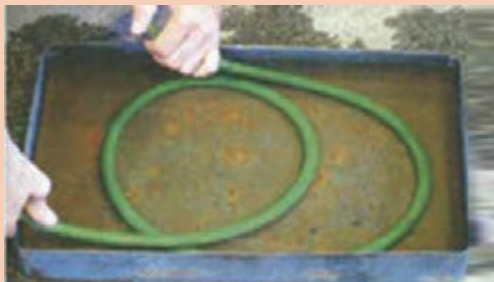
شکل ۳-۳۸- کنترل سلامت شیلنگ‌ها
