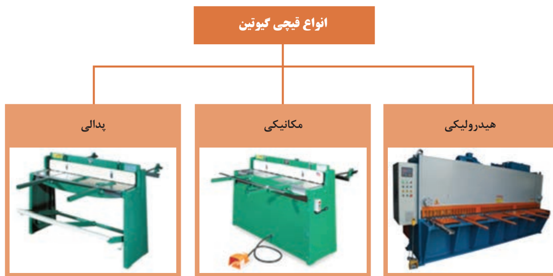
شکل ۳-۱- انواع گیوتین از نظر نحوه انتقال قدرت
