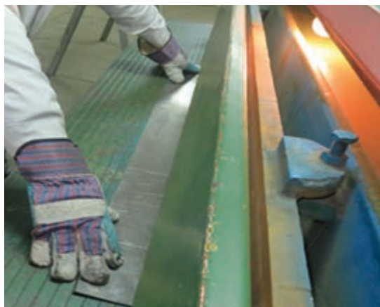
شکل ۷-۱- تنظیم خط برش با چشم توسط اپراتور
