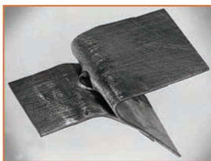
شکل ۱۹- نتیجه مطلوب در آزمون خم‌کاری
