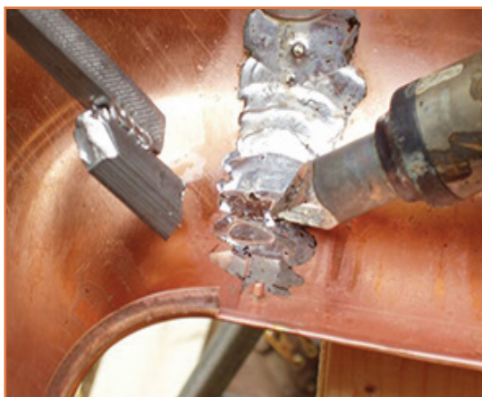
ب - لحیم کاری دو قطعه مسی
