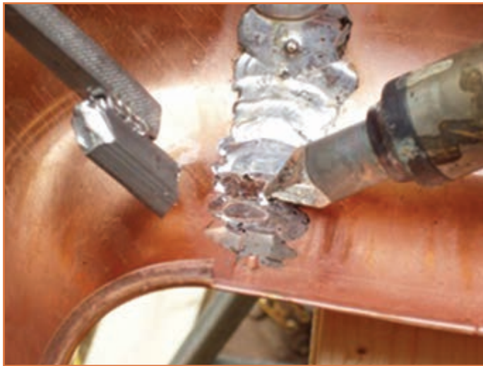
شکل ۲۲ - پرکردن درز اتصال به وسیله مذاب لحیم
