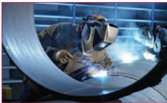
شکل ۵-۱- جوش کاری مخزن فولادی
