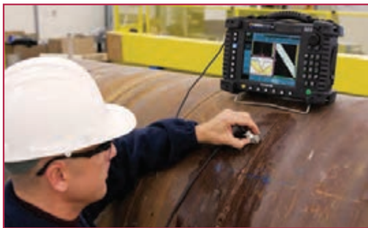
شکل ۶-۱- بازرسی جوش (تست التراسونیک)
