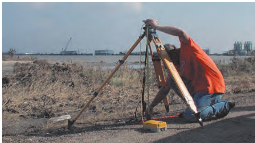
اندازه گیری ارتفاع دوربین تا سطح زمین
