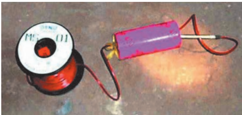
طریقه قرار دادن چاشنی درون دینامیت
