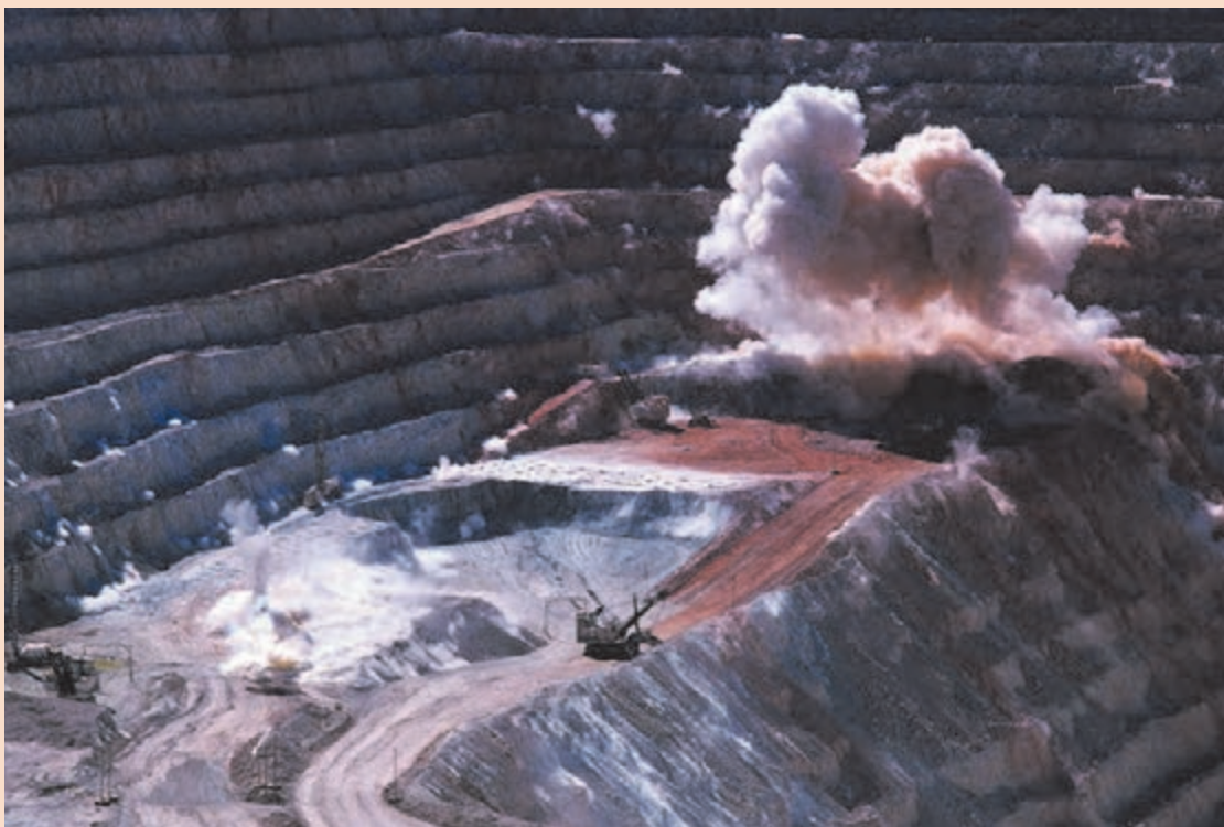
عملیات چال‌زنی و آتشیاری در معدن
