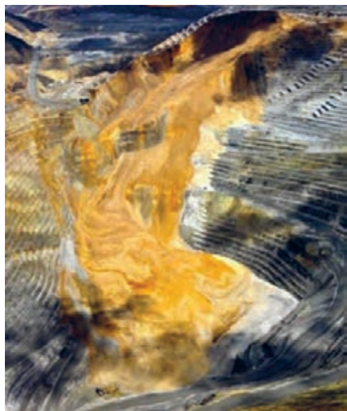
شکل ۳-۱۵- ریزش در یک معدن روباز
