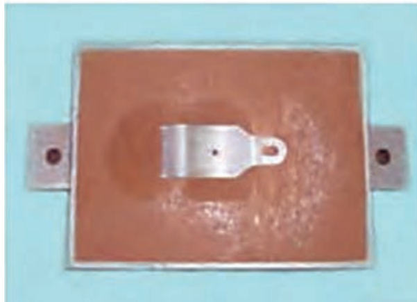
شکل ۲۱. سطح قالب‌های زیرین را پودر جدایش بزنید.
